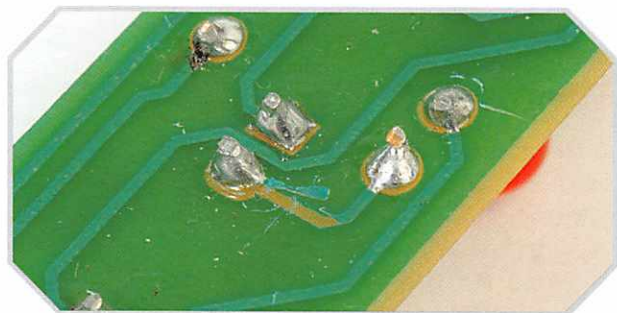
Circuito stampato danneggiato.
