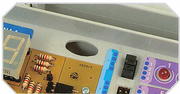
Tramite questo foro bisogna far passare il connettore bianco del cavetto.
