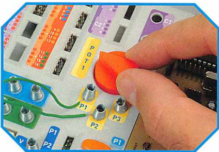
Regoleremo il potenziometro fino a quando si spegnerà il LED.
