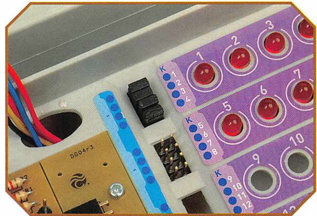
Se utilizziamo la matrice dei LED dobbiamo inserire i ponticelli sui catodi.
