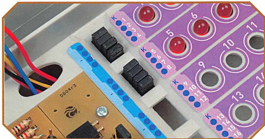
Inseriamo i ponticelli sui catodi dei LED.
