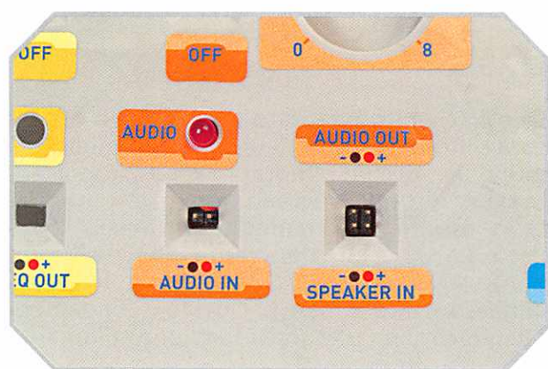
Aspetto dei LED e dei connettori di DG15.
