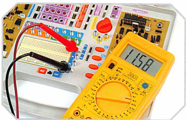
Misura della tensione di uscita.
