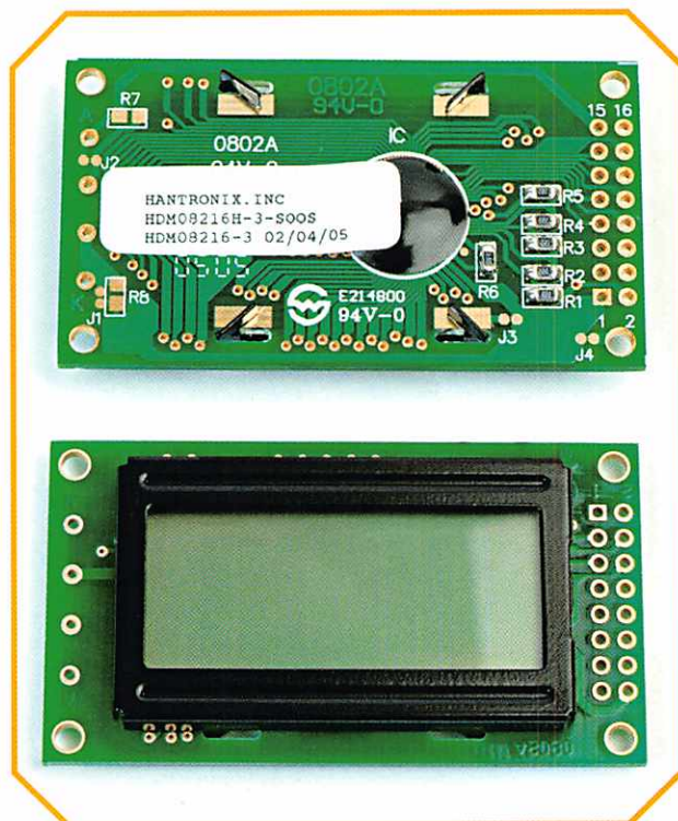
Aspetto di un display LCD da entrambi i lati.
