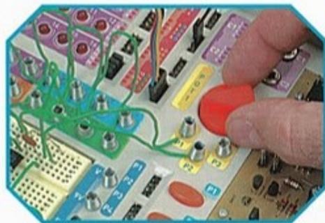
Ruotando POT 1 cambia la modulazione.
