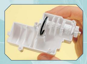
Recupera l'albero con ruote dentate (a destra) e la prima metà della scatola contenente l'albero con le ruote dentate, la puleggia e la cinghia di trasmissione (qui a sinistra).
