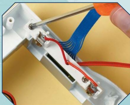
**3** Fissa il supporto alla scatola del marsupio usando due delle quattro viti da 2,6x8 mm.
