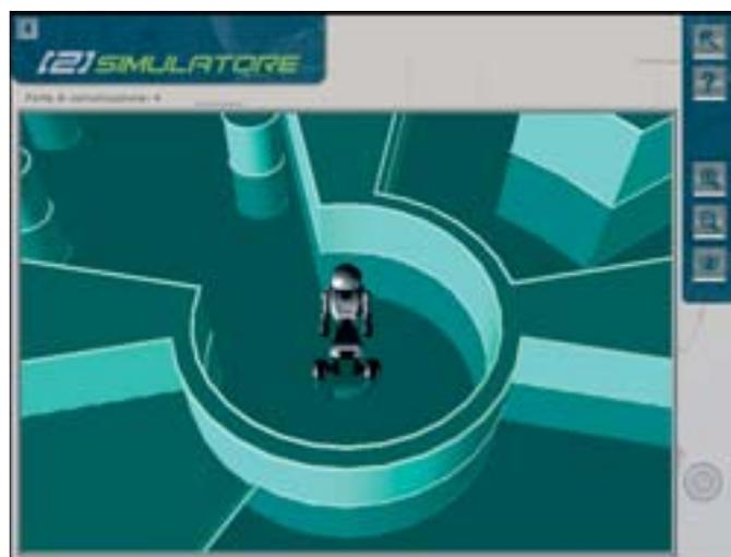
Sopra, la schermata iniziale del simulatore avviato in modalità 'via Bluetooth': in alto a sinistra è visibile l'indicazione della porta di comunicazione usata. Sotto a sinistra, i dispositivi visibili da un computer dotato di modulo Bluetooth; essi sono visualizzabili effettuando la funzione 'ricerca dispositivi'.
