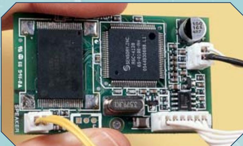
**3** Effettua anche quest'ultimo collegamento, che permetterà la comunicazione tra Motherboard e Voice, nonché l'alimentazione di quest'ultima: il cavo a sei fili bianchi, infatti, si occuperà anche di fornire la corrente elettrica necessaria al funzionamento della scheda Voice.
