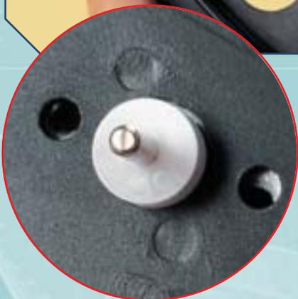
**6** Inserisci le due viti da 2,6x4 mm nei due fori e poi serrale bene in fondo, in modo che il motore rimanga fissato alla parte destra del bacino (a destra).
