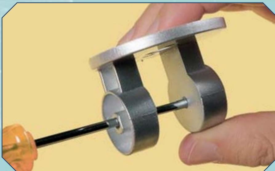
**4** Guarda bene i fori: controlla in particolare che essi non presentino sbavature o residui. Questi ultimi, infatti, potrebbero impedirti di inserire l'asse metallico. Se necessario, utilizza con delicatezza un cacciavite per ripulire i fori, agendo con molta attenzione (a sinistra).
