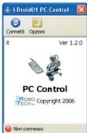
Selezionando Opzioni, viene visualizzata un'ulteriore finestra, in cui bisogna scegliere 'Connetti a una porta seriale', per poi indicare come 'nome dispositivo' la porta COM segnalata al termine della fase iniziale. A questo punto, mediante Salva (mantenendo le modifiche valide in modo permanente) o Applica (per mantenere le modifiche solo fino a nuovo riavvio del software), è possibile cliccare su Connetti e avviare la schermata di controllo, le cui funzioni verranno descritte prossimamente.
