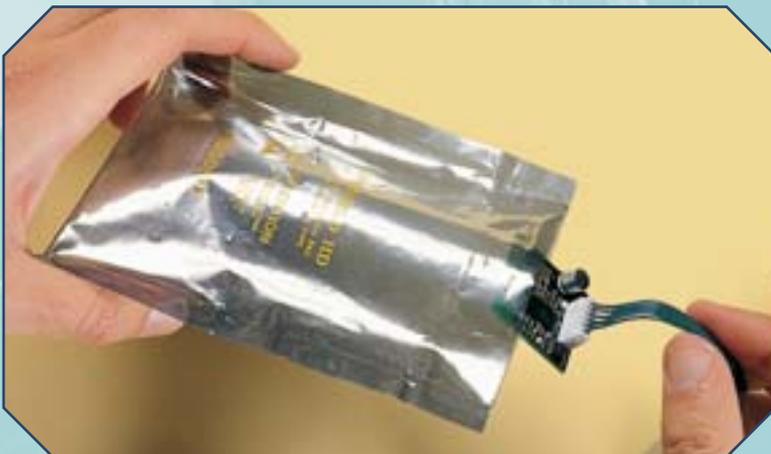
**1** Poni nuovamente l'interruttore in posizione OFF; solo dopo, se serve aiutandoti con un paio di pinzette, poni la scheda del modulo Bluetooth in una busta antistatica (sopra).
