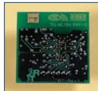
*La scheda per il modulo Bluetooth (sopra, il retro) è l'ultimo componente a essere allegato per questa fase di montaggio. A questo punto, comunque, hai già composto altri elementi, che presto installerai nel corpo del robot, in particolare la scatola bianca del motore del bacino (qui a sinistra, in alto) e quella del motore della ruota destra (a sinistra), oltre alla ruota posteriore.*
