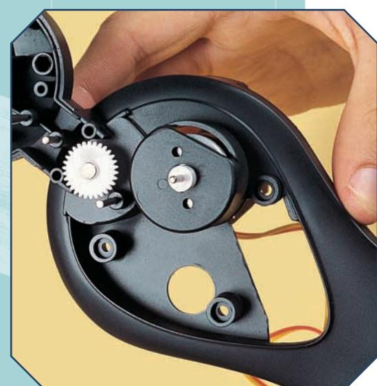
**3** Allinea i due fori presenti sulla cassa del motore con quelli della parte sinistra del bacino. Usa le due viti da 2,6x4 mm trovate con il fascicolo 47 per fissare il motore (a sinistra).
