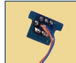
Tra gli elementi che verranno posizionati nel corso dei prossimi passi di montaggio ci sono anche il motore elettrico allegato al fascicolo 47 (sopra a destra) e il circuito per l'encoder del fascicolo 45 (qui a destra).
