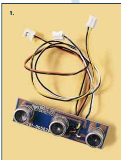
1. Scheda con due emettitori e un ricevitore a ultrasuoni
