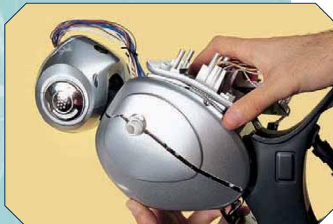
**2** Fai bene spazio all'interno del robot (a sinistra), controllando che tutti i fili rimangano collegati e non tirati, poi apprestati a inserire i cavi.
