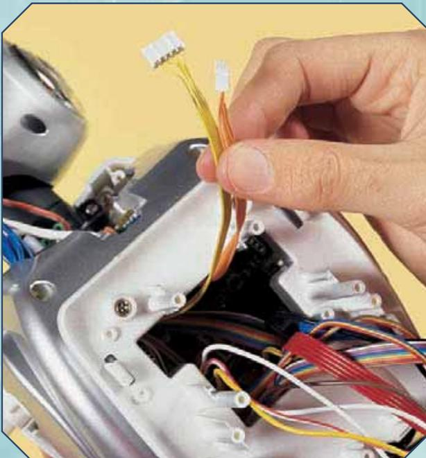
**6** Verifica tutto, in particolare che non ci siano fili scollegati o danneggiati e che i cavi delle spalle siano inseriti correttamente, con l'estremità a connettore singolo rivolta verso l'interno del robot.
