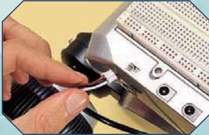
**1** Per posizionare i cavi di collegamento con il modulo Arms, è necessario innanzitutto rimuovere la stessa scheda Arms dalla sua posizione nel retro del robot. Come prima cosa verifica che il robot non sia alimentato, staccando il cavo di alimentazione del marsupio (immagine a sinistra). Poi, rimuovi le due viti che mantengono in posizione il sensore di temperatura (immagine sotto). Metti da parte le viti con attenzione ed etichettale: in seguito dovrai riposizionarle.
