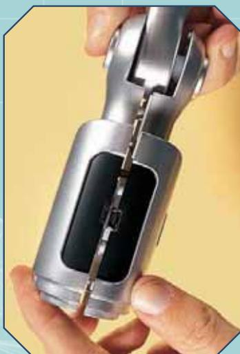
**4** Serra le due viti da 3x10 mm allegate a questo fascicolo nei fori della parte interna dell'avambraccio, poi posiziona il tappo e i coperchi della spalla e del gomito (sopra).
