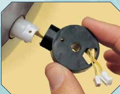
**1** Prendi la parte posteriore del supporto della spalla sinistra, allegato al fascicolo 69. Fai passare il cavo giallo che fuoriesce dalla spalla sinistra nel foro più grande del supporto, come mostrato a sinistra. Poi posiziona la parte del supporto sulla sua sede sull'albero di movimento (immagine a destra).
