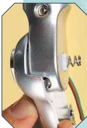
**3** Componi la parte interna dell'avambraccio con il braccio all'altezza del gomito, in seguito posiziona la molla a spire rade nella cavità delle ghiera (a sinistra). Poi posiziona le due rondelle, componi le due parti dell'avambraccio (a destra) e fissale al gomito usando l'albero e il dado.
