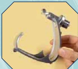
**2** Come per la torcia, poni l'estremità a croce del connettore del vassoio nell'apposita fessura dell'avambraccio di I-D01 rimasto libero (a destra).
