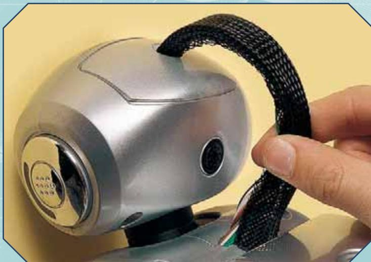
**5** Completa il fissaggio della fascia protettiva richiudendola nella parte inferiore tramite la fascetta 'a strappo', anch'essa allegata a questo fascicolo. Stringi bene quest'ultima, in modo che mantenga la fascia protettiva avvolta ai cavi (immagine a destra).
