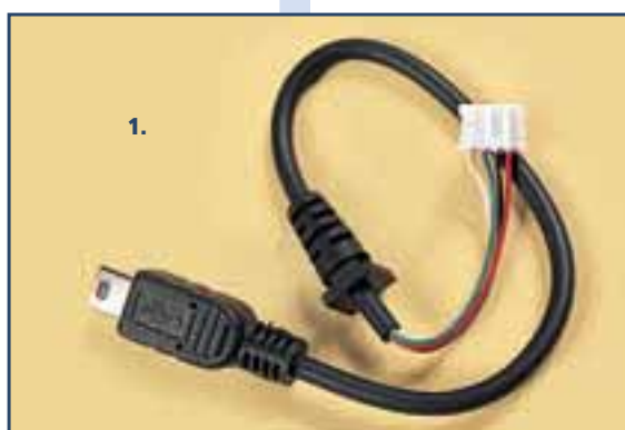
1. Cavo tipo mini USB per il telecomando universale
