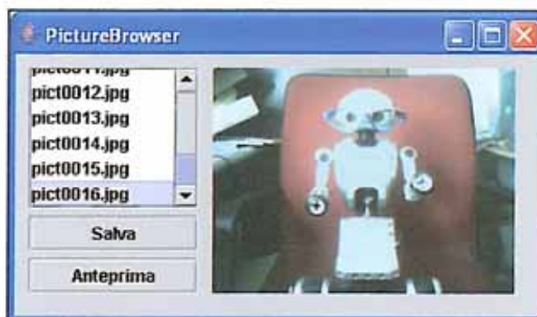
Sopra, l'interfaccia grafica del programma mentre viene visualizzata l'anteprima di una fotografia. Più in alto, invece, la stessa interfaccia subito dopo l'avvio dell'applicazione.
