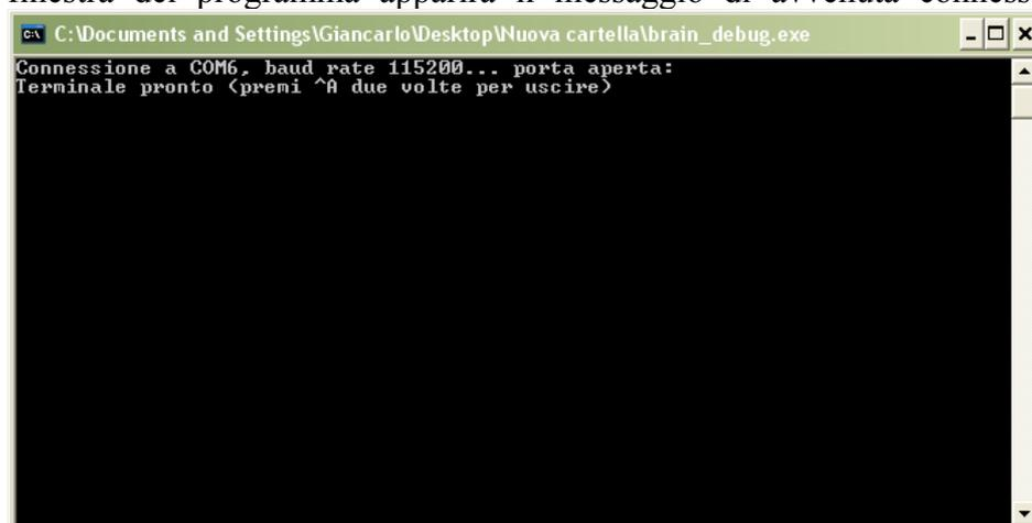
Se il programma non è in grado di aprire la porta seriale apparirà il messaggio *non posso aprire la porta*: accertarsi di non avere altre applicazione che usano la porta seriale sulla quale è connesso il robot o che la porta seriale salvata nel file *brain\_config.ini* sia quella giusta.
