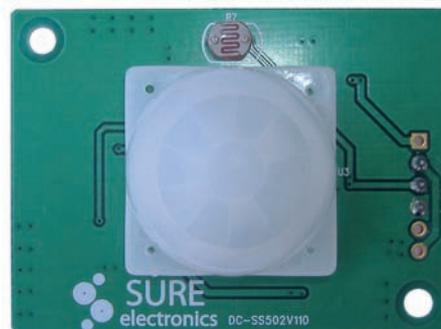
Figura 15: foto del sensore PIR utilizzato.
