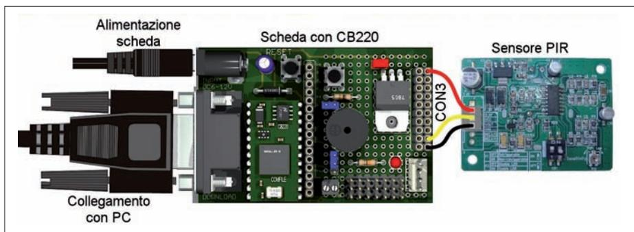
Figura 21: collegamento sensore PIR alla scheda CONN3.
