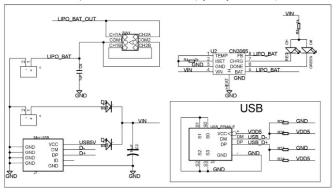
L'integrato **CN3065** contiene al suo interno un **MOSFET** di potenza on-chip ed elimina così la necessità di inserire all'esterno il current sense resistor e il diodo di blocco.
