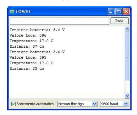
Valori della telemetria visualizzati tramite il monitor seriale
