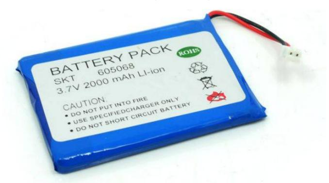
La batteria ha le dimensioni di 68x48x5.7mm, un peso di circa 43g e dispone di una protezione integrata contro le sovratensioni, sovracorrente e minima tensione. Il cuore del circuito di protezione è rappresentato dall'integrato tipo **S-8261** (<u>Datasheet</u> [7]) prodotto dalla **Seiko Instruments Inc** [8].
