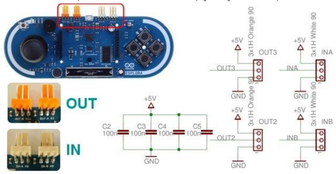
Per la creazione della porta virtuale si sono utilizzati il pin 11 come RX e il pin 3 come TX.
