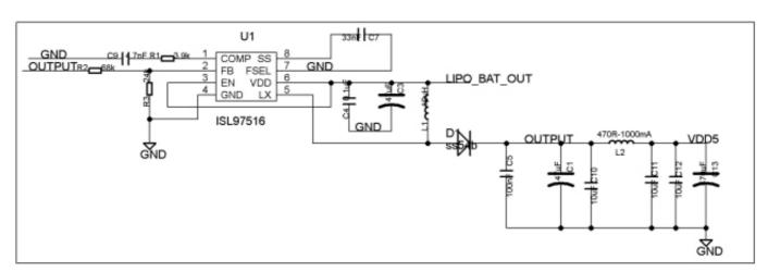
Il pin di compensazione esterna **COMP** permette una maggiore flessibilità nella determinazione della compensazione in frequenza, permettendo l'uso di condensatori di uscita ceramici a basso ESR.
