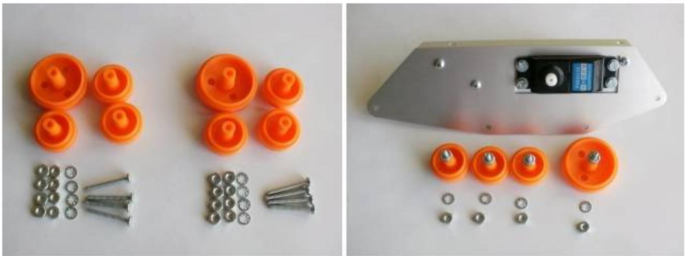
Si passerà poi al fissaggio delle ruote folli necessarie per la guida del cingolo per ogni lato del robot.
