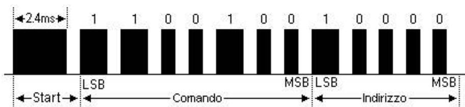
Nell'immagine sopra è riportato un tipico treno di impulsi del protocollo SIRC (SONY), con questo protocollo il **LSB** (Least Significant Bit - bit meno significativo) viene trasmesso per primo.
