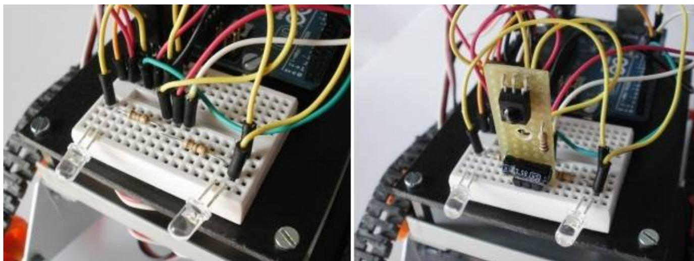
Nella foto è riportato lo schema di collegamento del modulo sensore [22], che prevede il contatto di alimentazione centrale, quello di GND sulla sinistra e l'uscita del segnale sulla destra
