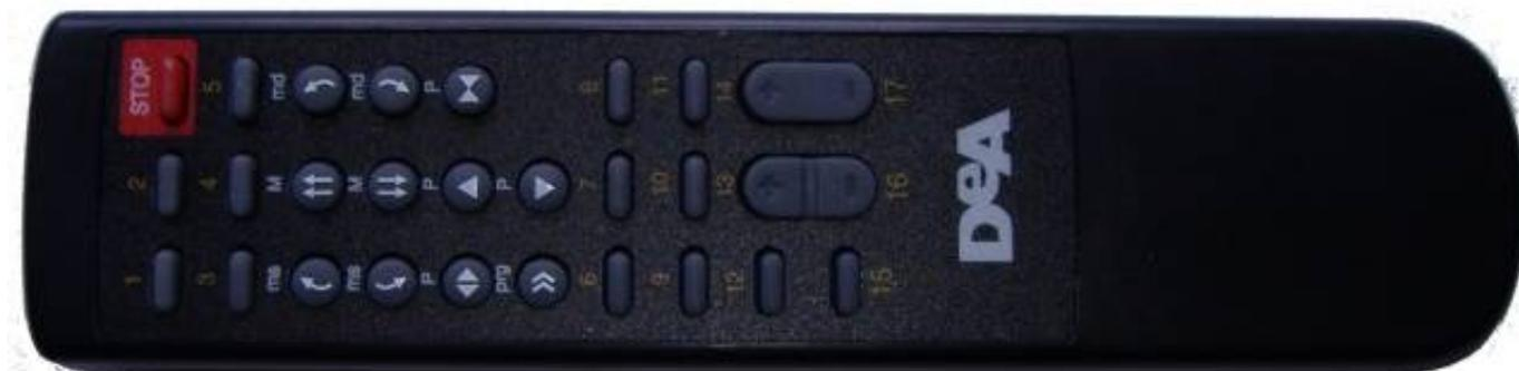
Cuore del circuito di comando è l'integrato **SC73C0302-008** di produzione cinese che codifica i segnali della tastiera con il protocollo Sony-compatibile e li invia tramite un led trasmittente ad infrarosso. L'alimentazione è fornita tramite 2 batterie 1,5V stilo. Il telecomando presenta 27 tasti a cui sono associate varie serigrafie.
