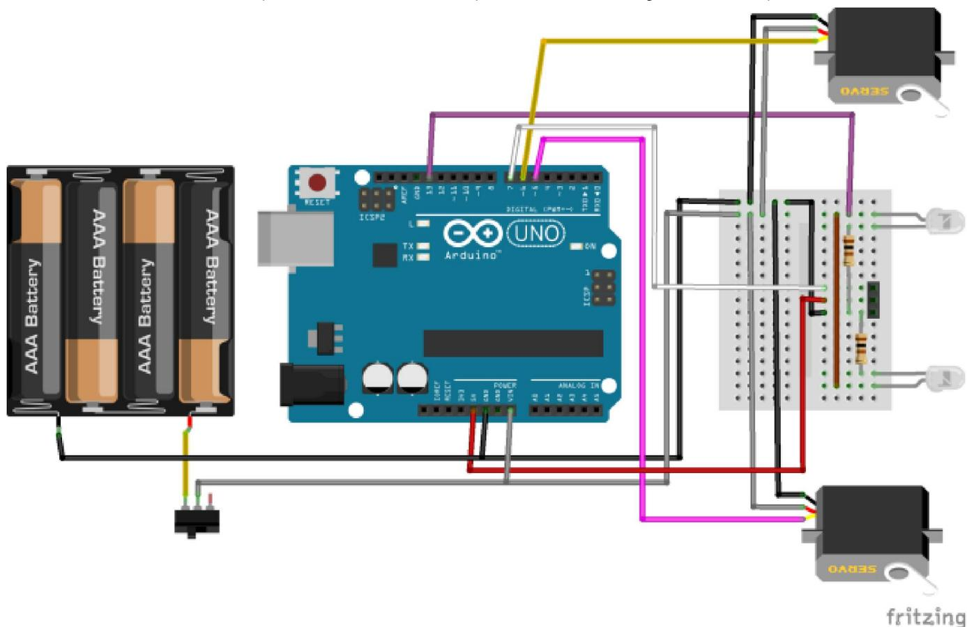
Nel caso si preferisse l'uso del solo sensore **TSOP1836**, occorrerà modificare leggermente il cablaggio in quanto, rispetto al modulo, il pin di alimentazione è a sinistra, il pin di massa è al centro e l'uscita del segnale è a sinistra.
