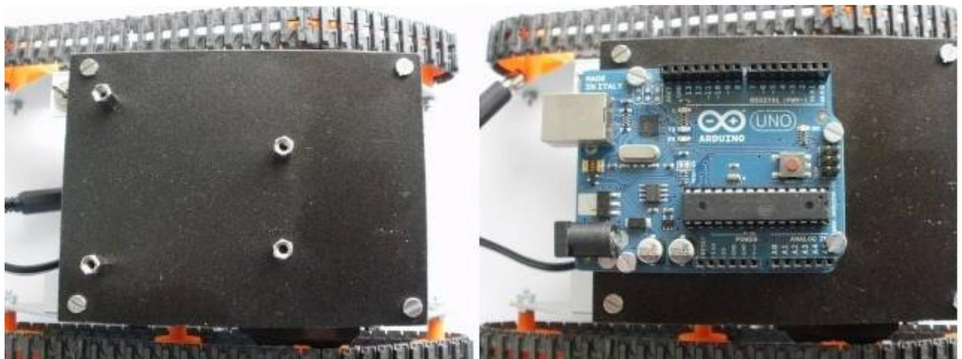
È possibile montare adesso la piastra supporto scheda **[4]** con n° 4 viti M3x8 **[16]** su cui si fisseranno 4 distanziali esagonali L=10 mm **[14]** fissati con 4 dadi M3 **[15]**. La scheda Arduino UNO **[12]** sarà fissata con n° 4 viti M3x8 **[16]**.
