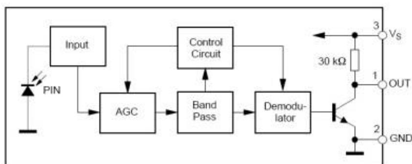
Il segnale IR ricevuto è prelevato dal diodo di rilevazione a infrarossi PIN, questo segnale è amplificato e limitato nel primo blocco di Input.
