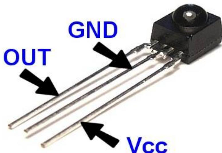
Come in precedenza descritto, all'interno del dispositivo, è presente il diodo PIN e il preamplificatore; sono montati su uno stampato inserito all'interno di un contenitore di resina epossidica che ha anche la funzione di filtro IR.
