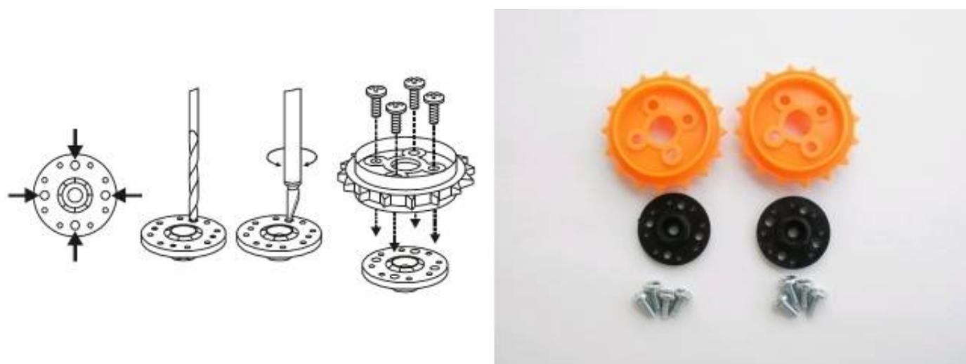
Per il fissaggio delle ruote motrici **[9]** al servomotore, occorre allargare quattro fori presenti sulle squadrette che saranno state fornite con i servomotori **[5]**, i fori dovranno essere più piccoli della vite in modo che, quando saranno inserite le viti queste possano fare presa. È possibile eseguire questi fori con una punta di trapano, oppure utilizzando la lama di un cutter per ingrandire i fori come mostrato nella figura.
