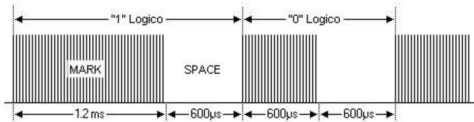
Sul lato ricevente un "SPACE" è rappresentato da un elevato livello di uscita del ricevitore. Un "MARK" è rappresentato automaticamente da un livello basso.
