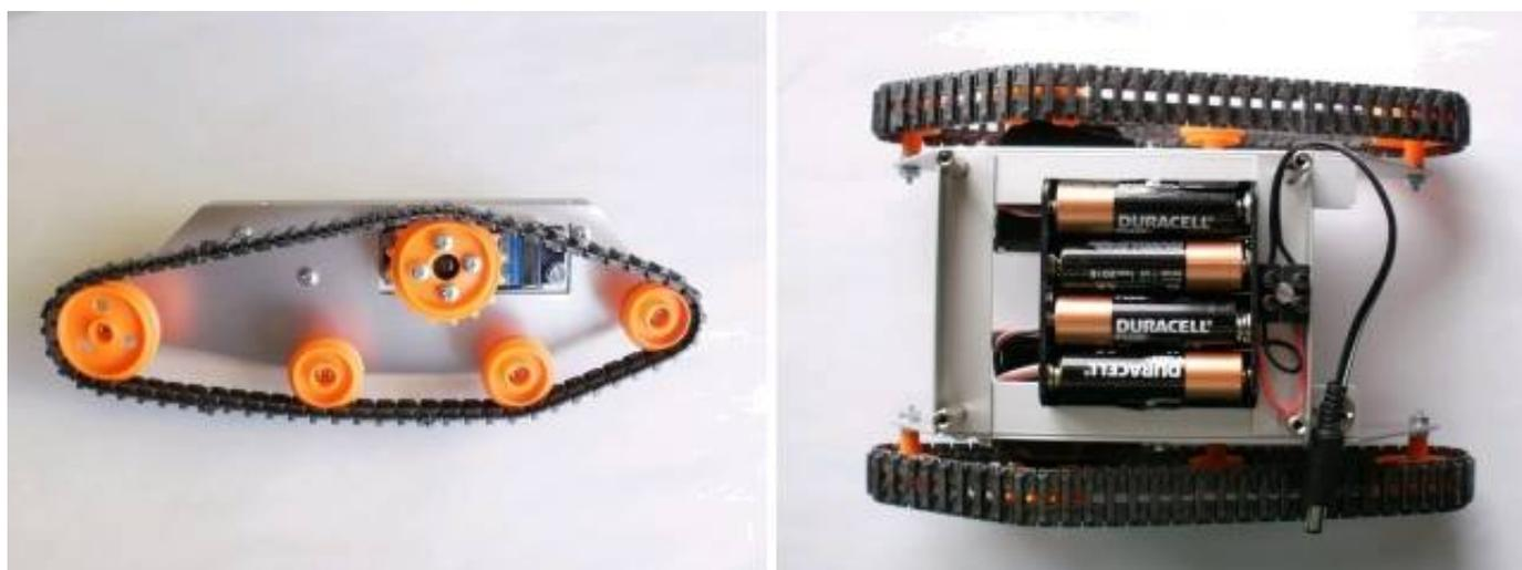
A questo punto i due cingoli potranno essere installati sulle rispettive ruote, esercitando una leggera trazione sul cingolo stesso.
