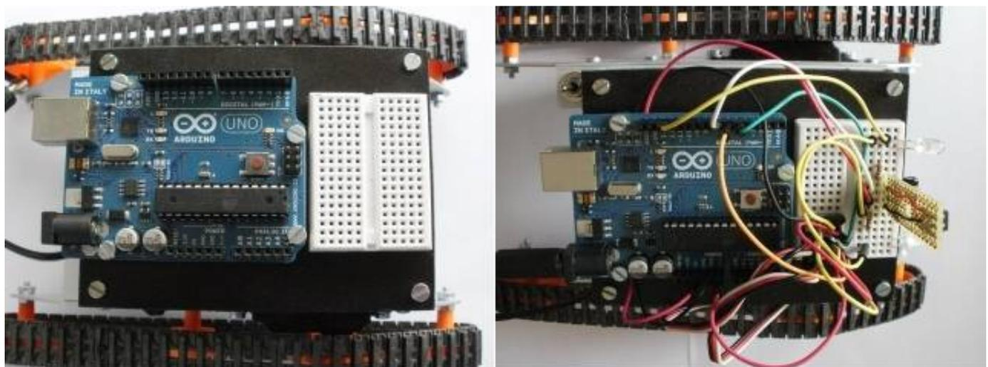
La mini breadboard **[11]** si fisserà alla piastra mediante la sua base autoadesiva.
