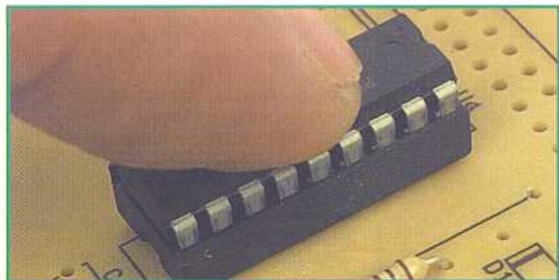
Introdurremo il PIC nello zoccolo con molta cautela, in modo da non danneggiare i piedini, facendo pressione sino a che non saranno completamente inseriti. La tacca del PIC deve coincidere con la tacca dello zoccolo, così come la tacca dello zoccolo deve coincidere con quella della serigrafia sulla scheda.
