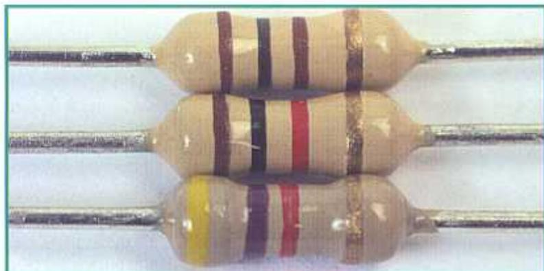
Osservando la tabella dei codici delle resistenze potremo determinare il valore in  $\Omega$  delle resistenze che dovremo saldare:
