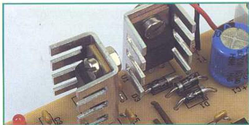
Ecco l'aspetto finale che deve avere la scheda di controllo, una volta saldato il connettore e montate le alette di raffreddamento per i regolatori.
