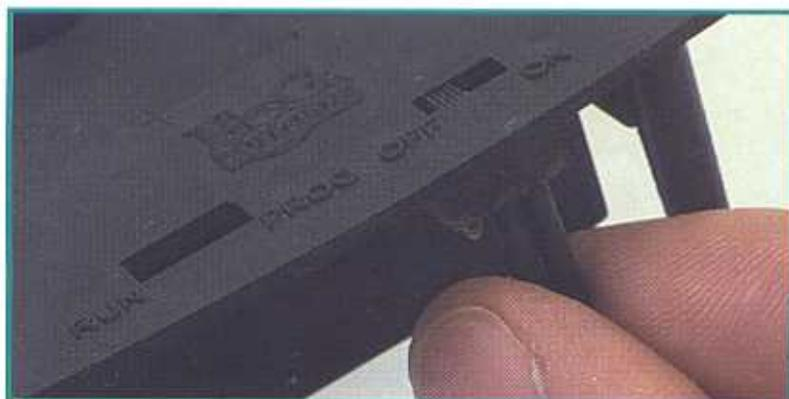
Per fare in modo che l'azionamento dell'interruttore corrisponda con i simboli ON/OFF stampati sulla base, dovremo introdurlo come mostra l'immagine. La leva mobile dell'interruttore fuoriuscirà dalla parte inferiore del telaio.
