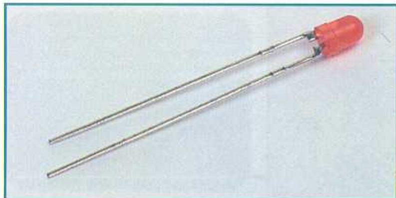
Il LED è un diodo di tipo speciale, che si illumina quando circola corrente attraverso di esso. Questo diodo, come tutti gli altri, ha una polarità. Il catodo (terminale negativo), è il piedino più corto. Si può anche individuare quale sia il catodo guardando il contenitore, dato che ha una zona leggermente rifilata.
