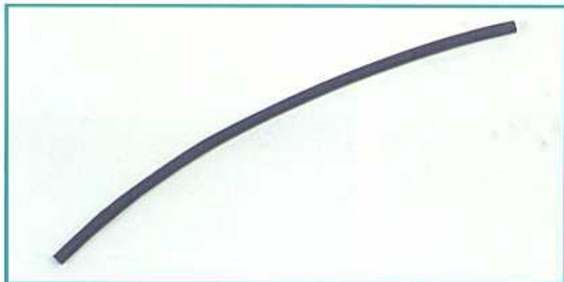
Tubo termorestringente da 3 mm di diametro, che utilizzeremo per isolare i piedini dei sensori dopo averli montati e saldati ai cavi. Grazie al termorestringente eviteremo che i piedini dei sensori entrino in contatto fra di loro.
