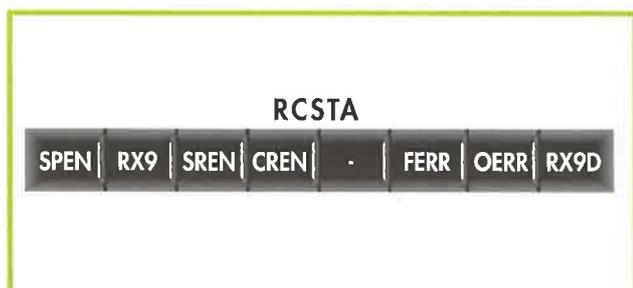
Struttura interna del registro RCSTA incaricato del controllo della ricezione dell'USART.
