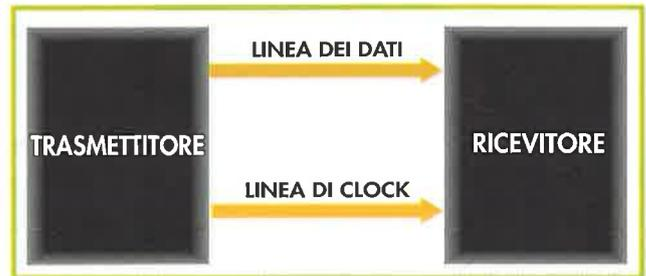
*Nella comunicazione seriale sincrona, ogni volta che il trasmettitore deposita un bit sulla linea dei dati, è generato un impulso di clock per determinare la raccolta del medesimo dal ricevitore.*
