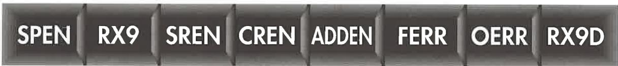
Struttura interna del registro RCSTA per il ricevitore asincrono dell'USART.
