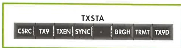
Struttura interna del registro di stato del trasmettitore dell'USART del PIC16F87X.
