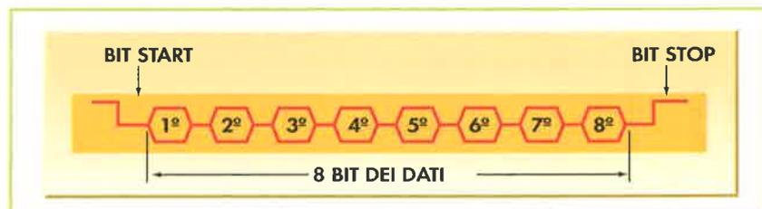
Nella comunicazione seriale asincrona di base, ogni pacchetto di bit dei dati deve essere preceduto da un bit di Inizio (Start) e seguito da un bit di Fine (Stop).
