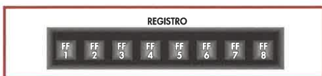
Un registro che contiene otto bit è formato da otto flip-flop.
