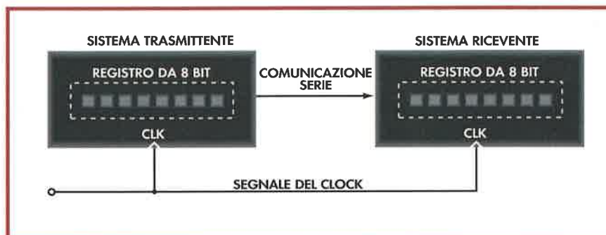
Trasferimento seriale sincrono fra due registri digitali.
