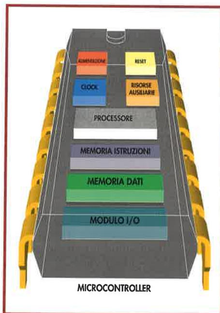
All'interno di un microcontroller ci sono tutti i blocchi del computer.
