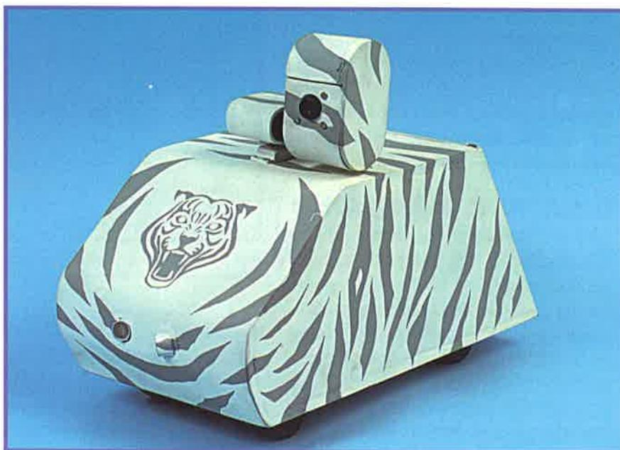
*La struttura del Ciclope è in PVC.*
