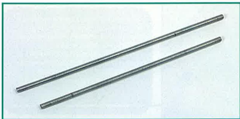
Le barre filettate si inseriscono nel telaio di Monty. In seguito serviranno per sorreggere e dividere le diverse schede. Nell'immagine si vede come restano una volta montate. La barra corta è situata nella parte anteriore del telaio e quella più lunga nella parte posteriore; vengono fissate con una goccia di adesivo.
