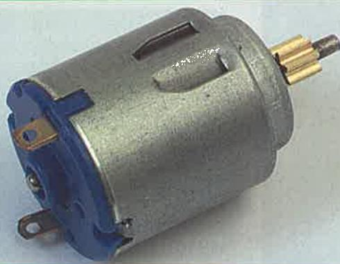
Il motore che si vede nella foto è uno dei due che costituiranno il sistema di trazione di Monty. Questi motori serviranno per fornire trazione in avanti, in modo che attivando il motore di destra o quello di sinistra il robot girerà a destra o a sinistra. Sarà dotato di una riduzione e di un contenitore per essere inserito nello chassis.
