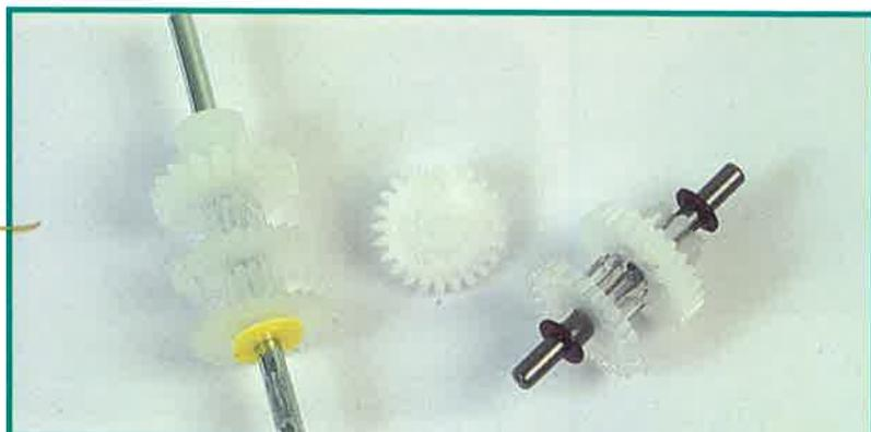
Questo è il sistema di trasmissione/riduttore con cui prepareremo l'altro motore di Monty. Anche questa volta dovremo identificare ognuno degli assi con i suoi diversi ingranaggi. Procederemo con il montaggio del sistema allo stesso modo di come abbiamo fatto in precedenza.
