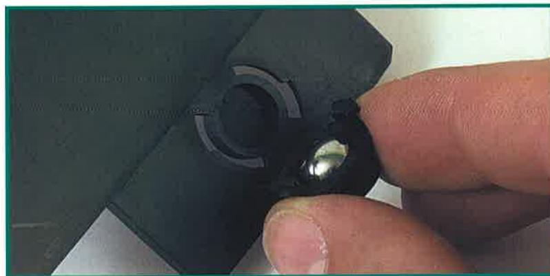
Monteremo il ruotino sul telaio e una volta inserito, monteremo il coperchio del ruotino, per fare in modo che la sfera non esca dalla sua sede e aderisca alla struttura. È un sistema di spostamento simile a quello del mouse del nostro personal computer.
