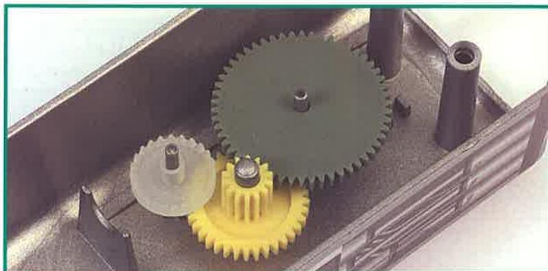
Il terzo ingranaggio da montare è quello più grande. Come si vede nella figura, esso riceve movimento tramite l'ingranaggio medio. Mediante una guida che vi sarà fornita in seguito, l'ingranaggio grande converte il movimento di rotazione in un altro di traslazione.
