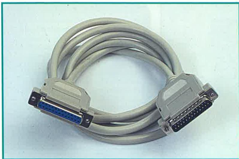
La scheda di controllo in cui è montato il microcontroller, servirà per la programmazione del medesimo. Per realizzare questo lavoro dobbiamo utilizzare un cavo parallelo con connettore DB25, come quello che si vede nell'immagine. Il cavo avrà ad un estremo un connettore femmina, e all'altro uno maschio. Questo tipo di cavo è standard e può essere acquistato in tutti i negozi di informatica e di elettronica.
