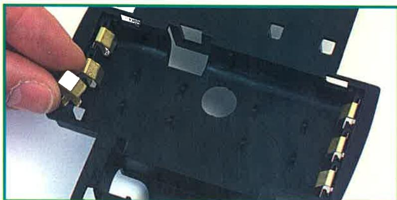
Dovremo introdurre in modo che l'aletta mobile della connessione rimanga orientata verso l'interno del contenitore. Inoltre dovremo schiacciare un po' questa aletta per facilitare l'inserzione delle pile.
