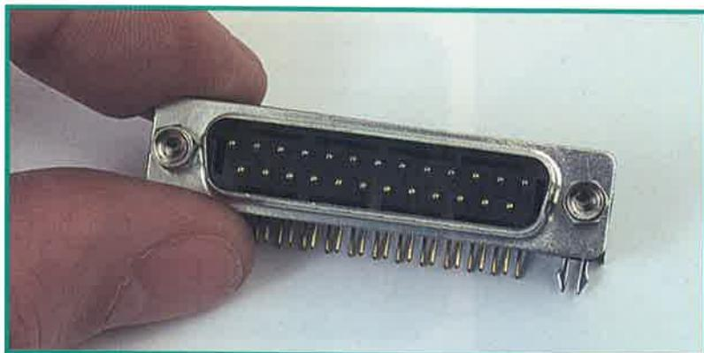
Il connettore DB25 che dobbiamo saldare, è un tipo di connettore standard di comunicazione. Tutti i PC ne hanno uno che di solito è utilizzato per collegare la stampante o lo scanner.
