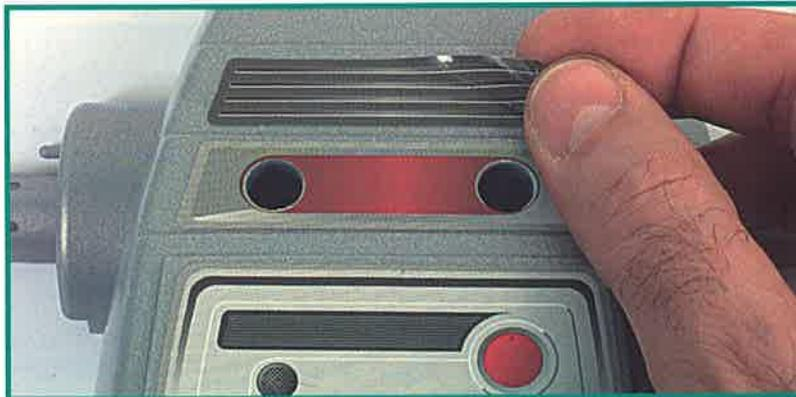
Decoreremo la seconda metà del corpo di Monty. Gli adesivi devono essere disposti con cura, in modo che non si danneggino, facendo attenzione ad incastrarli e allinearli correttamente, evitando le bolle d'aria.
