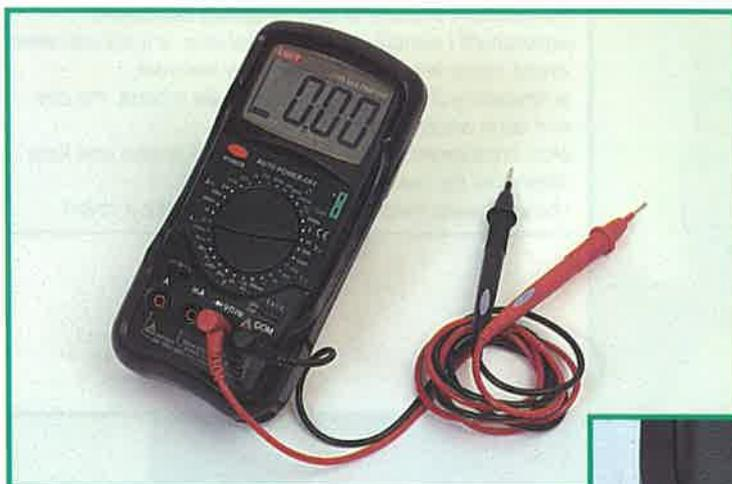
Il tester è uno strumento che permette di effettuare misure di tensione e di corrente, sia continua che alternata. Misura anche la conduttività, la resistenza dei componenti e, alcuni modelli, misurano la capacità dei condensatori e il guadagno dei transistor.
