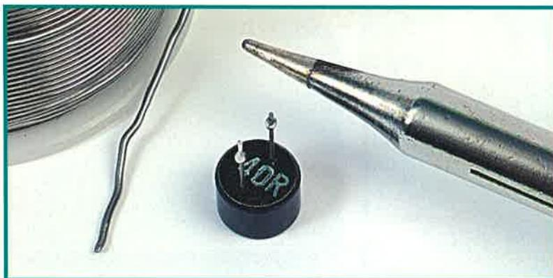
Dovremo fondere lo stagno sui piedini della capsula ad ultrasuoni per facilitarne la saldatura. Per questo depositeremo un po' di stagno sul piedino della capsula e ne fonderemo una piccola goccia con il saldatore.
