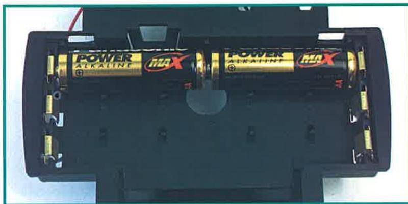
Ora possiamo inserire le pile. Ne introdurremo due in ogni fila, e dovremo far pressione sino a che saranno perfettamente inserite.
