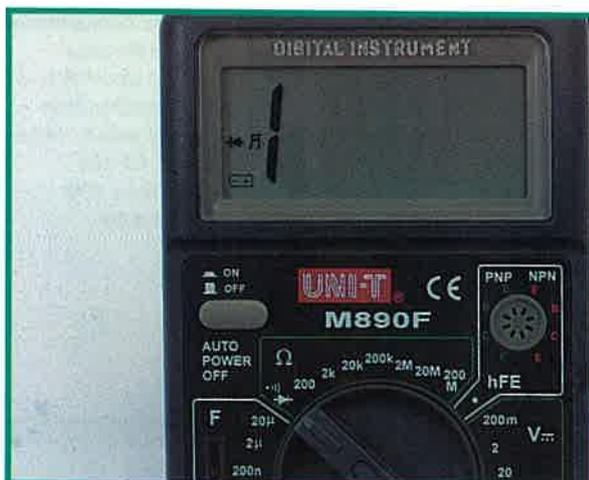
Una delle funzioni più utili che hanno alcuni tipi di tester, consiste nella misura dei diodi. Con questa funzione possiamo determinare lo stato interno di un diodo. Lo strumento misura la tensione di soglia del diodo quando questo viene polarizzato correttamente. Questa tensione di soglia è regolata a 0,3 V, per i diodi al germanio e a 0,7 V per quelli al silicio.
