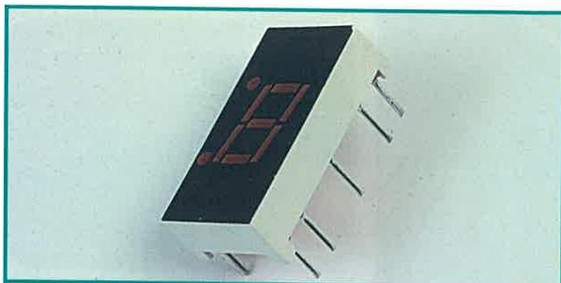
Montiamo ora l'ultimo componente che ci resta da mettere sulla scheda di Ingressi e Uscite: il display a sette segmenti. Si tratta di un display a codo comune.
