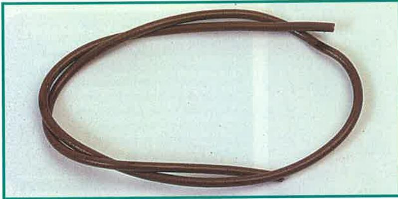
La scheda di controllo è un circuito stampato a singola faccia, dato che contiene le piste solo sulla parte inferiore e non su entrambi i lati. Sarà necessario realizzare alcuni ponticelli sulla parte superiore della scheda per poter collegare le piste che non abbiamo unite nella parte inferiore. Per i ponticelli utilizzeremo questo cavo.
