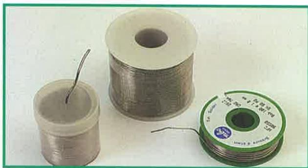
*Il metallo con il quale vengono saldati i componenti elettronici sulla scheda del circuito stampato chiamato PCB (dall'inglese Printed Circuit Board, circuito stampato) è lo stagno. Per questo deve essere fuso utilizzando il saldatore.*
