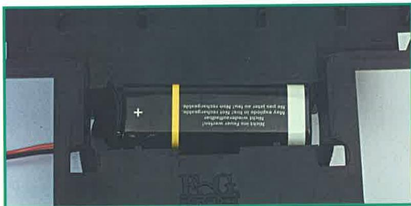
Il connettore della pila è per i modelli da 9 V. Il telaio di Monty possiede, nella sua parte inferiore, un incavo in cui potremo alloggiare questa pila; inoltre possiede un'apertura dalla quale potremo far uscire i cavi all'esterno, anche con il coperchio chiuso.
