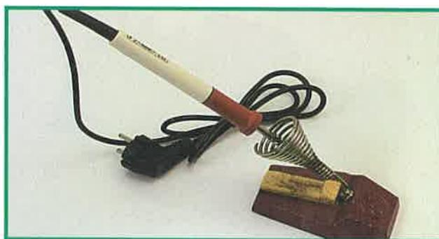
*Il saldatore è un attrezzo che genera il calore necessario per poter fondere lo stagno. Ricordiamoci, quando eseguiremo le operazioni di saldatura, di evitare il contatto diretto fra lo stagno e la punta del saldatore.*
