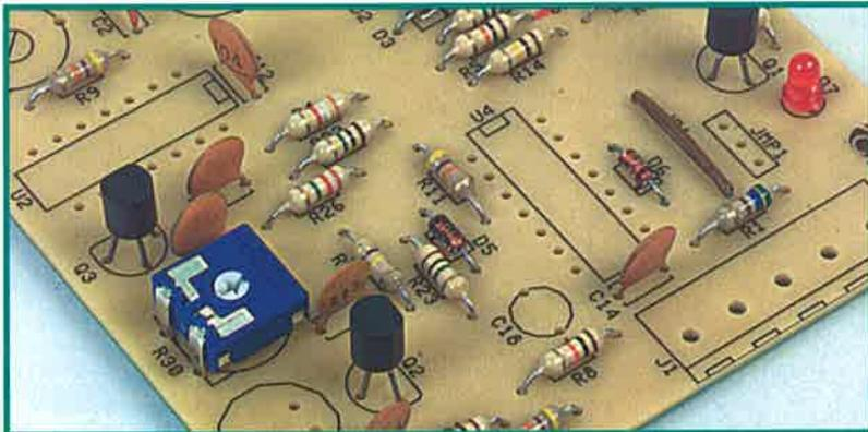
Allo stesso modo di Q1 installeremo altri due transistor BC547 in Q2 e Q3. Dobbiamo inserire tutti i transistor in modo che la loro vista superiore faccia coincidere la forma a mezzaluna del transistor con la forma a mezzaluna serigrafata sulla scheda. Salderemo i transistor.
