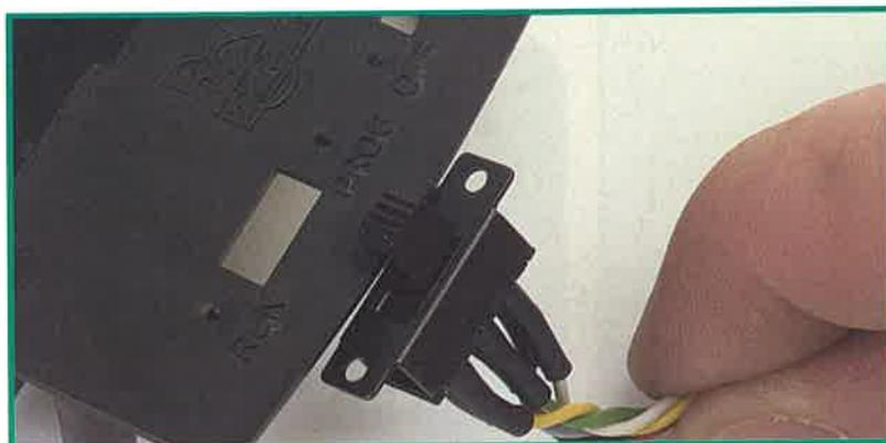
Questo interruttore è collocato sul telaio del robot. Dovremo montarlo nella fessura più grande, situata nella parte anteriore del medesimo. Per fare in modo che l'azionamento dell'interruttore corrisponda con le parole PROG/RUN segnate sul telaio, dovremo introdurlo così come mostrato nell'immagine.
