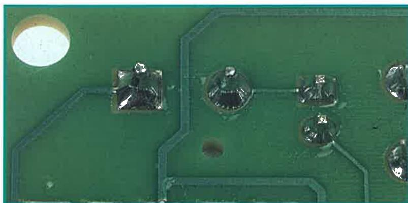
Le saldature della morsetteria hanno bisogno di più stagno delle saldature normali dei diodi e delle resistenze. Dopo aver realizzato la saldatura non è necessario tagliare il resto dei piedini.
