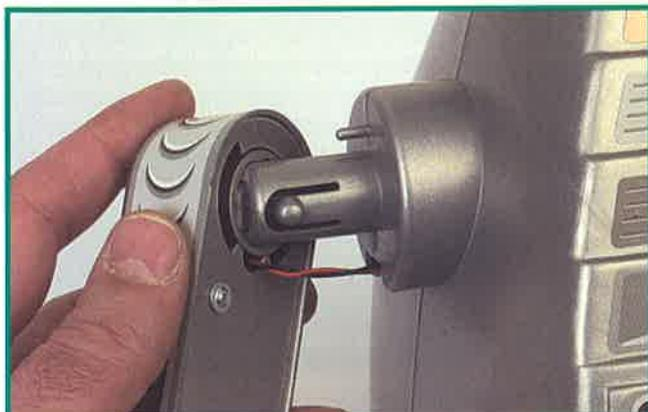
Nell'immagine possiamo vedere il montaggio del braccio della pinza sul corpo di Monty; si tratta del braccio destro del robot. I cavi del motore si inseriscono all'interno della spalla per poterli collegare alla morsettiera J2 della scheda di controllo del braccio. Il braccio si fissa mediante la corrispondente clip.
