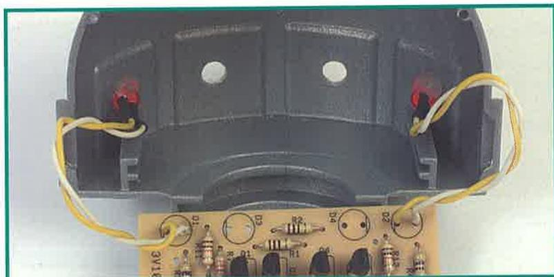
I due diodi LED dovranno essere introdotti sui due fori estremi della testa. Saranno fissati mediante adesivo. Guardando la testa frontalmente, sul lato interno, i cavi del LED di sinistra si saldano sulla scheda, nel punto riferito come D1. Il LED di destra in D2. I cavi gialli corrispondono al catodo e devono essere introdotti nel foro orientato verso la riga della serigrafia.
