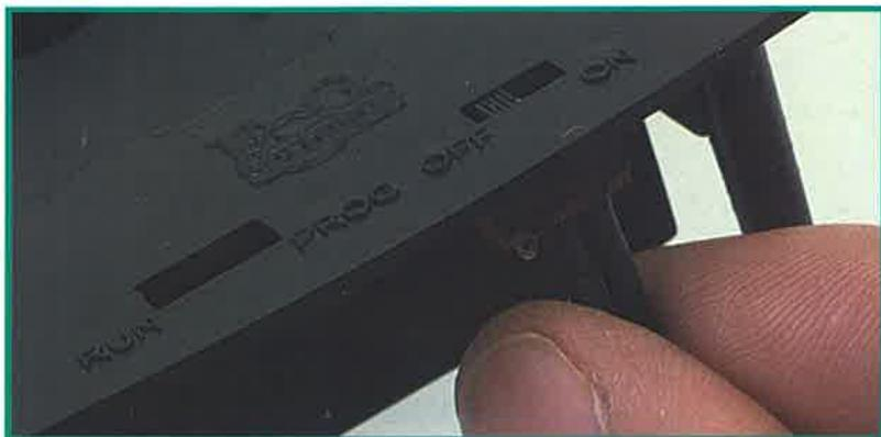
Se vogliamo fissare l'interruttore in questa posizione, riscaldiamo col saldatore i due puntelli di plastica in cui l'avremo inserito. Questa plastica si scioglierà e fisserà l'interruttore. Vi raccomandiamo di fare questa operazione solo più avanti, quando la scheda di controllo sarà completamente montata.
