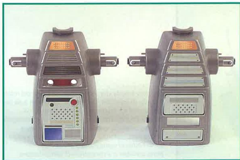
Nell'immagine si mostrano le due metà che formano il corpo di Monty. Come già spiegato nei fascicoli precedenti, nei punti previsti e su entrambe le metà, bisognerà aver realizzato le corrispondenti aperture che danno accesso ai connettori della scheda di controllo, e permettono di alloggiare le capsule ad ultrasuoni. Inoltre si suppone che siano già state decorate con gli appositi adesivi.
