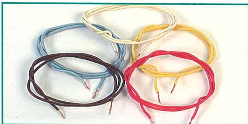
Utilizzeremo questi cinque cavi per realizzare le connessioni tra la scheda dei sensori e quella di potenza. La scheda dei sensori non si collegherà pertanto tramite il Pic-bus, ma mediante le morsettiere e dei cavi.
