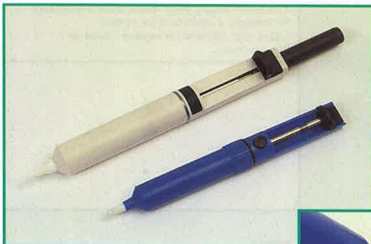
*Il dissaldatore serve per eliminare lo stagno da una saldatura e poter estrarre il componente precedentemente saldato. Si basa sul movimento di una forte molla che produce il risucchio dello stagno fuso. Il processo di dissaldatura è molto più delicato e complesso rispetto a quello della saldatura. Per quanto possibile deve essere evitato.*
