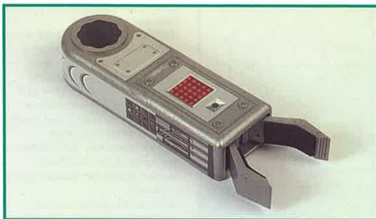
Questa è la pinza di cui sarà dotato il robot in uno dei suoi bracci. Sarà comandata da un motore a corrente continua, e servirà per raccogliere oggetti e depositarli dove vogliamo. Per controllare l'apertura e la chiusura della pinza sarà necessaria una scheda speciale, che governi il senso di rotazione di questo motore.
