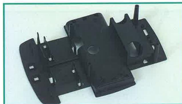
La struttura meccanica più importante del robot è il telaio, nel quale saranno inseriti il motore, le ruote e le schede del circuito impresso. Avrà anche il compito di portare tutta la struttura del robot.
