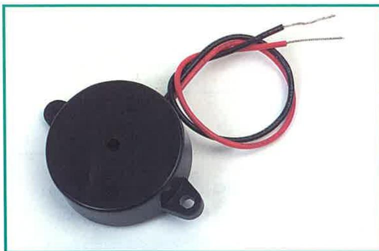
Oltre ai dispositivi digitali ottici di uscita, come i display o i led, disponiamo anche di dispositivi sonori. I sensori piezoelettrici, emettono un suono quando sono attivati da un '1' logico, e smettono di emettere quando ricevono uno '0'. Si possono attivare direttamente con il segnale di uscita di qualunque piedino del microcontroller PIC.
