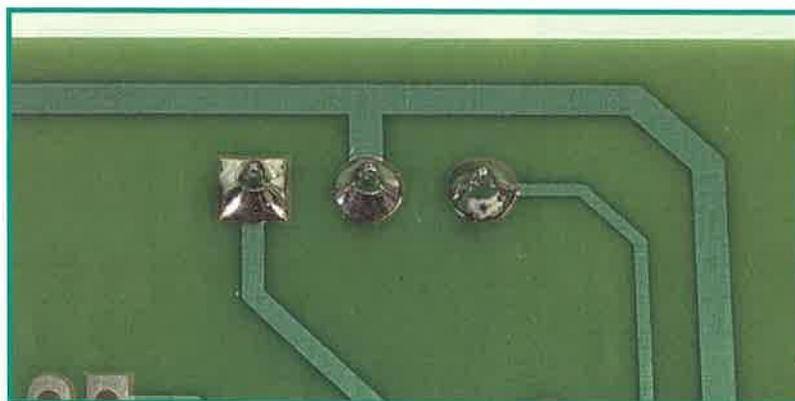
Nell'immagine si possono vedere le saldature realizzate sulla morsettieria. È necessario utilizzare più stagno rispetto alle saldature del resto dei componenti elettronici della scheda. Dobbiamo ottenere dei coni brillanti e appoggiati sulla superficie.
