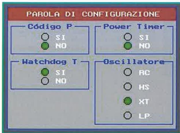
Ricordate di selezionare l'opzione "Watchdog Si" al momento di programmare il microcontroller, dato che questo programma lo utilizza. In questo modo scriveremo la parola di configurazione del PIC, e il programma funzionerà correttamente.
