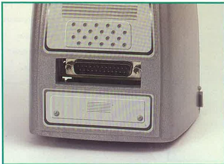
Come si vede nell'immagine, la parte posteriore del corpo di Monty permette l'accesso al connettore DB25 della scheda di controllo. Tramite questo connettore si realizza la connessione con il PC, in modo da poter programmare sul PIC i numerosi programmi di applicazione senza aprire la struttura del robot.
