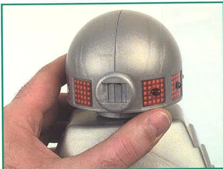
*La testa del robot si monta sopra il collo del corpo, che serve anche per bloccarlo e fissarlo bene. La testa inoltre dispone di due clips, che tengono insieme le due metà da cui è formato. Dobbiamo fare pressione su tutti e due gli elementi fino a che non siano ben uniti e fissati.*
