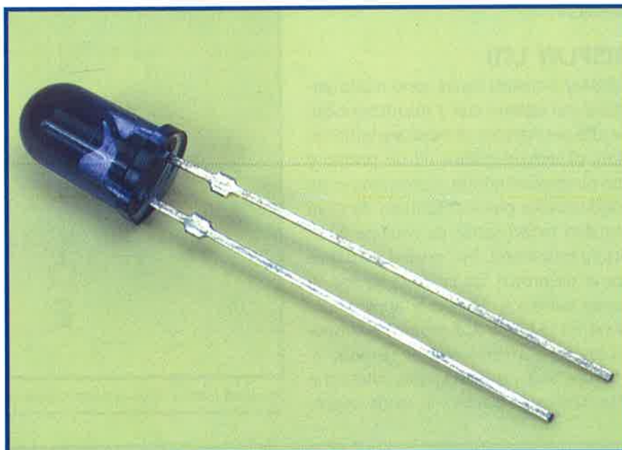
I comandi a distanza dei televisori contengono un diodo LED emettitore di luce infrarossa.
