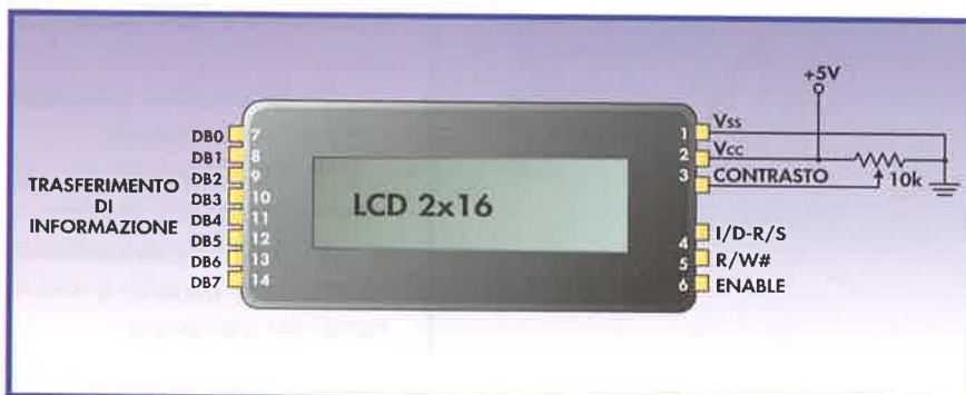
Schema dei collegamenti del display LCD modello WM-C1602M.
