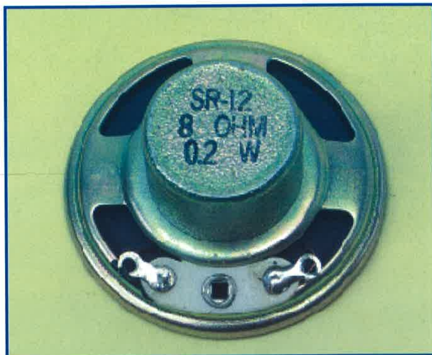
Sull'esterno del contenitore sono riportati i valori dell'impedenza della bobina e della potenza che può sopportare.
