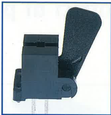
Fotointerruttore con levetta girevole, che interrompe il raggio di luce.
