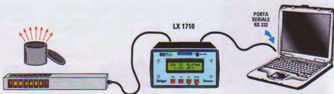
Fig.14 Prima di procedere all'interfacciamento del contatore con il personal computer dovrete verificare che il vostro pc sia dotato della presa di comunicazione seriale RS232. In caso contrario potrete effettuare ugualmente il collegamento tramite la porta USB del computer a patto di utilizzare un adattatore RS232 - USB come indicato in figura 12. In questo caso vi consigliamo di utilizzare adattatori di marche conosciute e di installare i driver seguendo attentamente le istruzioni riportate nel manuale di istruzioni allegato.
