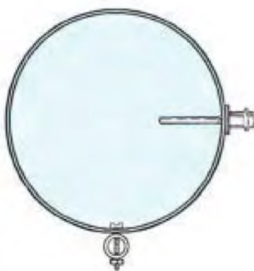
Fig. 6 L'antenna fissata sul BNC deve essere tenuta in posizione orizzontale. L'apertura anteriore dell'illuminatore potrà essere chiusa con un disco di polistirolo espanso dello spessore di 2-3 cm. in quanto il polistirolo non attenua il segnale SHF.
