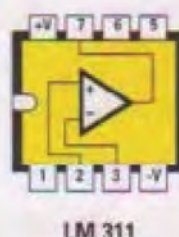
Fig.1 Connessioni viste da sopra dell'integrato LM.311 che provvede a ripulire il segnale dai disturbi spuri captati dall'antenna ricevente.
