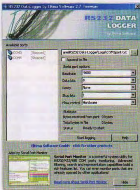
Fig.15 Per realizzare l'interfacciamento del contatore Geiger con il personal computer, sarà disponibile prossimamente un software dedicato, che consentirà di acquisire i dati presentandoli in modo da realizzare una gradevole presentazione di grafici e statistiche. Già ora, tuttavia, è possibile interfacciare lo strumento mediante collegamento via RS232, come indicato in figura, utilizzando uno dei tanti programmi di acquisizione disponibili gratuitamente su Internet. A titolo di esempio noi abbiamo impiegato un programma che si chiama "RS232 Datalogger", che potrete scaricare gratuitamente dal sito: http://www.eltima.com/download/rs232-data-logger
