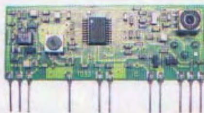
Fig.2 Sebbene la recente produzione del modulo KM01.40, riconoscibile per le dimensioni ridotte dell'integrato e per la scritta RX FM-Audio 2007 su un lato dello stampato, proponga il segnale ricevuto invertito di fase, le caratteristiche tecniche non sono cambiate.
