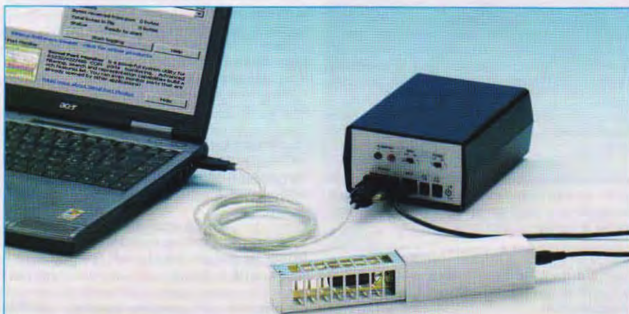
Fig.12 Prima di procedere all'interfacciamento del contatore con un personal computer dovrete verificare che il vostro pc sia dotato della presa di ingresso seriale. In caso contrario dovrete effettuare il collegamento tramite un adattatore RS232-USB come indicato in figura.
