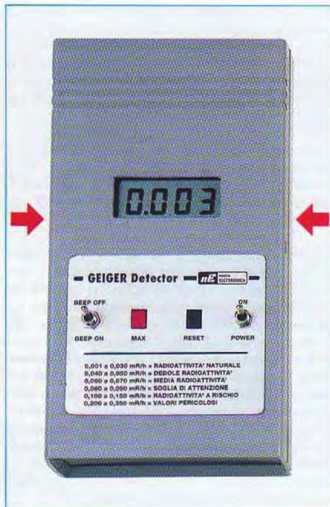
Fig.1 In questa foto è riprodotto il contatore Geiger LX.1407 che abbiamo presentato nella rivista N.228 e di cui oggi vi proponiamo l'interessante miglione descritta in queste pagine.
