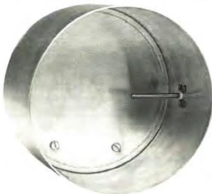
Fig. 6 L'antenna fissata sul BNC deve essere tenuta in posizione orizzontale. L'apertura anteriore dell'illuminatore potrà essere chiusa con un disco di polistirolo espanso dello spessore di 2-3 cm. in quanto il polistirolo non attenua il segnale SHF.
