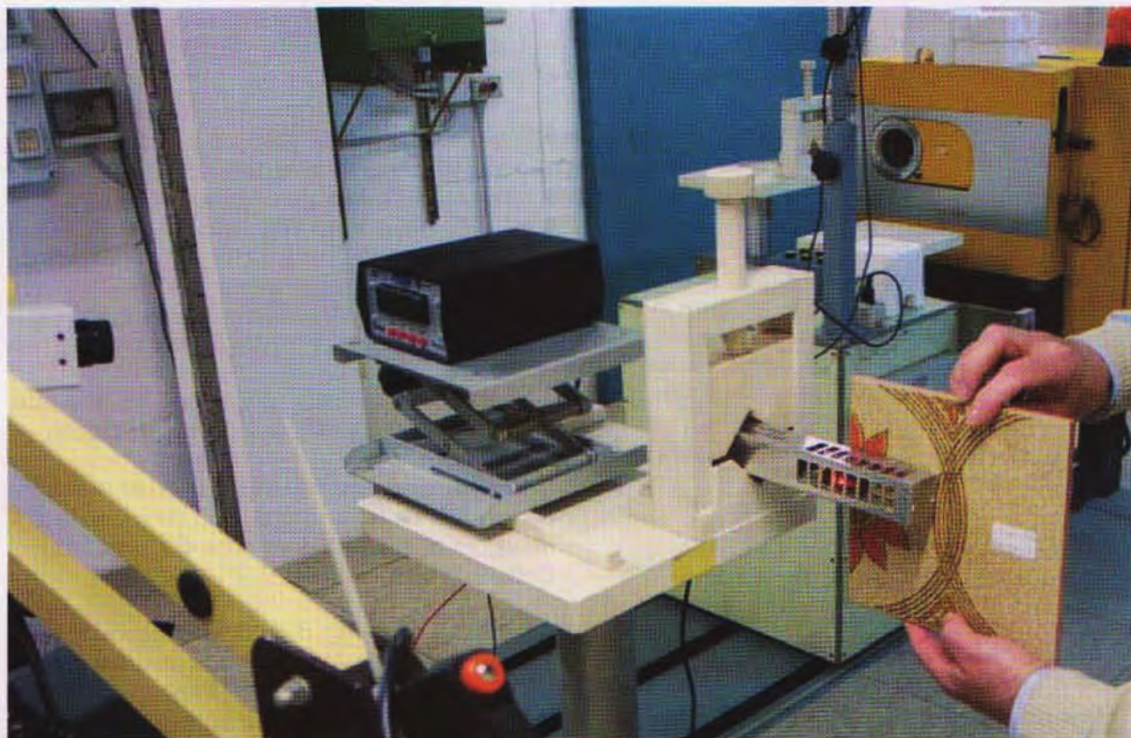
Fig.8 A volte si sente parlare della debole radioattività riscontrabile in alcuni materiali utilizzati in edilizia, come granito, tufo, mattonelle in ceramica, ecc. Per curiosità abbiamo voluto sottoporre a misura una mattonella in ceramica di vecchia fabbricazione e con nostra sorpresa il nostro contatore Geiger è stato in grado di rilevare una debole emissione di raggi gamma, proveniente probabilmente dalle terre presenti nei pigmenti usati per la colorazione.
