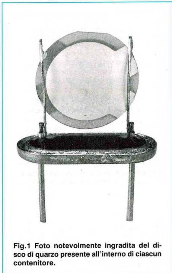
Fig.1 Foto notevolmente ingrandita del disco di quarzo presente all'interno di ciascun contenitore.
