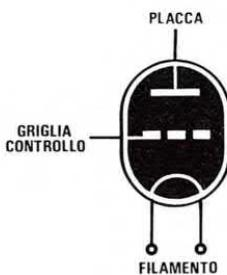
Fig.16 Simbolo grafico di un Triodo sprovvisto di Catodo.
