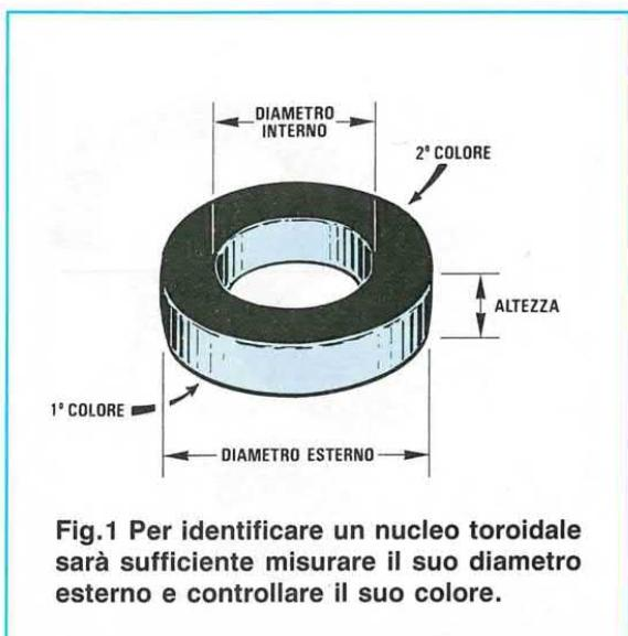
Fig.1 Per identificare un nucleo toroidale sarà sufficiente misurare il suo diametro esterno e controllare il suo colore.
