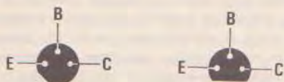
Fig. 3 Connessioni dei terminali dei transistor impiegati in questo progetto visti dal lato in cui fuoriescono dal corpo.
