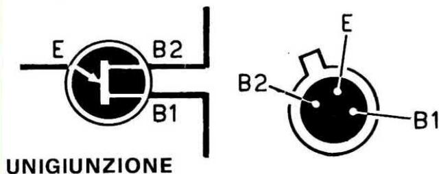
Fig. 3 Tra fet e transistor normale il simbolo dell'unigiunzione si avvicina senza dubbio molto di più a quello del primo componente al quale praticamente è identico, se escludiamo il fatto che il terminale dell'emettitore nell'unigiunzione risulta fortemente inclinato. Anche i terminali di collegamento sono in numero di 3, come per la maggior parte dei transistor, solo che ne varia la disposizione e la denominazione.
