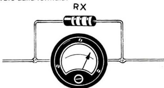
Per ampliare la portata degli strumentini di misura sarà sufficiente inserire in parallelo ad essi una resistenza nel modo indicato in figura. Il valore della resistenza da inserire è deducibile dalla formula da noi utilizzata nell'esempio riportato nell'articolo.
