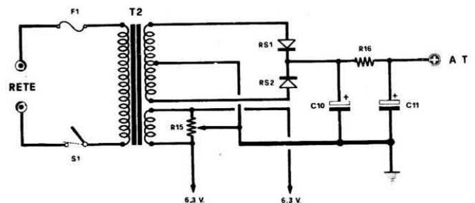
valvola raddrizzatrice 5Y3 che si surriscaldava in maniera inaccettabile, infine ho aggiunto in parallelo all'alimentazione dei filamenti un potenziometro a filo da 500 ohm che risulta utile per combattere il ronzio. Volendo fare una cosa raffinata si potrebbero accendere le valvole con tensione continua di 6,3 volt.
