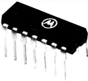
Fig. 2 Esternamente l'integrato MC1302P si presenta sotto forma di un parallelepipedo provvisto di 14 piedini di utilizzazione che vengono numerati a partire dal punto di colore che contraddistingue il terminale n. 1. Il nostro disegno riporta esattamente le proporzioni dell'integrato con dimensioni maggiorate, rispetto alla realtà.
