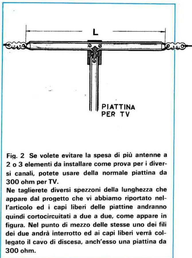
**Fig. 2** Se volete evitare la spesa di più antenne a 2 o 3 elementi da installare come prova per i diversi canali, potete usare della normale piattina da 300 ohm per TV.
