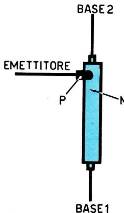
**Fig. 1** Costruttivamente il transistor si presenta come una sbarretta di materiale N nella quale è stato immessa una giunzione P. I capi della sbarretta N portano due reofori che corrispondono alle due basi mentre la giunzione P è in collegamento con il terminale che corrisponde all'emettitore.
