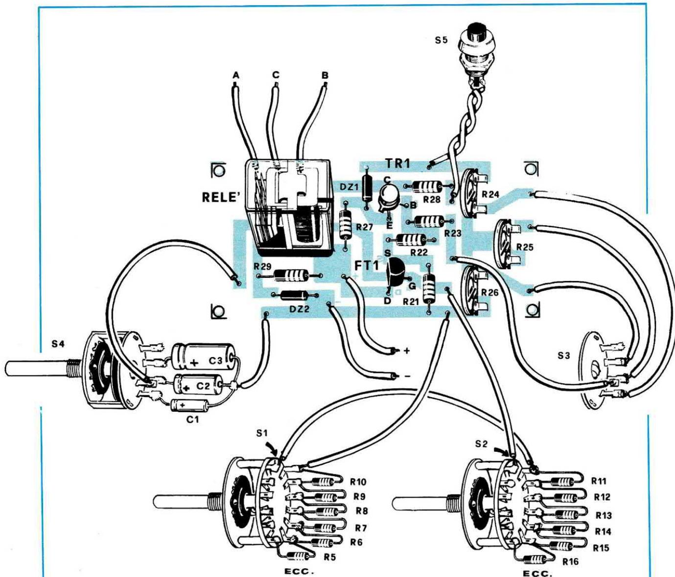
**Fig. 3** I vari componenti del contasecondi andranno sistemati sul circuito stampato o nel modo visibile in figura. I terminali posteriori del relé risultano al di fuori delle tracce di rame, in quanto le stesse verrebbero a trovarsi quasi a contatto con le vicine, per cui occorrerà provvedere a collegarli tramite dei corti spezzoni di filo di rame.
