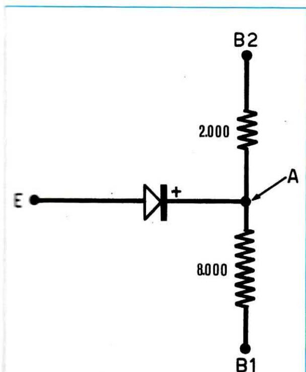
Fig. 2 Funzionalmente il transistor unigiunzione è rapportabile ad un diodo sul cui catodo (polo positivo) è inserito un partitore composto da due resistenze di valore diverso. Il punto A corrisponde al punto in cui è inserita la giunzione P ed il valore delle due resistenze corrisponde al valore resistivo esistente, in condizioni normali, tra detto punto ed i capi della sbarretta. Il valore diverso è dato dal fatto che la giunzione P non è al centro della sbarretta N
