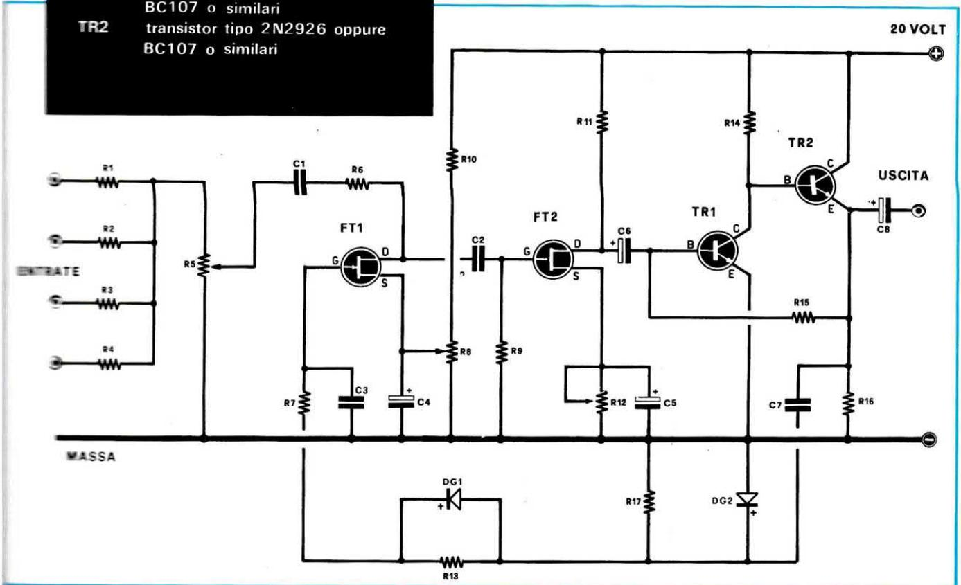
R6 ed il condensatore C2, il fet, al posto del mosfet MFT1, che serve a ridurre il segnale inserito in entrata in dipendenza di quello d'uscita.
