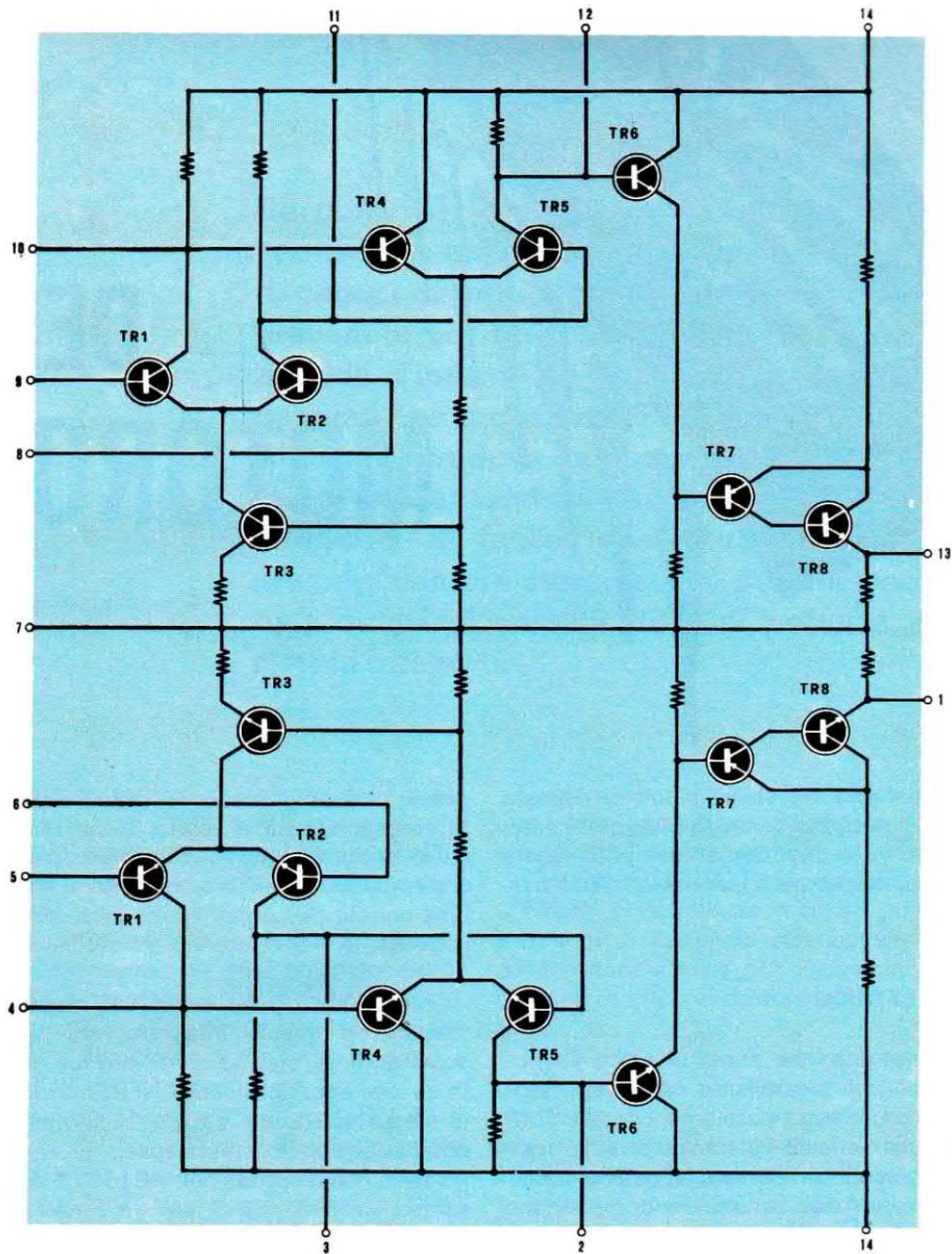
Fig. 1 In figura appare il circuito integrato MC 1302P completo di tutti i componenti di cui si avvale. Come potete constatare esso è formato da due parti separate, ma perfettamente uguali, ognuna fornita dei propri terminali di utilizzazione. Nei punti 10-11-12 (e corrispettivamente nei 2-3-4) vanno inseriti i circuiti esterni di compensazione in frequenza.
