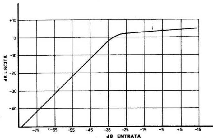
**Fig. 3** Nel diagramma è visibile la curva che mostra l'azione del compressore sulla tensione del segnale che si ritrova in uscita. Come potete constatare la curva segna una sensibile linearità della dinamica d'uscita mantenendosi a valori massimi quasi perfettamente costanti, fatto questo che determina l'efficacia del nostro compressore che servirà ad evitare che segnali troppo forti possano rovinare la registrazione.
