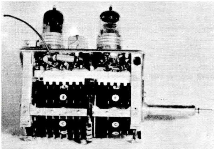
Il filo che andrà a collegarsi al condensatore variabile esterno verrà saldato sul secondo terminale contando da destra della basetta in ceramica; tale terminale corrisponde al piedino 1 della valvola PCF82, cioè la placca della sezione triodica dello stesso tubo.
