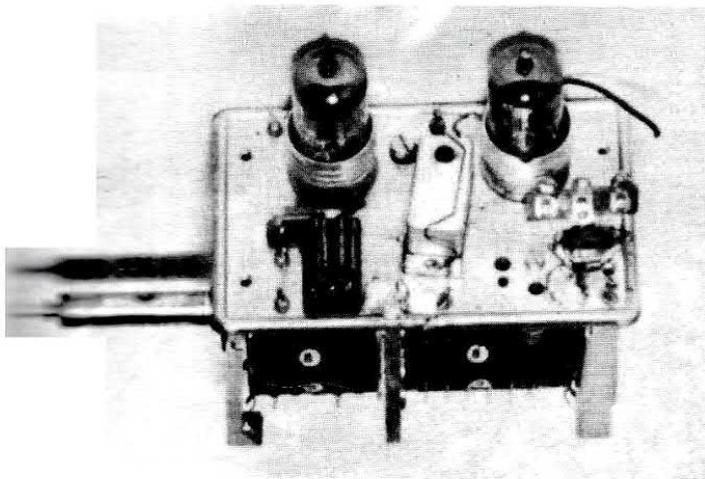
Il gruppo visto superiormente. L'uscita del segnale di AF sarà prelevata dai due terminali estremi della basetta visibile a sinistra, tramite uno spezzone di piattina da 300 ohm e collegata alla presa antenna VHF del televisore.
