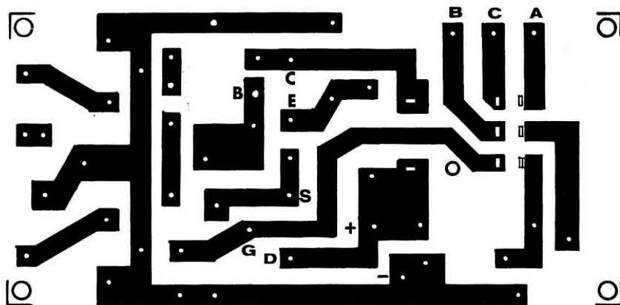
Fig. 2 Chi volesse realizzare il nostro contasecondi con il sistema dei circuiti stampati potrà servirsi del disegno che appare in figura nel quale è visibile il circuito stampato, a grandezza naturale, di cui ci siamo serviti per il nostro prototipo. Vi sarà facile riportarlo su di una basetta di rame ed inciderlo con l'apposito acido.
