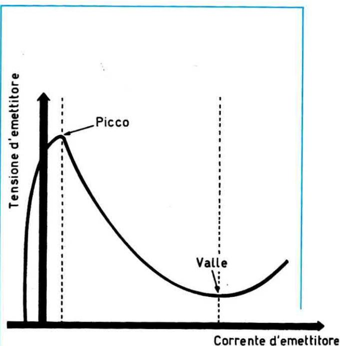
Fig. 6 I parametri di utilizzazione dei transistor unigiunzione sono quelli che appaiono nel grafico di figura e dipendono dalle caratteristiche costruttive del particolare semiconduttore considerato. La tensione di picco è quella che mette in conduzione il transistor che continua a condurre fino a che la tensione cade al punto di valle, punto nel quale esso va in interdizione.
