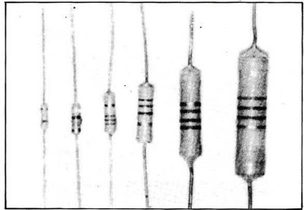
Nella foto abbiamo delle resistenze tipo Philips riportate a grandezza naturale: partendo da sinistra sono rispettivamente da 1/4 Watt, da 1/2 Watt, da 1 Watt, da 1,5 Watt, da 2 Watt e da 3 Watt.
