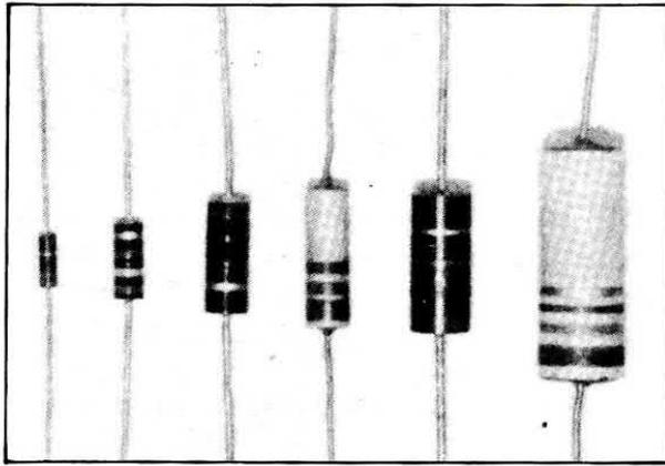
Nella foto resistenze tipo americano a grandezza naturale; partendo da sinistra abbiamo come prima la resistenza da 1,4 di Watt, poi quella da 1/2 Watt, da 1 Watt, da 1,5 Watt, da 2 Watt e da 3 Watt.
