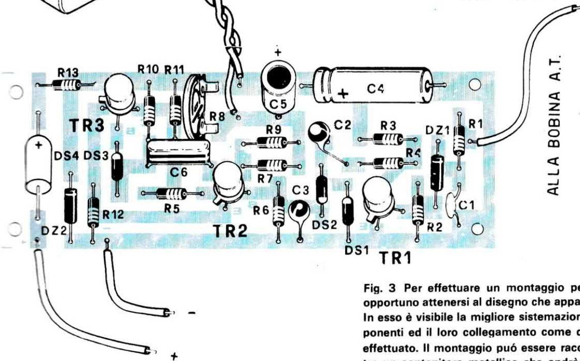
Fig. 3 Per effettuare un montaggio perfetto sarà opportuno attenersi al disegno che appare in figura. In esso è visibile la migliore sistemazione dei componenti ed il loro collegamento come deve essere effettuato. Il montaggio può essere racchiuso dentro un contenitore metallico che andrà poi fissato alla carrozzeria.
