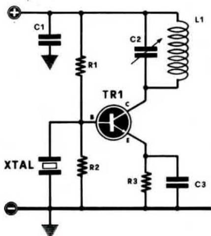
Fig. 18 oscillatore a quarzo per 27 MHz.
