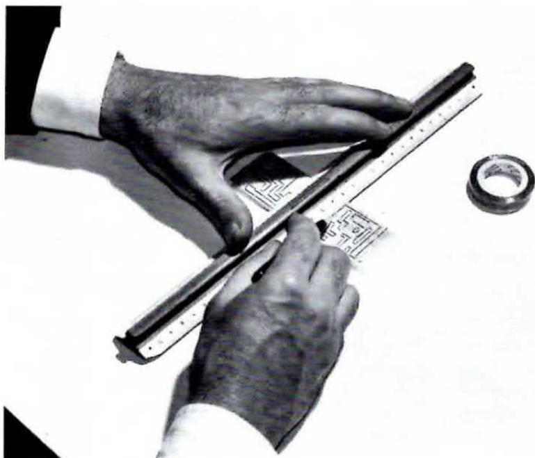
Fig. 5 - Con una biro riscalcate i contorni del disegno. Per evitare che il disegno abbia a muoversi durante l'operazione di ricalco, fissate carta carbone e disegno alla lastra di rame con nastro autoadesivo.
