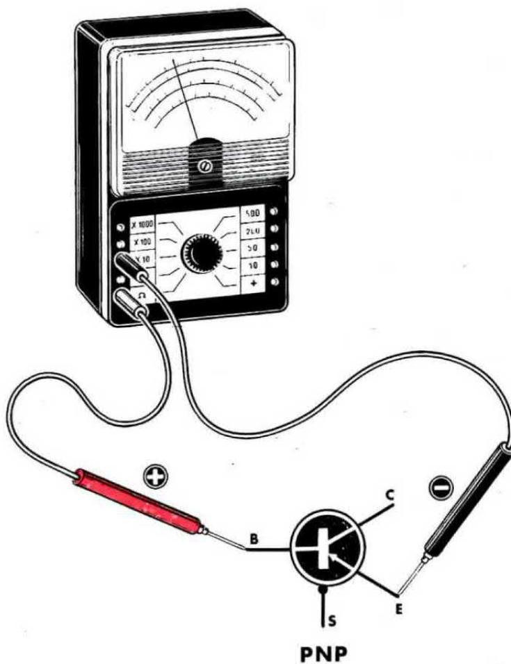
Fig. 17 Nei transistor a 4 terminali, cioè provvisti dello schermo, il puntale collegato alla base rispetterà le condizioni già precisate per i tipi PNP o NPN soltanto che in questo caso il valore ohmico tra B-C dovrà risultare sempre superiore a quello tra B-E.
