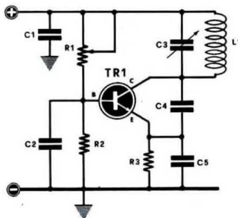
Fig. 7 oscillatore VFO tipo COLPITTS
