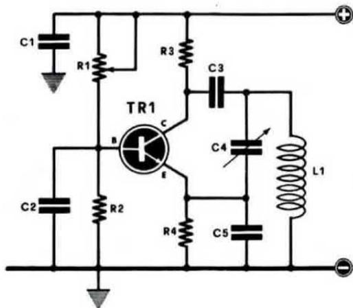
Fig. 6 oscillatore VFO tipo COLPITTS
