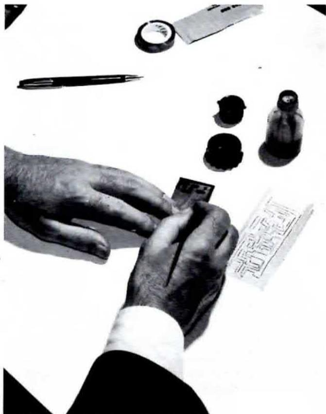
Fig. 6 - Terminata l'operazione di ricalco, sul rame risulterà riportato dalla carta carbone il disegno del vostro circuito. La superficie di rame che vogliamo rimanga sulla basetta andrà ora ricoperto con l'apposito inchiostro protettivo.
