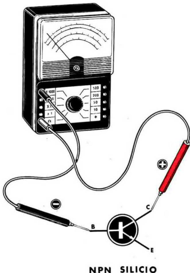
Fig. 15 Con il tester potrete anche individuare con facilità se il transistor in esame è un tipo al germanio o silicio. Noterete infatti dalle prove che effettuerete che i transistors al germanio rispettando la polarità del puntale collegato alla base (positivo se PNP) ci indicherà sempre un valore ohmico che si aggira dai 0,5 a 1 megaohm.
