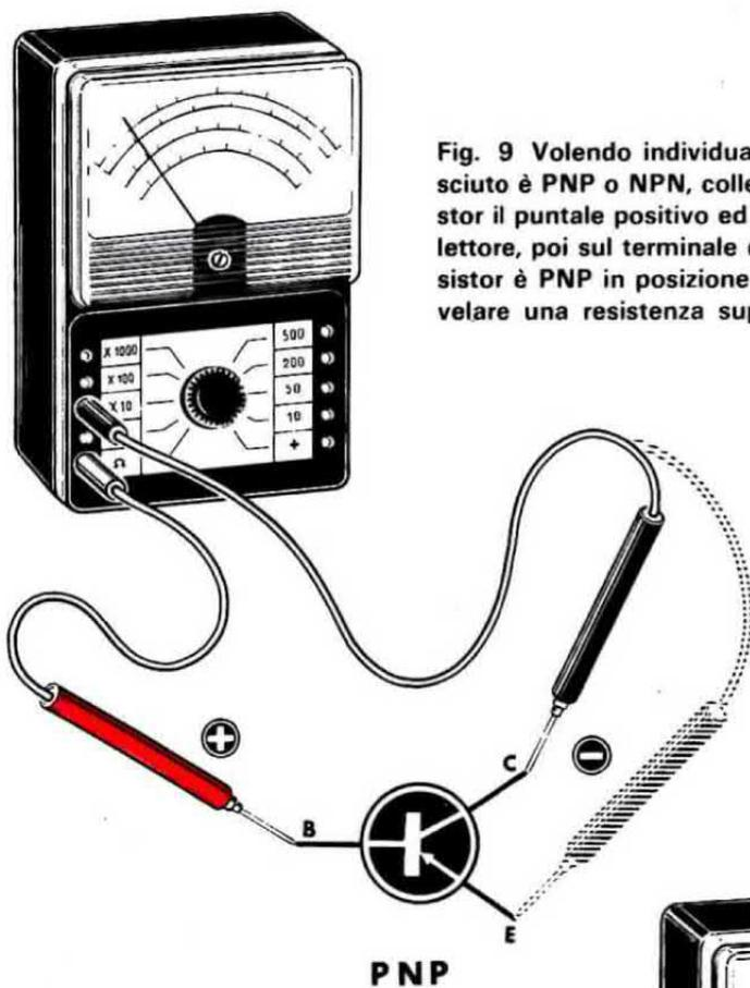
Fig. 9 Volendo individuare se il transistor sconosciuto è PNP o NPN, collegate alla base del transistor il puntale positivo ed il negativo prima sul collettore, poi sul terminale dell'emettitore. Se il transistor è PNP in posizione OHM - X10 dovremo rivelare una resistenza superiore ai 200.000 ohm.
