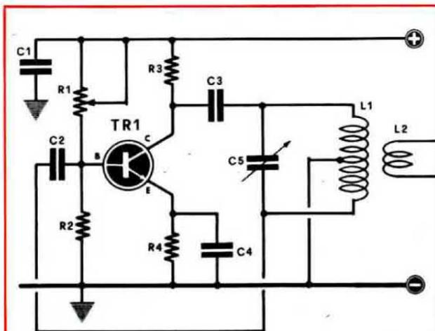
Fig. 4 oscillatore VFO tipo HARTLEY
