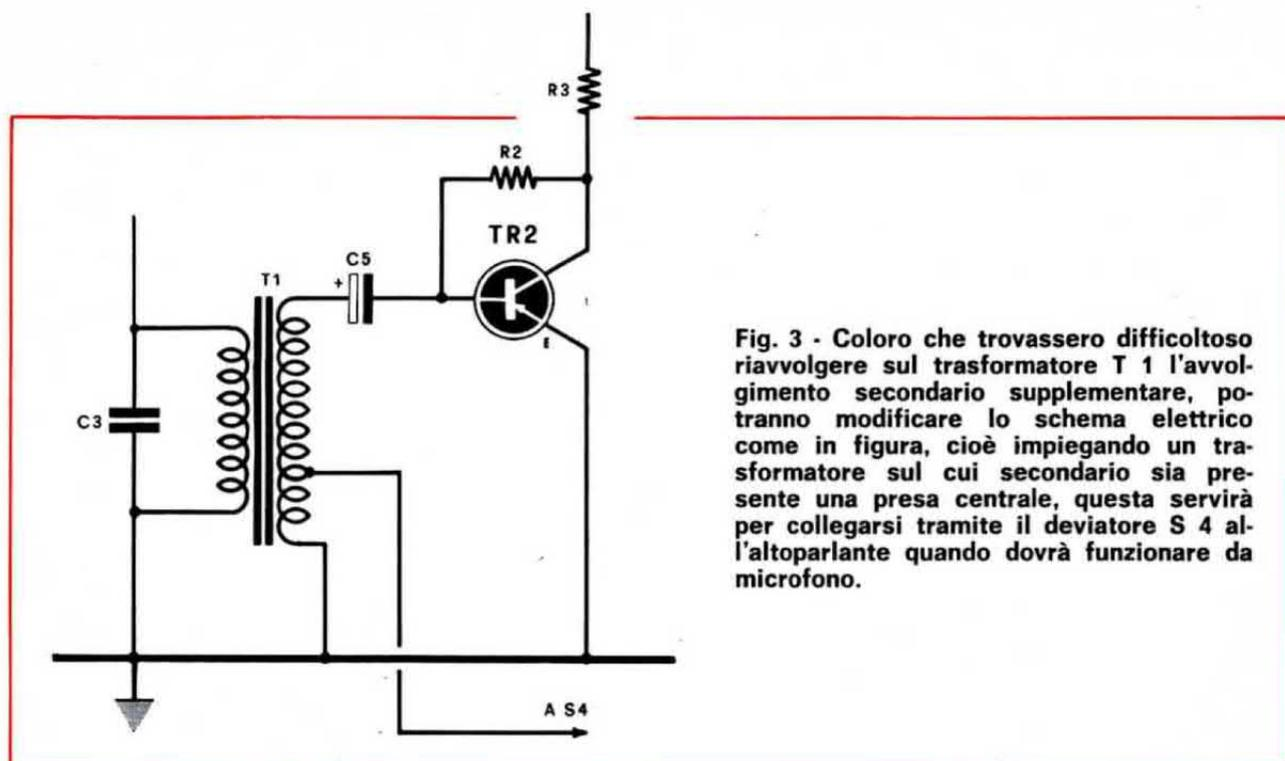
Fig. 3 - Coloro che trovassero difficoltoso riavvolgere sul trasformatore T 1 l'avvolgimento secondario supplementare, potranno modificare lo schema elettrico come in figura, cioè impiegando un trasformatore sul cui secondario sia presente una presa centrale, questa servirà per collegarsi tramite il deviatore S 4 all'altoparlante quando dovrà funzionare da microfono.
