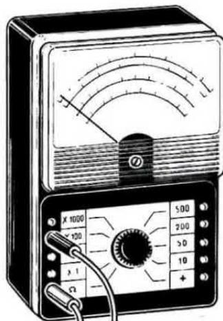
**Fig. 4** Sarà utile effettuare con i diodi anche la controprova, cioè invertire i puntali in modo da controllare se la lancetta rimanga sullo zero. Se notassimo che anche in tale condizione la lancetta si portasse a fondo scala potremo dedurre che il diodo è in cortocircuito, mentre se in nessuna delle due posizioni avessimo un'indicazione è evidente che il diodo è interrotto.
