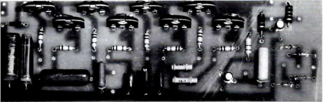
andrete ad inserirli nel circuito stampato perché se essi risulterassero collegati in maniera inversa a quanto richiesto dal circuito lo strumento ovviamente non potrà funzionare.
