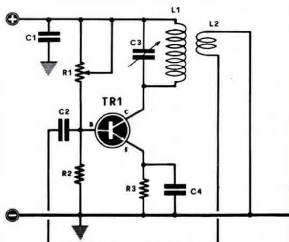
Fig. 3 oscillatore VFO con accordo di COLLETORE
