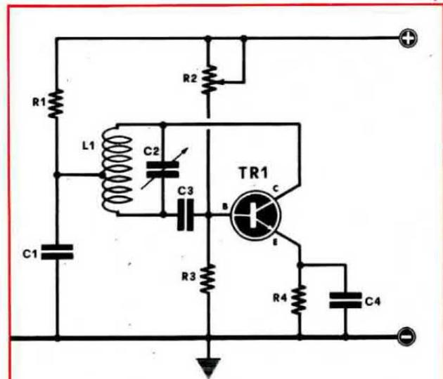
Fig. 5 oscillatore VFO tipo HARTLEY
