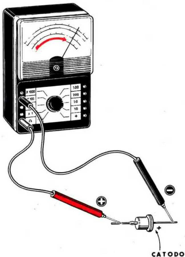
Fig. 1 Per poter usare qualsiasi tester per la prova dei transistor, occorre individuare quale dei due puntali è collegato internamente al positivo della pila. In possesso di un diodo cui si conosca il terminale POSITIVO, collegatelo ai due puntali del tester. Se la lancetta rimane immobile, avremo collegato il puntale positivo al terminale positivo del diodo.
