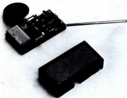
**Un economico ricetrasmittitore che un nostro collaboratore ha realizzato con ottimi risultati. La portata di questo apparecchio completamente transistorizzato si aggira sui 2 chilometri.**
