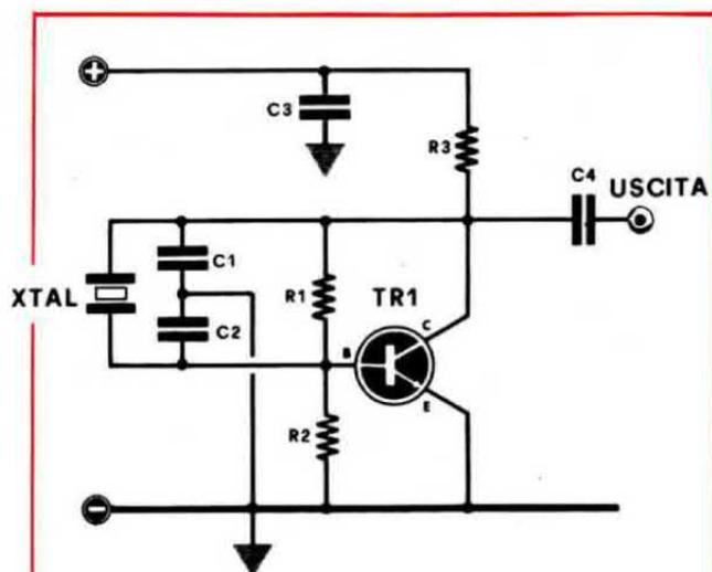
Fig. 10 oscillatore a quarzo tipo COLPITTS
