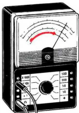
**Fig. 3** Conoscendo quale polarità è presente sui puntali nella portata ohmica del vostro tester sarete in grado anche di individuare il CATODO e l'ANODO di qualsiasi diodo sconosciuto. Se ad esempio la lancetta dello strumento, in posizione X100, andrà a fondo scala il CATODO del diodo è quello rivolto verso il puntale negativo.
