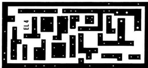
Fig. 2 Disegno del circuito stampato del radiomicrofono EL 4 a grandezza naturale. Considerata la difficoltà di realizzazione, abbiamo ritenuto farvi cosa gradita facendolo preparare da una industria specializzata.
