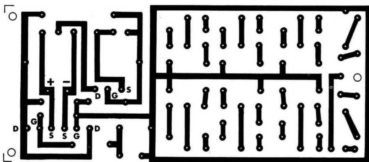
Fig. 3 Dimensione a grandezza naturale del circuito stampato per il wattmetro di AF. Il circuito stampato potrà essere richiesto alla nostra redazione a L. 650 + spese postali.
