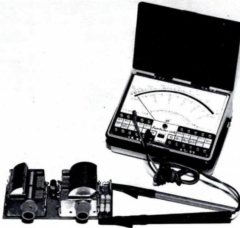
Fig. 4 Per poter adattare l'impedenza d'uscita del nostro trasmettitore della impedenza caratteristica di 75 ohm applicheremo ai capi di C9 due resistenze di 150 ohm 1 watt in parallelo (si ottiene così un valore ohmico di 75 ohm) un qualsiasi diodo al germanio (OA81-OA85-OA79 - ecc.) più un condensatore da 47.000 pF. L'accordo risulterà perfetto quando saremo riusciti, ruotando C8 e C9 ad ottenere in uscita la massima tensione.
