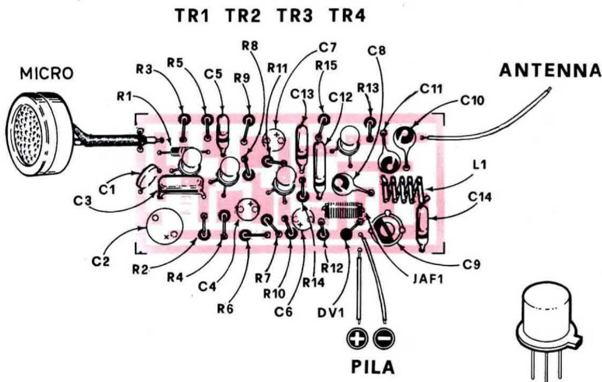
Fig. 3 I componenti relativi allo schema del radiomicrofono EL 4 andranno disposti sulla basetta del circuito stampato come vedesi in disegno. Ci raccomandiamo di rispettare la polarità dei condensatori elettrolitici C2-C4-C6-C7, e di controllare la disposizione dei terminali E-B-C dei transistor, non essendo stato possibile riportare tale indicazione sul circuito stampato.
