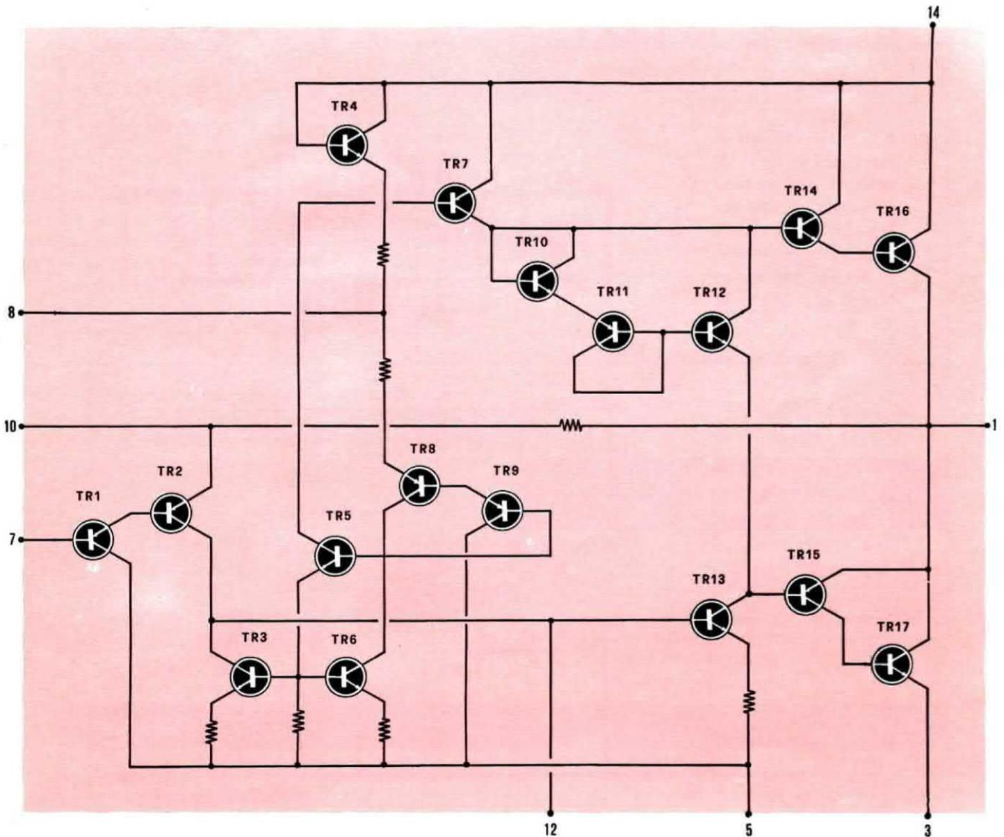
**Fig. 1** Nell'interno dell'integrato TAA.621 sono inclusi come vedesi in disegno ben 17 transistor. Il circuito è sostanzialmente composto da uno stadio preamplificatore, da uno stadio pilota e da uno stadio finale in classe AB quasi complementare in grado di fornire in funzione della tensione di alimentazione e dalla resistenza dell'altoparlante una potenza variabile da 1,4 a 4 Watt.
