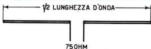
Fig. 1. Ogni antenna dispone di una impedenza caratteristica. Ad esempio un dipolo orizzontale installato ad una certa altezza dal suolo, presenta ai suoi capi una impedenza di 75 ohm.
