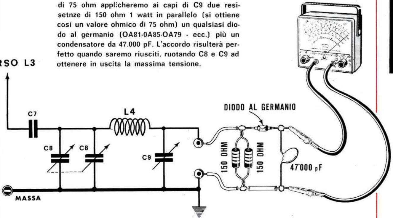
Se possedete un voltmetro elettronico, usatelo al posto del tester, perché quest'ultimo vi indicherà una tensione inferiore a quella realmente esistente. Comunque anche se il tester non ci permetterà di conoscere esattamente la tensione di uscita, ci indicherà sempre con assoluta precisione la posizione esatta di accordo di C8 e di C9.
