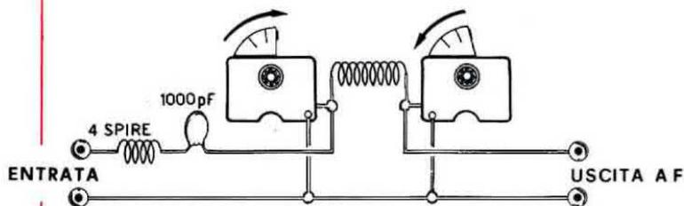
Fig. 15. Inserendo prima del condensatore d'accoppiamento una bobina composta da 3-4 spire, si noterà che per accordare il filtro a pi-greco, sarà necessario ridurre la capacità del condensatore variabile d'entrata ed aumentare quello di uscita.
