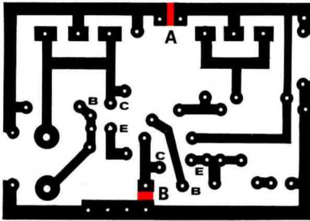
Fig. 2 Disegno a grandezza naturale del circuito stampato che dovrete riprodurre per realizzare questo trasmettitore. Facciamo presente ai lettori che le due sezioni cui sono composti i condensatori variabili C2 e C6 risultano collegate in parallelo per aumentarne la capacità totale. Le piste, nei punti indicati con le lettere A-B, dopo aver eseguito il controllo di assorbimento andranno cortocircuitate (vedi segno rosso).
