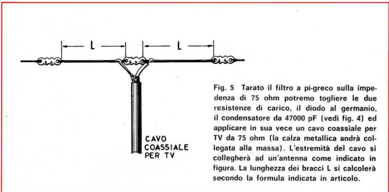
Fig. 5 Tarato il filtro a pi-greco sulla impedenza di 75 ohm potremo togliere le due resistenze di carico, il diodo al germanio, il condensatore da 47000 pF (vedi fig. 4) ed applicare in sua vece un cavo coassiale per TV da 75 ohm (la calza metallica andrà collegata alla massa). L'estremità del cavo si collegherà ad un'antenna come indicato in figura. La lunghezza dei bracci L si calcolerà secondo la formula indicata in articolo.
