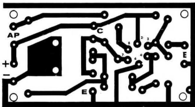
Fig. 4. Circuito stampato a grandezza naturale per realizzare un amplificatore da 3 Watt, impiegando come finali gli AC187/AC188K. Tale circuito non essendo reperibile occorrerà autoprepararlo ricopiando fedelmente questo disegno.
