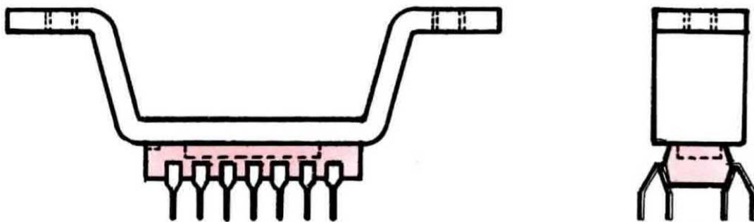
Fig. 2 Il TAA.621 è racchiuso in un contenitore in plastica provvisto di un dissipatore metallico esterno come vedesi in figura, per agevolare il suo raffreddamento.
