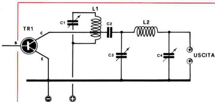
**Fig. 9A.** Per distinguere i due condensatori C3 e C4 chiameremo **CONDENSATORE D'ENTRATA C3** e **CONDENSATORE D'USCITA C4** cioè quello che si collegherà in seguito alla sonda di carico o all'antenna irradiante.
