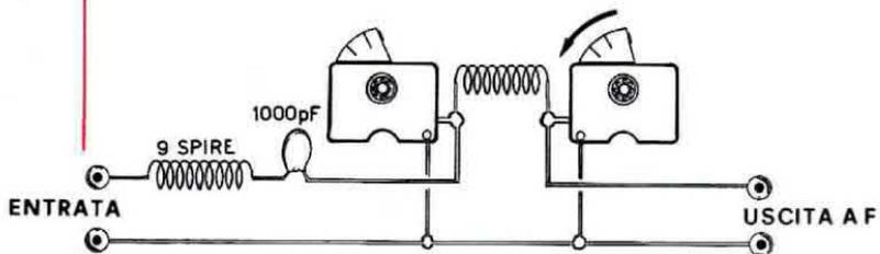
Fig. 16. Aumentando il numero delle spire di questa bobina da 4 a 9 sarà necessario aumentare ancor di più la capacità del condensatore d'uscita. Con l'aiuto di una sonda di carico o con un wattmetro si stabilirà quali delle tre soluzioni indicate ci permetterà di ottenere in uscita la massima tensione A.F.
