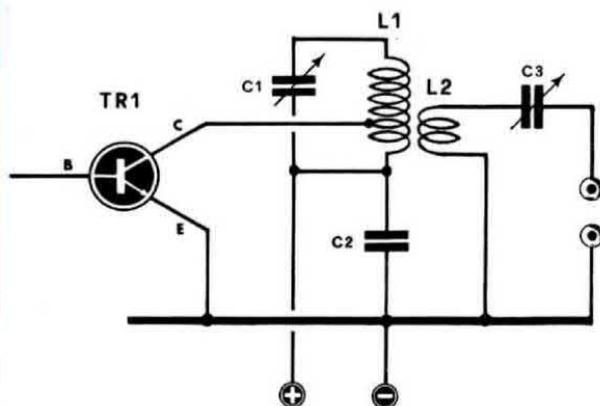
Fig. 8. Applicando in serie alla bobina del link un condensatore variabile (C3) noi possiamo adattare con maggior precisione l'impedenza d'uscita del trasmettitore modificando soltanto la capacità del variabile C3. La bobina L2 dovrà disporre rispetto al caso precedente di un maggior numero di spire.
