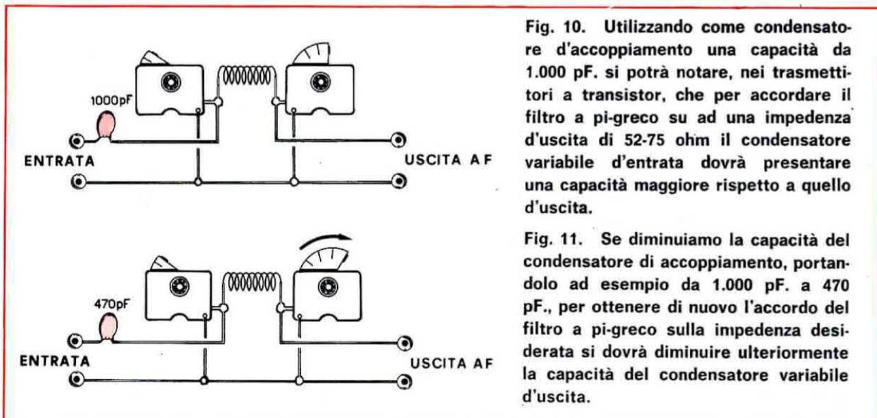
Fig. 10. Utilizzando come condensatore d'accoppiamento una capacità da 1.000 pF. si potrà notare, nei trasmettitori a transistor, che per accordare il filtro a pi-greco su ad una impedenza d'uscita di 52-75 ohm il condensatore variabile d'entrata dovrà presentare una capacità maggiore rispetto a quello d'uscita.
