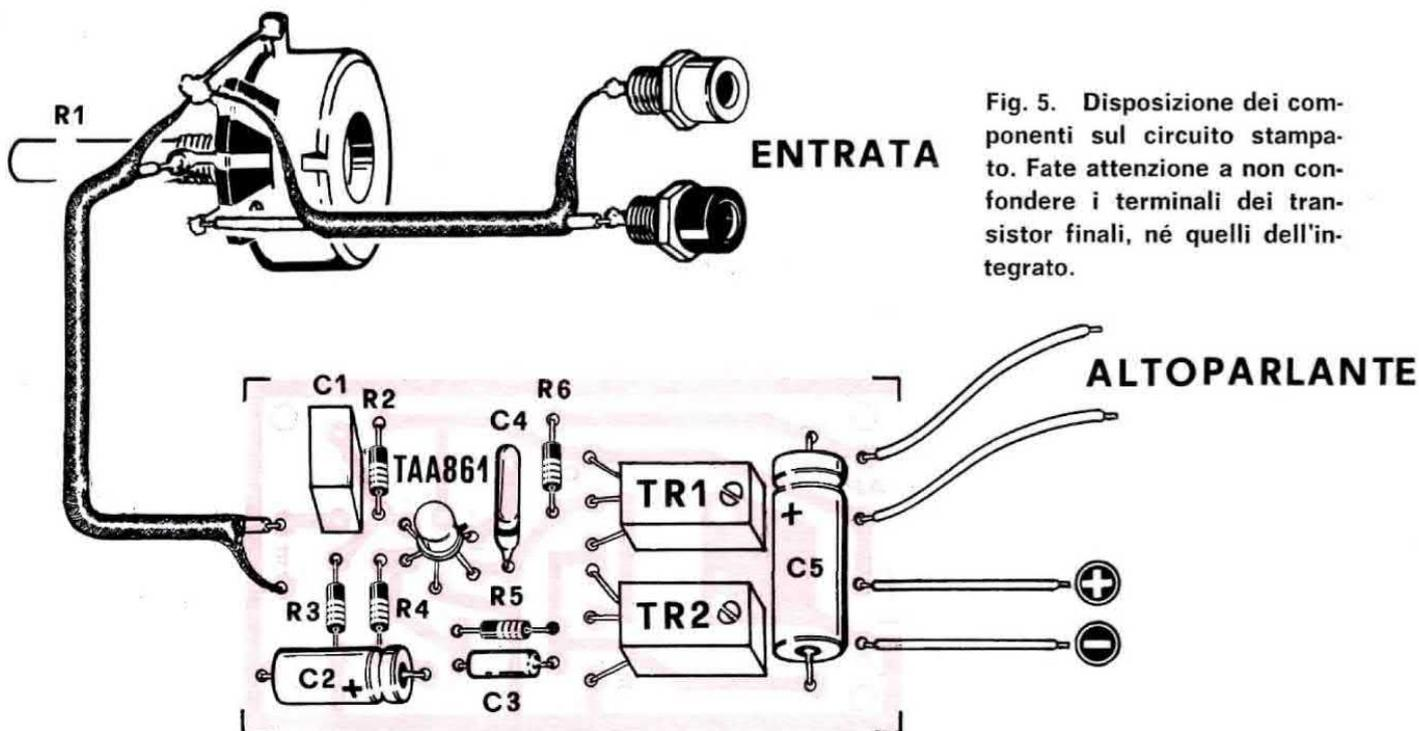
Fig. 5. Disposizione dei componenti sul circuito stampato. Fate attenzione a non confondere i terminali dei transistor finali, né quelli dell'integrato.
