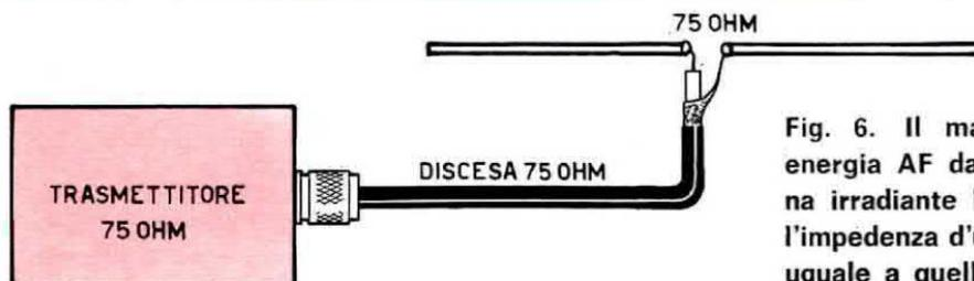
**Fig. 6.** Il massimo trasferimento di energia AF dal trasmettitore all'antenna irradiante lo si ottiene soltanto se l'impedenza d'uscita del trasmettitore è uguale a quella del cavo di discesa, e quella del cavo di discesa a quella dell'antenna. Se uno di questi tre elementi ha valore diverso si hanno perdite che possono raggiungere anche il 99%.
