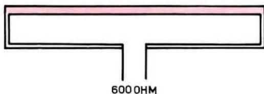
Fig. 3. Se si impiegasse per il filo superiore un diametro maggiore rispetto a quello inferiore, si constatarebbe che l'impedenza caratteristica di tale antenna dai 300 ohm iniziali passerebbe ad un valore più elevato, esattamente sui 600 ohm.
