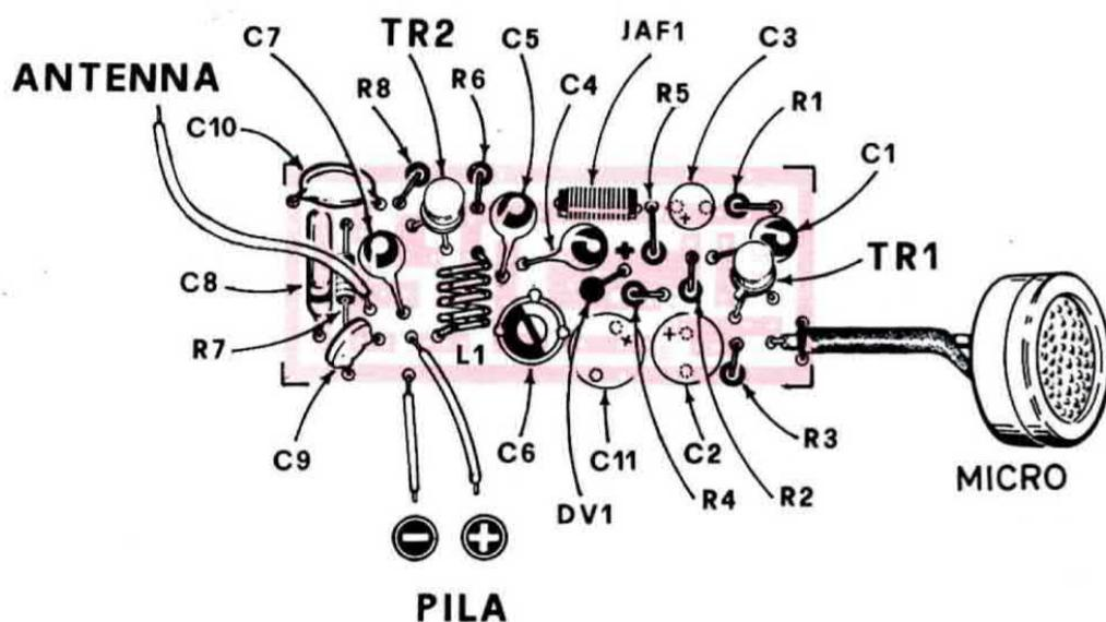
Fig. 3 Disposizione dei componenti del radiomicrofono EL 2 sulla bauletta del circuito stampato. Consigliamo i lettori a prestare attenzione alla polarità dei condensatori elettrolitici C2-C3-C11 (nel disegno è chiaramente visibile da quale lato va collegato il terminale positivo) e ai terminali E-B-C dei due transistor. Se impiegate per il microfono un cavetto schermato ricordatevi di collegare la calza metallica alla pista di massa del circuito stampato.
