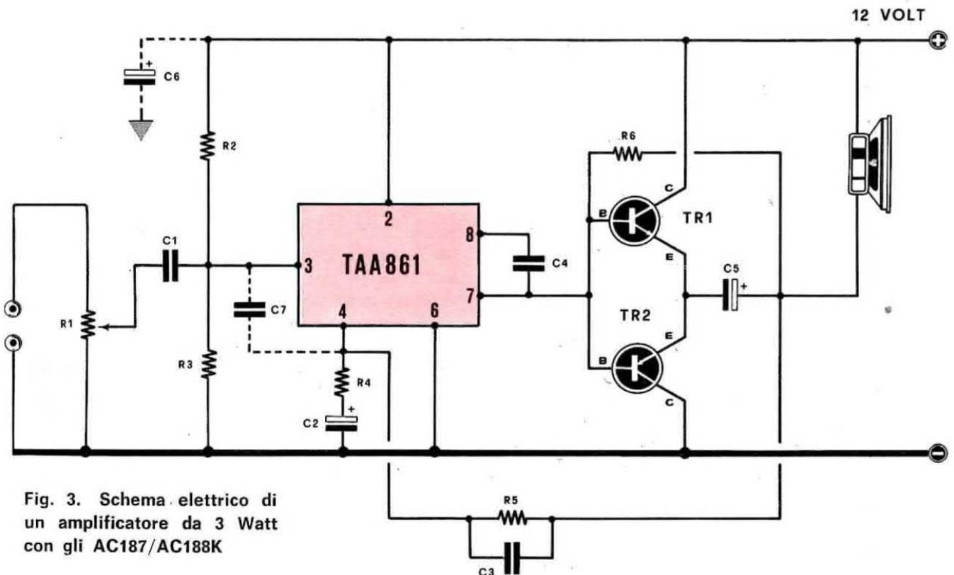
Fig. 3. Schema elettrico di un amplificatore da 3 Watt con gli AC187/AC188K
