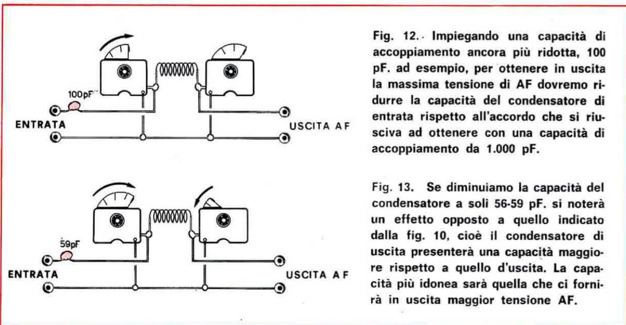
Fig. 12. Impiegando una capacità di accoppiamento ancora più ridotta, 100 pF. ad esempio, per ottenere in uscita la massima tensione di AF dovremo ridurre la capacità del condensatore di entrata rispetto all'accordo che si riusciva ad ottenere con una capacità di accoppiamento da 1.000 pF.
