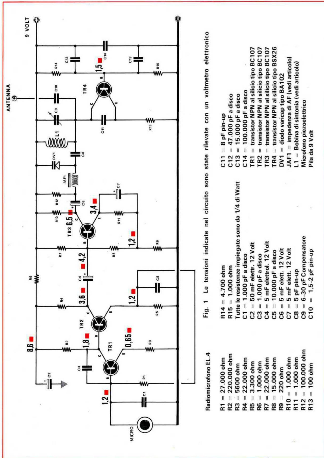
Fig. 1 Le tensioni indicate nel circuito sono state rilevate con un voltmetro elettronico
