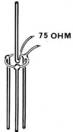
**Fig. 5B.** Ponendo i bracci orizzontali in posizione verticale, inclinandoli verso al basso l'impedenza della ground-plane assumerebbe un valore di 75 ohm.
