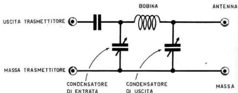
**Fig. 9.** L'adattatore d'impedenza più perfetto è senza dubbio quello conosciuto con il nome di filtro a pi-greco costituito come vedesi in figura da un condensatore di accoppiamento (C2) da una bobina L2 e da due condensatori variabili C3-C4 posti ai capi di L2.
