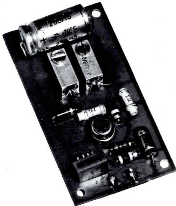
**IN ALTO** come si presenta l'amplificatore descritto in articolo già montato sulla basetta del circuito stampato.
