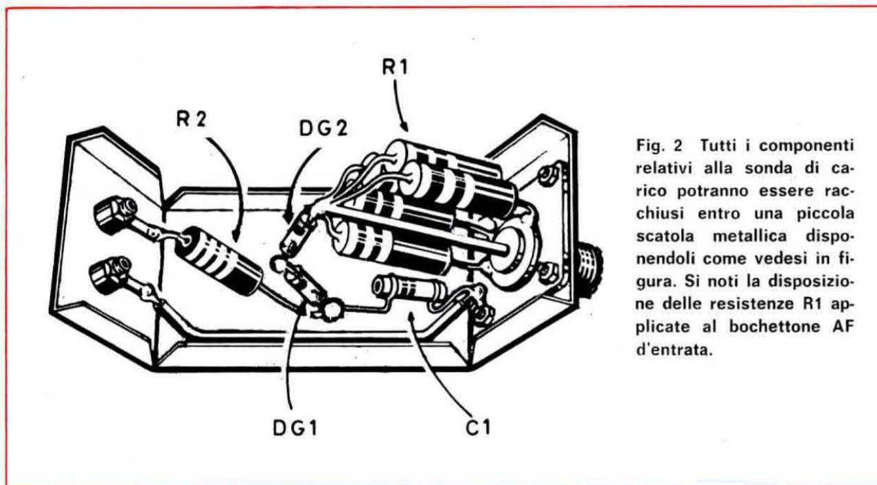
Fig. 2 Tutti i componenti relativi alla sonda di carico potranno essere racchiusi entro una piccola scatola metallica disponendoli come vedesi in figura. Si noti la disposizione delle resistenze R1 applicate al bochettone AF d'entrata.
