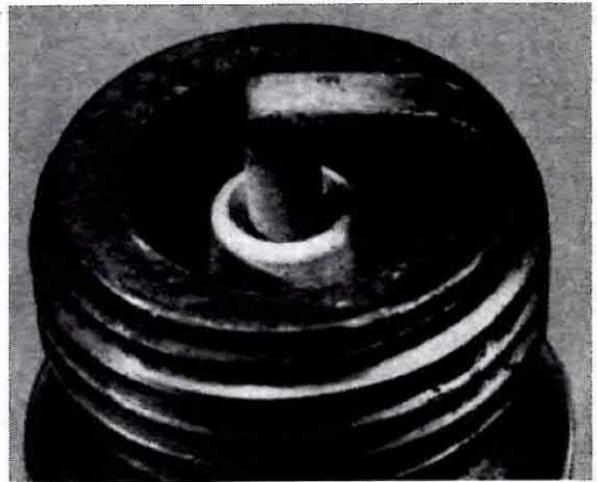
**Con una scintilla più potente anche nei motori dove le candele tendono facilmente a sporcarsi per infiltrazioni di olio lubrificante, questo non accadrà più, riuscendo la scintilla a bruciare anche tutti quei residui oleosi che eventualmente si depositassero sugli elettrodi.**
