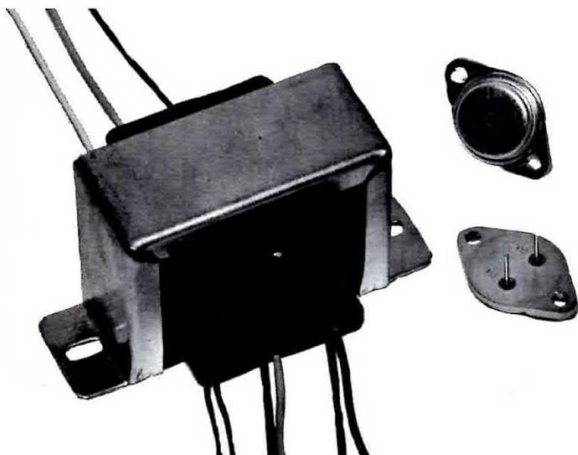
**Il componente più critico di una accensione a scarica capacitiva, è il trasformatore elevatore di tensione. Per questo trasformatore occorre impiegare lamierini di ottima qualità (lamierini al silicio a granuli orientati) oppure nuclei ferrosilicio, inoltre gli avvolgimenti del primario debbono essere eseguiti con filo bifilare per non sbilanciare le due sezioni dell'oscillatore. Nella foto il trasformatore che noi ci siamo fatti avvolgere per le nostre accensioni.**
