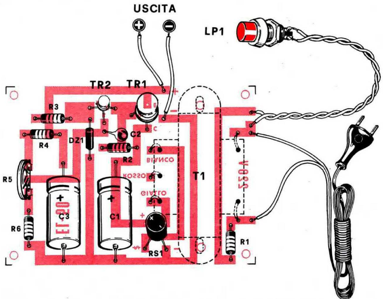
struirsi un alimentatore per laboratorio, utile per la riparazione degli apparecchi transistorizzati.
