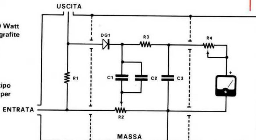
bilire il valore dell'impedenza caratteristica di un'antenna alle varie frequenze.
