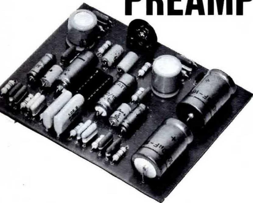
**Utilizzando l'integrato CA.3052 oppure CA.3048 della RCA, noi abbiamo realizzato un ottimo preamplificatore stereo, che potrà essere impiegato per pilotare qualsiasi stadio finale, anche con potenze da 50 e più watt.**
