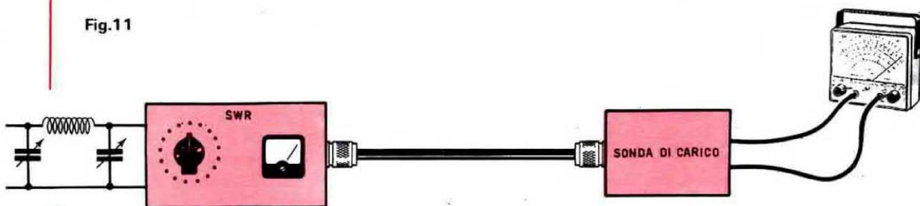
Se all'uscita del misuratore SWR, collegherete un cavo coassiale di qualsiasi lunghezza, che risulti d'impedenza analoga a quella d'uscita del trasmettitore, e all'estremità di questa applicherete la sonda di carico utilizzata per tarare l'uscita del trasmettitore, constaterete che effettuando le operazioni indicate in figg. la lancetta dello strumento raggiungerà lo ZERO indicandoci così che esiste un perfetto adattamento d'impedenza.
