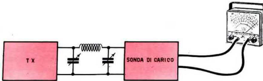
**Per tarare un'antenna occorrerà prima di ogni altra operazione accordare perfettamente il filtro a pi-greco posto sull'uscita del trasmettitore, in modo da ottenere con la sonda di carico da 52 o 75 ohm la massima tensione in uscita che leggeremo sul tester (vedi n. 12 di Nuova Elettronica).**
