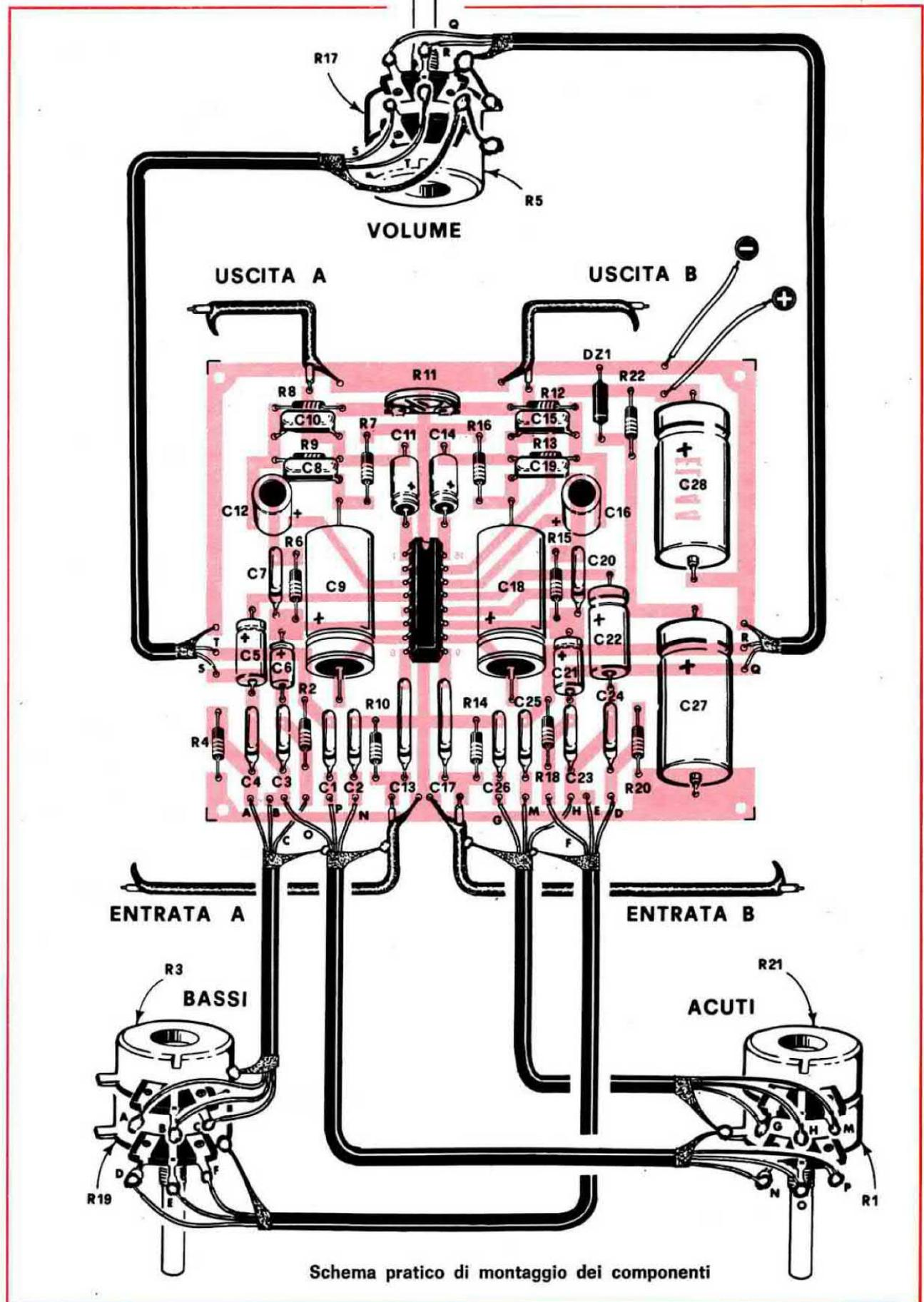
volume, oppure, cortocircuitate il cavetto delle due entrate A e B; se in questo caso il ronzio sparisce, è ovvio che non avete provveduto a schermare perfettamente il preamplificatore o le entrate.
