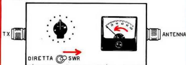
Senza più toccare la manopola del potenziometro, si ruoterà il deviatore nella posizione SWR (onda riflessa). Se il carico presenta una impedenza analoga a quella d'uscita del trasmettitore, la lancetta dello strumento scenderà fino a fermarsi sullo ZERO. E' ovvio che durante queste prove occorre sempre collegare sull'uscita del misuratore di SWR un carico, costituito da un'antenna o sonda di carico.
