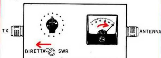
Si ruoterà ora il deviatore sulla posizione ONDA DIRETTA, e si regolerà la manopola del potenziometro fino a far coincidere la lancetta dello strumento al fondo scala. Se la lancetta non raggiungesse il fondo scala, è evidente che la potenza del vostro TX è irrisoria, occorrerà in questi casi sostituire lo strumento con uno più sensibile da 50 microamper.
