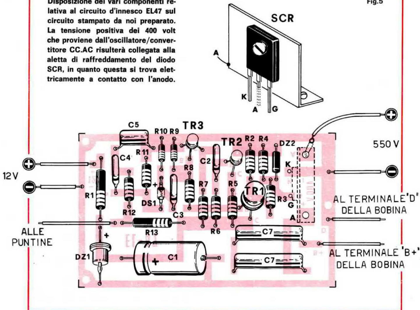
Terminata la sezione convertitrice CC/AC, potremo passare ora, a realizzare il circuito d'innesco.
