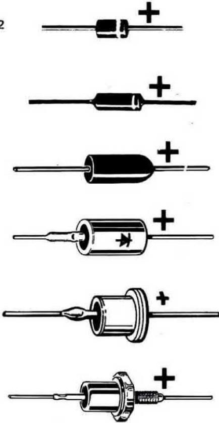
Per la realizzazione dell'accensione EL45 è possibile impiegare qualsiasi tipo di diodo al silicio che abbia le caratteristiche richieste dallo schema. Per agevolare il lettore presentiamo in questo disegno le forme più comuni indicandone il terminale positivo.
