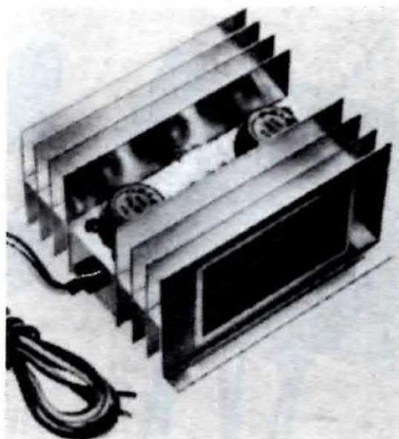
che, se mal disposte, possono provocare dannosi cortocircuiti tali da metter fuori uso i semiconduttori e mandare a massa l'impianto elettrico della vostra vettura bloccandola inspiegabilmente. I due semiconduttori possono essere collocati oltretutto direttamente sul contenitore metallico dell'apparecchio e disporre quindi di un abbondante spazio per il radiatore del transistor. I dati di costruzione del trasformatore sono questi:
