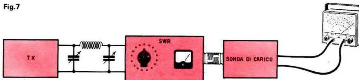
Tarata l'uscita del trasmettitore sull'impedenza voluta (52 o 75 ohm) potremo inserire, come vedesi in figura, il misuratore di SWR e in uscita di questo la sonda di carico.
