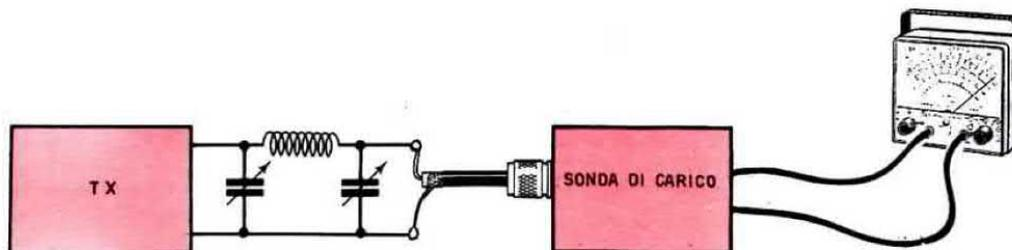
**La sonda di carico va collegata direttamente sul filtro a pi-greco. Non utilizzate quindi spezzoni di cavo coassiale anche se di lunghezza minima, perché questo potrebbe sfalsarci la lettura.**
