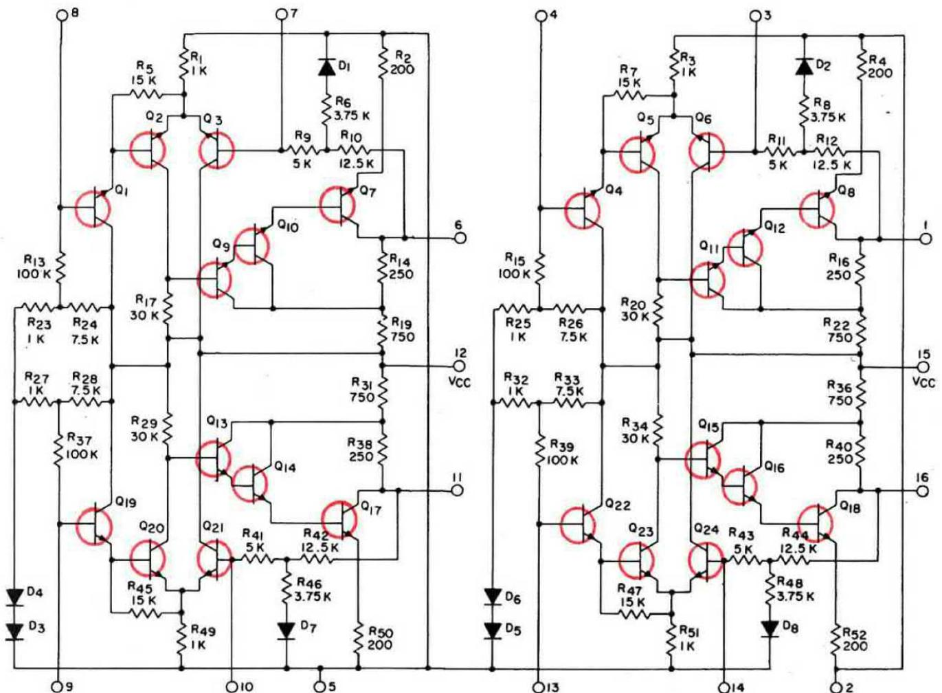
**Fig. 1** Nell'interno del circuito integrato CA.3052 o CA3048 come vedesi nello schema originale inviatoci dalla RCA, sono inclusi ben 24 transistor 8 diodi e 52 resistenze. Tale integrato è quanto di meglio si possa attualmente disporre per realizzare un ottimo preamplificatore stereo riuscendo con i suoi 2 volt di uscita a pilotare stadi finali anche di elevata potenza.
