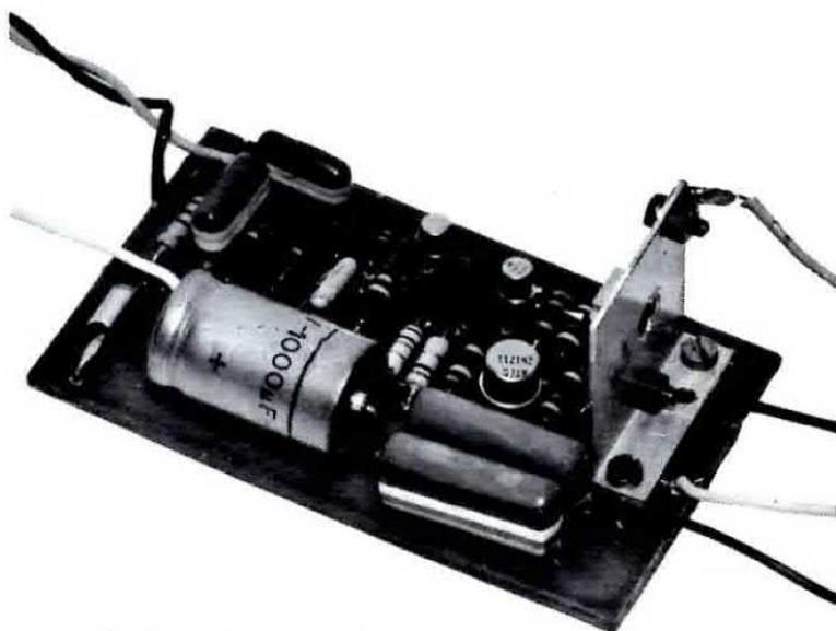
Nella foto, il circuito d'innesco EL47 completo di tutti i suoi componenti. Si noti l'aletta di raffreddamento impiegata per il diodo SCR.
