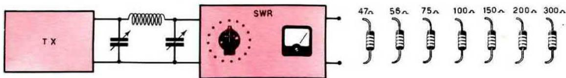
Se applicherete sull'uscita del misuratore di SWR delle resistenze a carbone (cioè non induttive) di valore diverso e proverete ad effettuare le stesse operazioni indicate in figg. constaterete che soltanto quando la resistenza di carico ha un valore ohmmico identico all'impedenza d'uscita del trasmettitore, in posizione SWR la lancetta dello strumento raggiungerà lo ZERO, diversamente la lancetta si fermerà in una posizione superiore, denotando così un disadattamento d'impedenza.
