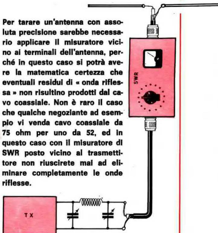
sto funzionerà immediatamente. Se disponete già di un trasmettitore al quale abbiate già tarato lo stadio finale ed accordato l'uscita tramite il filtro « pi-greco » con l'aiuto anche della sonda di carico presentata sui numeri precedenti sull'impedenza voluta (52 o 75 ohm), potrete ora controllare come vi funziona il misuratore di onde stazionarie.
