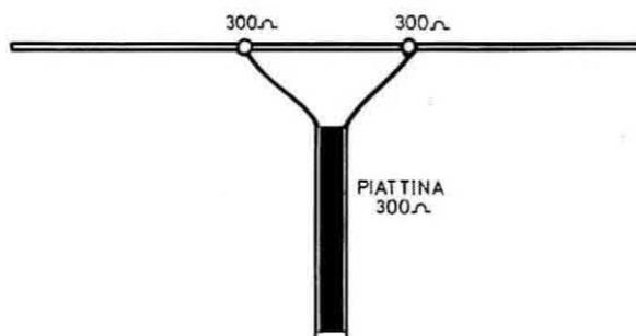
Avremo sempre in ogni caso un disadattamento d'impedenza che occorre assolutamente evitare.
