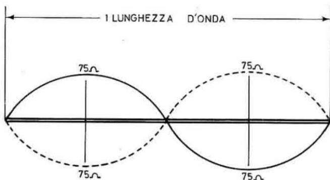
Fig. 1. Se noi prendiamo un filo lungo esattamente 20 metri, ed applichiamo a questo un segnale di AF della lunghezza d'onda di 20 metri, sul filo si formeranno due onde, una completa più una riflessa, perfettamente simmetriche, ma sfasate fra di loro.
