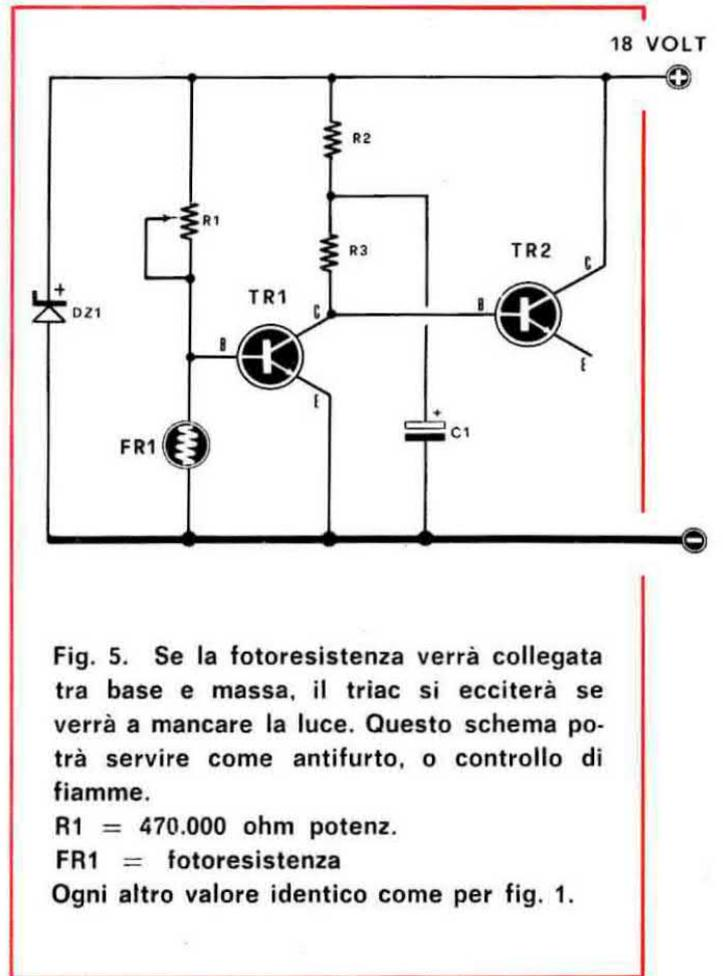
Fig. 5. Se la fotoresistenza verrà collegata tra base e massa, il triac si ecciterà se verrà a mancare la luce. Questo schema potrà servire come antifurto, o controllo di fiamme.
