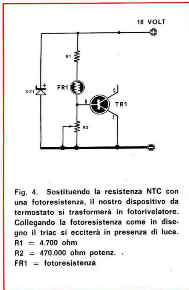
Volendo si potrebbe adottare un'altra soluzione, quella cioè di ridurre R1 a soli 1.000 ohm, utilizzare per R2 un potenziometro dello stesso valore, poi inserire in serie tra R1 e R2 un commutatore come vedesi in fig. 2 che inserisca valore opportunamente calcolate in base alle nostre necessità.
