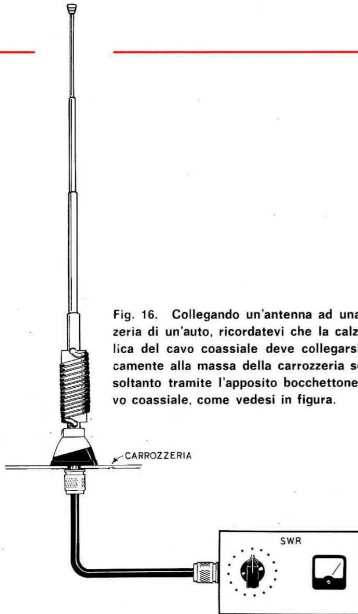
Fig. 16. Collegando un'antenna ad una carrozzeria di un'auto, ricordatevi che la calza metallica del cavo coassiale deve collegarsi elettricamente alla massa della carrozzeria sempre e soltanto tramite l'apposito bocchettone per cavo coassiale, come vedesi in figura.
