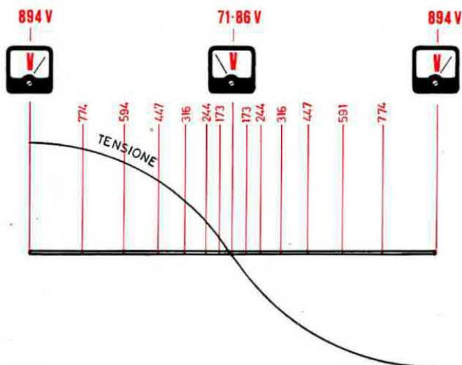
Fig. 6. Poiché la potenza in antenna non varia, ne consegue, per la nota legge di Ohm, che dove la corrente è minima la tensione risulterà massima e viceversa, come indicato in questo disegno.
