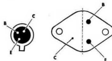
**A destra,** disposizione dei terminali EBC dei transistor impiegati.
