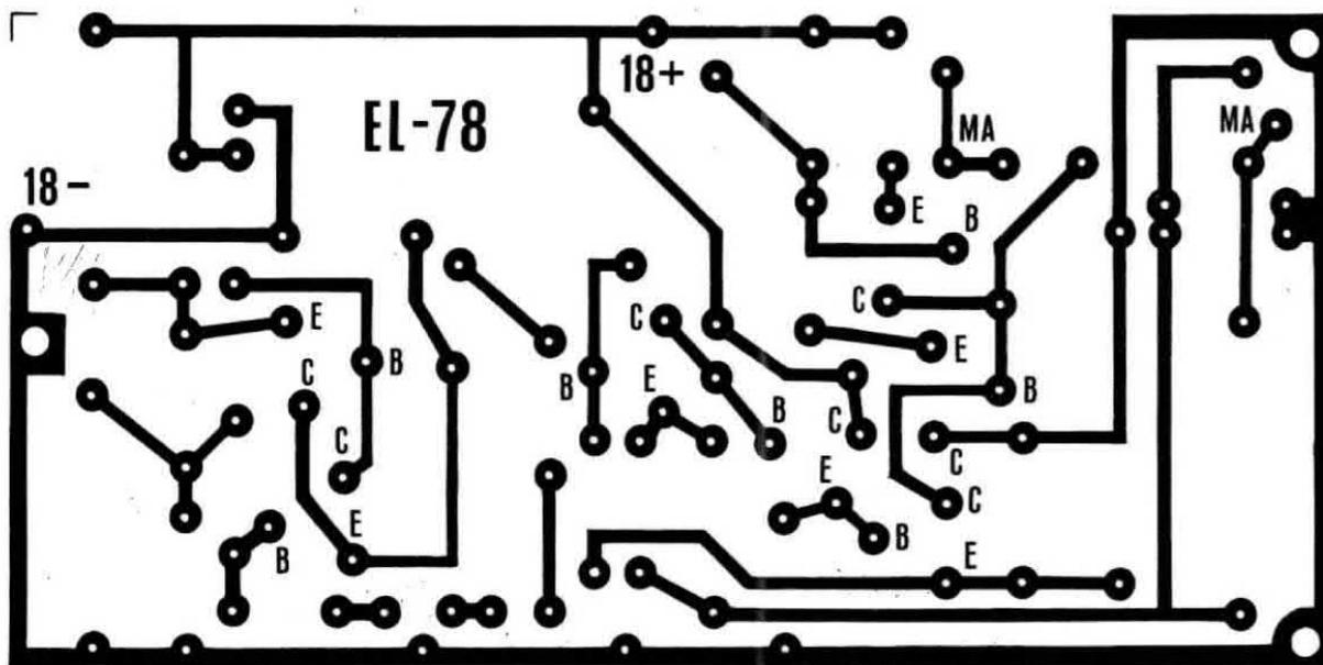
**Fig. 2 - Dimensioni a grandezza naturale del circuito stampato. I lettori che non avessero il tempo o la possibilità di copiarlo potranno richiederlo già inciso al prezzo di L. 850. Il circuito da noi inviato è inciso su materiale fiberglass (fibra di vetro).**
