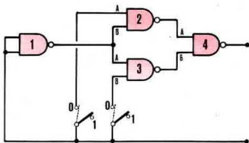
Fig. 2. Per ottenere una funzione OR è necessario impiegare 4 Nand collegati come vedesi in questo disegno. Facciamo presente al lettore che la condizione « 1 » si ottiene anche quando un terminale d'entrata risulta scollegato da massa.
