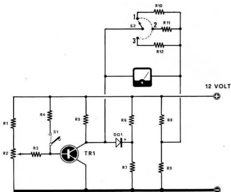
Per la portata 100 leggeremo direttamente il valore sulla scala; per la portata 500 dovremo semplicemente moltiplicare il valore x 5, per la portata 1.000 moltiplicheremo il valore x 10.
