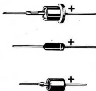
**Fig. 4.** I diodi zener possono presentarsi in forme diverse; per ognuno di questi indichiamo in disegno il terminale positivo.
