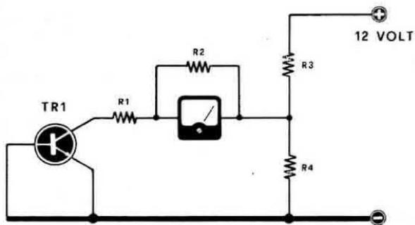
Fig. 3. Ruotando il commutatore S2 e S4 (vedi schema fig. 1) in posizione « cortocircuito » il transistor in prova si trova collegato come vedesi in disegno. In questa posizione lo strumento di misura, tramite la resistenza R2, viene ad assumere una portata di 10 milliamper fondo scala.
