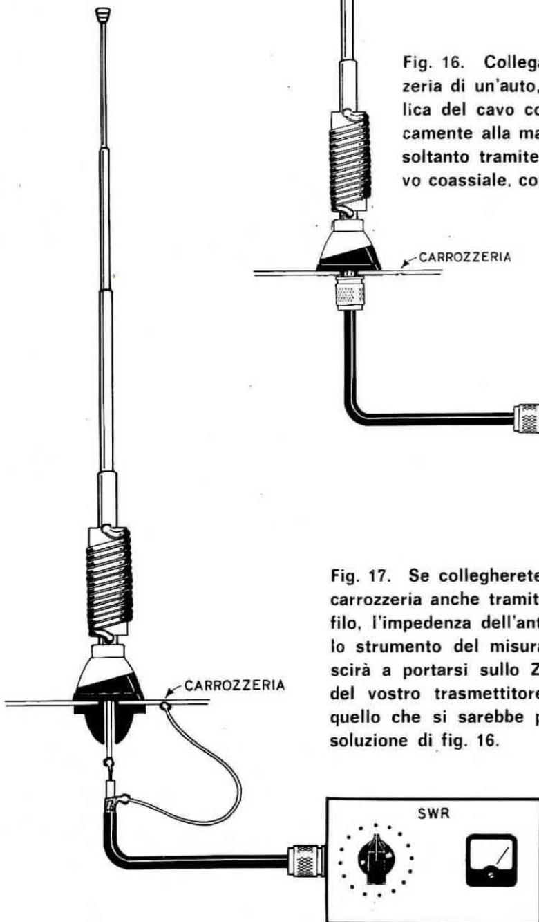
Fig. 17. Se collegherete la calza metallica alla carrozzeria anche tramite un corto spezzone di filo, l'impedenza dell'antenna varierà; pertanto lo strumento del misuratore di SWR non riuscirà a portarsi sullo ZERO ed il rendimento del vostro trasmettitore risulterà inferiore a quello che si sarebbe potuto ottenere con la soluzione di fig. 16.
