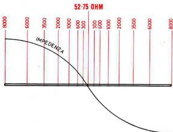
Fig. 7. Sempre utilizzando la legge di Ohm, potremo stabilire che al centro di un'antenna a  $\frac{1}{2}$  onda l'impedenza caratteristica si aggira sui 52.75 ohm, mentre agli estremi è di circa 8.000 ohm.
