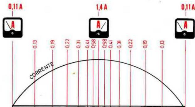
Fig. 5. In un'antenna a  $\frac{1}{2}$  lunghezza d'onda troveremo al centro il punto di massimo assorbimento di corrente, mentre agli estremi quello di minima. I valori riportati equivalgono ad un trasmettitore da 100 Watt.
