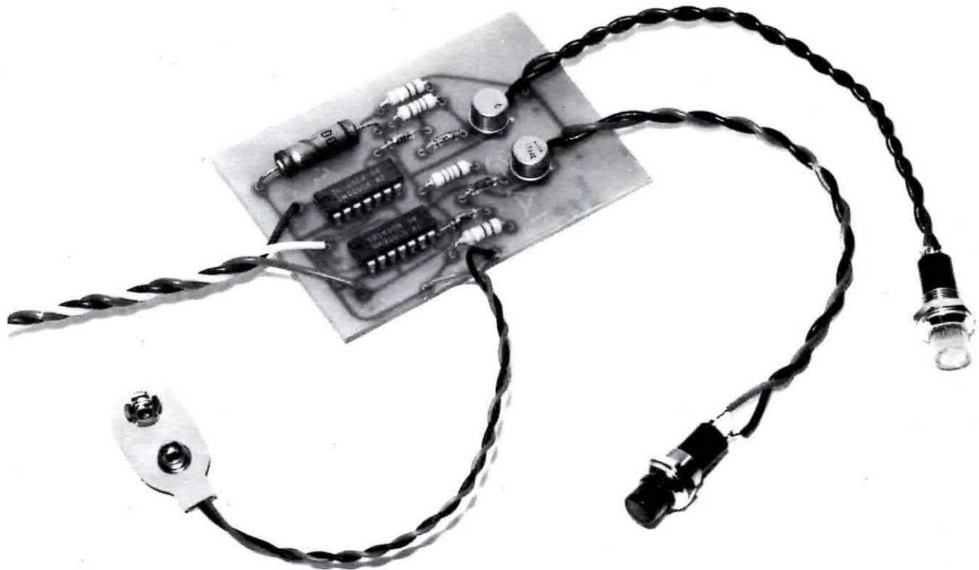
« logiche » del tipo NAND si possono modificare elettricamente per ottenere funzioni OR o AND.
