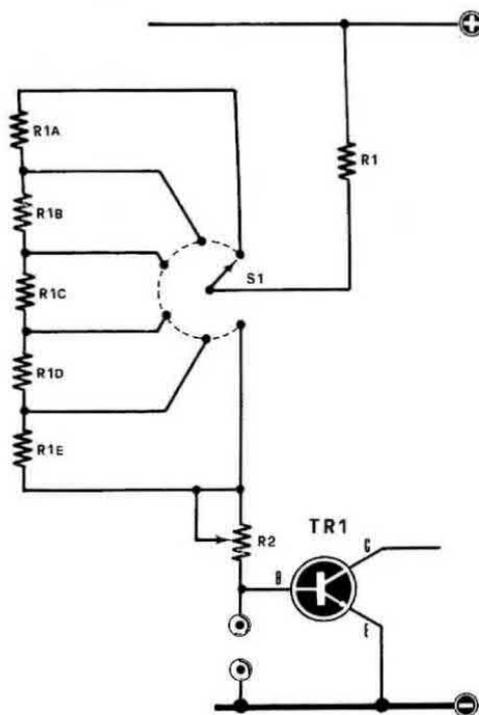
Fig. 2. Modificando lo schema originale come indicato in figura è possibile ottenere con la totale escursione del potenziometro R2 una regolazione limitata a pochi gradi centigradi. In questo caso il potenziometro R2 assumerà un valore di 1.000 o 4.700 ohm; R1 da 1.000 ohm e le resistenze posto sul commutatore da 4.700-5.600 ohm.
