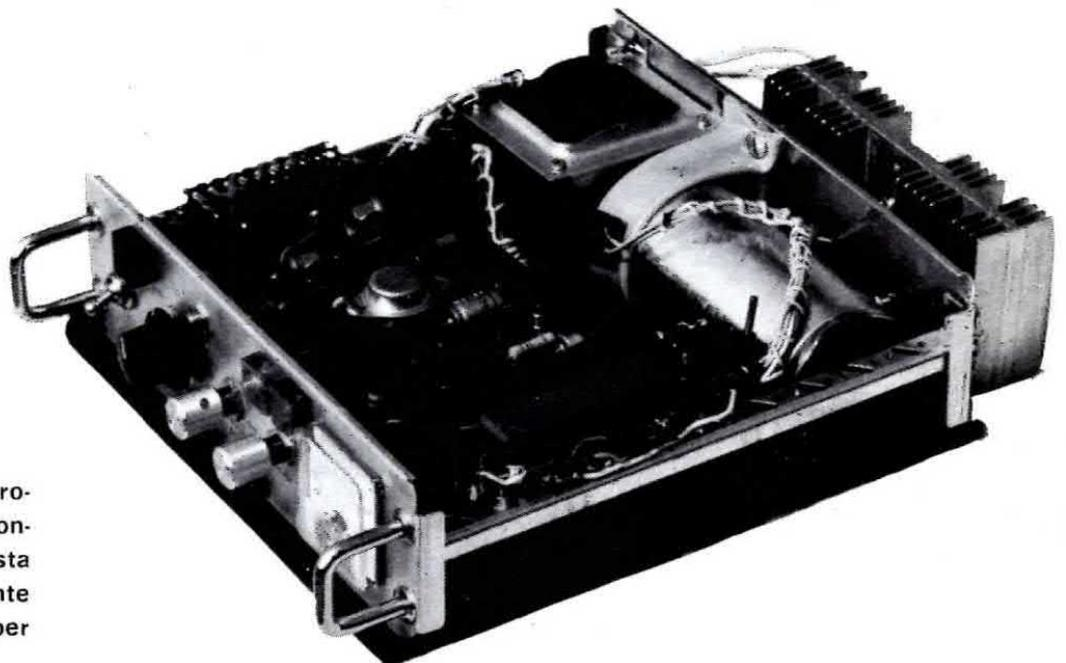
Fig. 1. L'autore di tale progetto ha realizzato il suo montaggio come vedesi in questa foto; si noti posteriormente l'aletta di raffreddamento per il transistor TR1.
