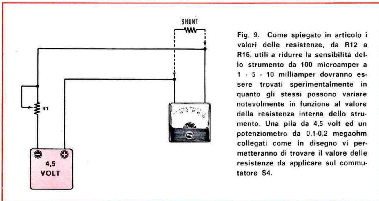
Fig. 9. Come spiegato in articolo i valori delle resistenze, da R12 a R16, utili a ridurre la sensibilità dello strumento da 100 microamper a 1 - 5 - 10 milliamper dovranno essere trovati sperimentalmente in quanto gli stessi possono variare notevolmente in funzione al valore della resistenza interna dello strumento. Una pila da 4,5 volt ed un potenziometro da 0,1-0,2 megaohm collegati come in disegno vi permetteranno di trovare il valore delle resistenze da applicare sul commutatore S4.
