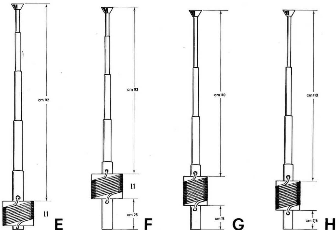
Fig. 15. Vi forniamo, in linea di massima, il numero di spire necessario ad una bobina di compensazione, in base alla lunghezza dello stilo impiegato e alla posizione nella quale questa verrà inserita. La lunghezza dell'antenna o il numero esatto delle spire della bobina di compensazione andranno poi ritoccati con l'aiuto del misuratore di onde stazionarie.
