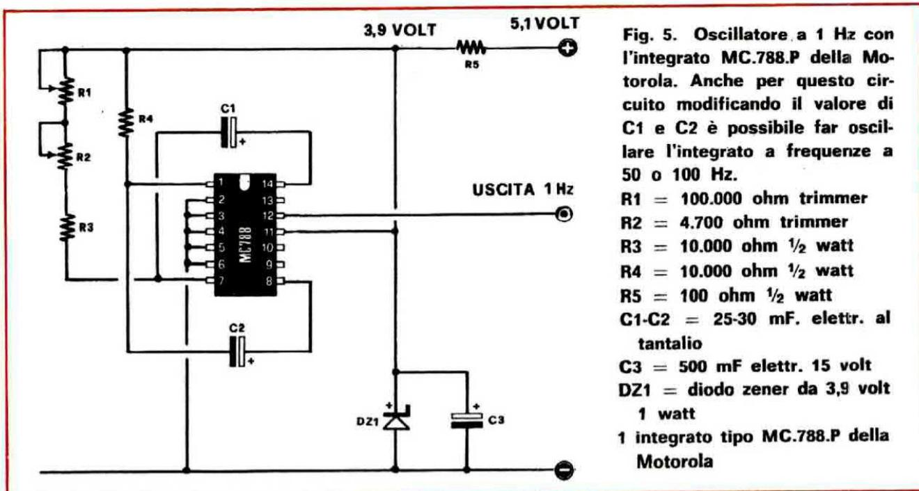
**Fig. 5.** Oscillatore a 1 Hz con l'integrato MC.788.P della Motorola. Anche per questo circuito modificando il valore di C1 e C2 è possibile far oscillare l'integrato a frequenze a 50 o 100 Hz.
