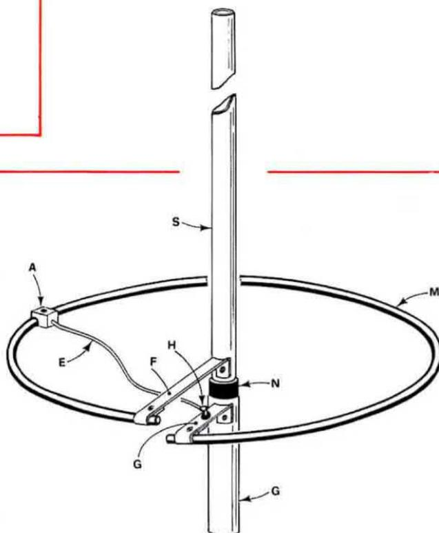
Fig. 2. Particolare dell'adattatore d'impedenza.
