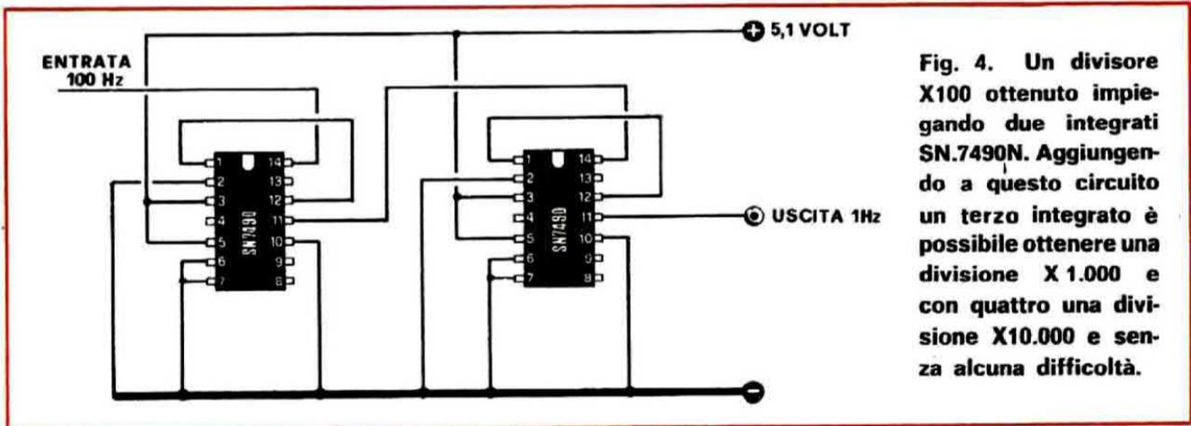
**Fig. 4.** Un divisore X100 ottenuto impiegando due integrati SN.7490N. Aggiungendo a questo circuito un terzo integrato è possibile ottenere una divisione X 1.000 e con quattro una divisione X10.000 e senza alcuna difficoltà.
