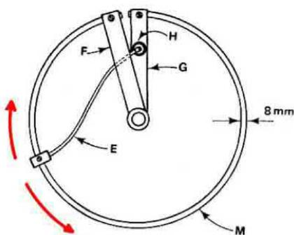
**Fig. 4. L'adattatore d'impedenza visto da sopra (cioè dal lato dello stilo verticale). Il filo E dovendo spostarsi in fase di taratura di circa 40 cm sul tubo M dovrà essere sagomato in modo che in qualsiasi posizione risulti fissato non venga mai in contatto con il tubo verticale. Una volta eliminate le onde stazionarie il filo E potrà essere fissato o saldato sul tubo M.**
