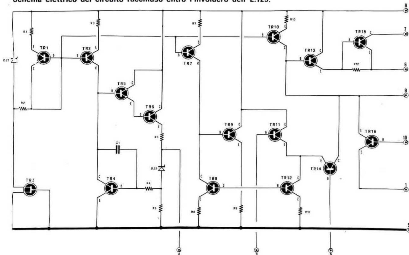
L'integrato, usato da solo, permetterebbe di controllare la tensione di uscita fra valori leggermente più ampi dei nostri ma avrebbe il non trascurabile limite di permettere il passaggio di un massimo di 150 mA soltanto.
