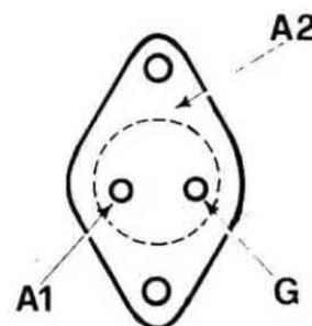
Disposizione dei terminali G-A1-A2 sull'involucro dei Triac da noi consigliato per questo montaggio. Il Triac necessario a questo montaggio dovrà risultare da 400 volt lavoro 6 amper.
