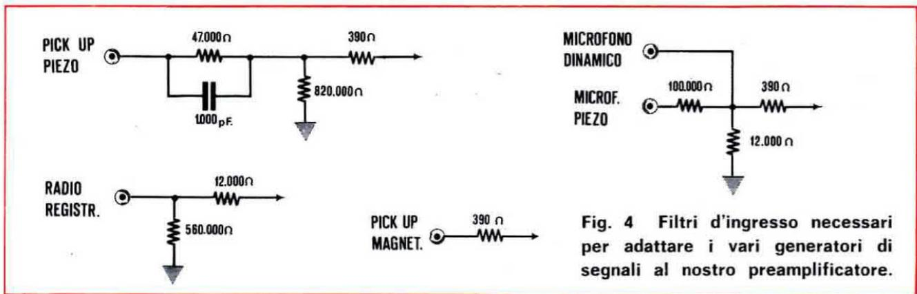
Fig. 4 Filtri d'ingresso necessari per adattare i vari generatori di segnali al nostro preamplificatore.
