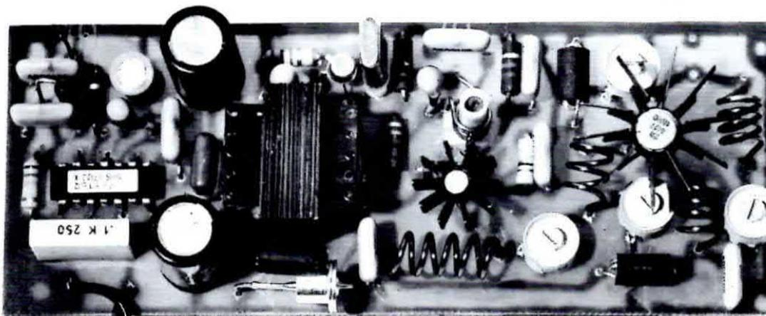
**Nella foto uno dei quattro prototipi montati nel nostro laboratorio per le prove di collaudo. Anche nel vostro progetto come nel nostro i transistor TR2-TR3 dovranno essere completati con una aletta di raffreddamento.**
