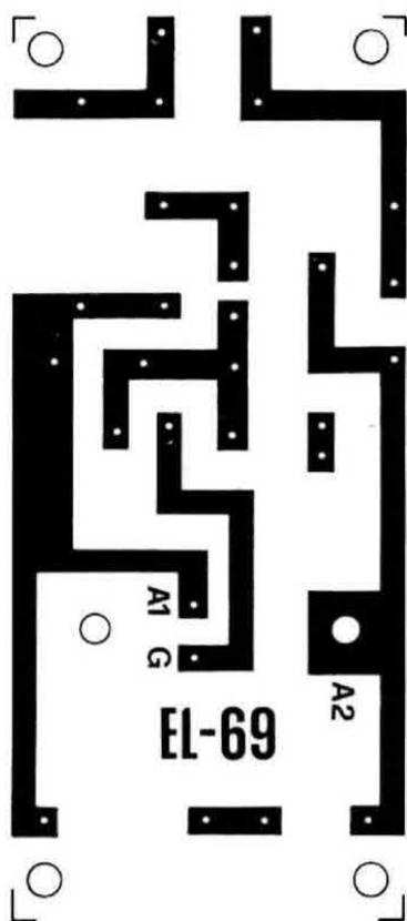
Disegno a grandezza naturale del circuito stampato di questo variatore di tensione alternata. Il circuito stampato, per coloro che lo realizzeranno in proprio, dovrà necessariamente risultare in fibra di vetro.
