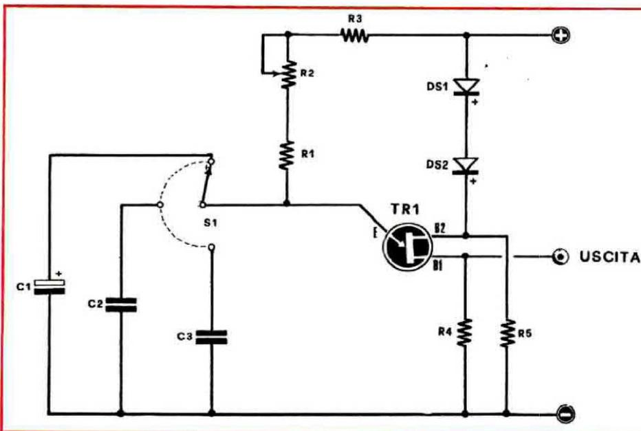
**Fig. 3. Utilizzando l'oscillatore a unigiunzione è possibile modificare la frequenza degli impulsi utili ad accelerare l'avanzamento delle cifre sulle valvole nixie. In questo caso sarà sufficiente applicare un semplice commutatore che inserisca dei condensatori di capacità diversa.**
