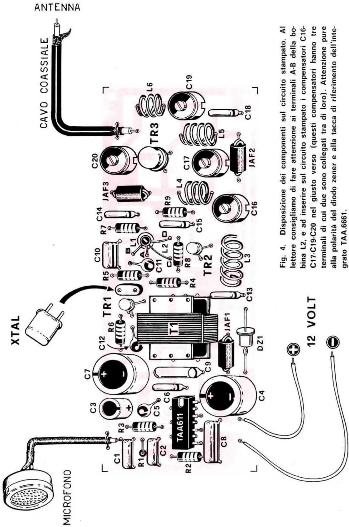
Fig. 4. Disposizione dei componenti sul circuito stampato. Al lettore consigliamo di fare attenzione ai terminali A-B della bobina L2, e ad inserire sul circuito stampato i compensatori C16-C17-C19-C20 nel giusto verso (questi compensatori hanno tre terminali di cui due sono collegati tra di loro). Attenzione pure alla polarità del diodo zener e alla tacca di riferimento dell'integrato TAA.6661.
