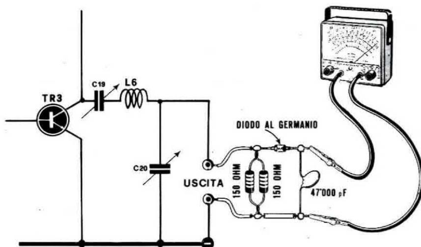
ratura degli stadi AF dovrà risultare ancora inserita. Se tutto è a posto, parlando sul microfono si potrà constatare che la tensione in uscita (misurata dal tester collegato alla sonda) passerà dai 8-9 volt iniziali ad un valore maggiore; in linea di massima si dovranno raggiungere gli 11-12 volt.
