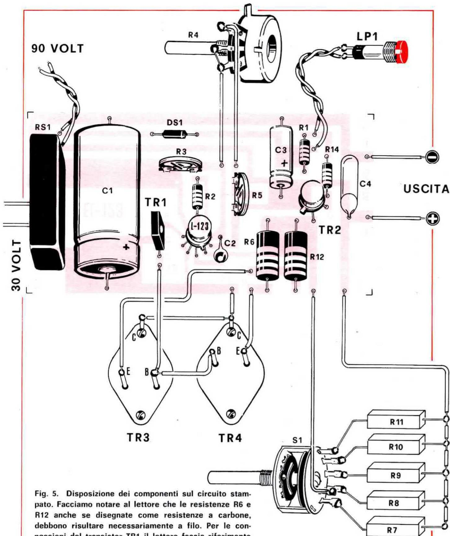
Fig. 5. Disposizione dei componenti sul circuito stampato. Facciamo notare al lettore che le resistenze R6 e R12 anche se disegnate come resistenze a carbone, debbono risultare necessariamente a filo. Per le connessioni del transistor TR1 il lettore faccia riferimento alla figura indicata a pag. 44. E' indispensabile che i transistor di potenza TR3-TR4 risultino adeguatamente raffreddati, quindi occorre montarli esternamente al mobile con due alette di raffreddamento.
