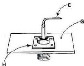
**Fig. 5. Il bocchettone per cavo coassiale risulta fissato come abbiamo visto precedentemente al centro della fascetta G. Il terminale centrale del bocchettone sarà stagnato come vedesi in disegno sul filo E che si collega all'adattatore circolare indicato con la lettera M.**
