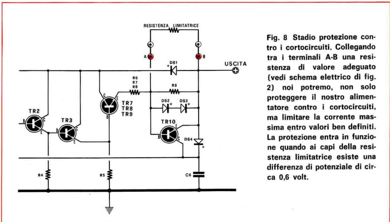
Fig. 8 Stadio protezione contro i cortocircuiti. Collegando tra i terminali A-B una resistenza di valore adeguato (vedi schema elettrico di fig. 2) noi potremo, non solo proteggere il nostro alimentatore contro i cortocircuiti, ma limitare la corrente massima entro valori ben definiti. La protezione entra in funzione quando ai capi della resistenza limitatrice esiste una differenza di potenziale di circa 0,6 volt.
