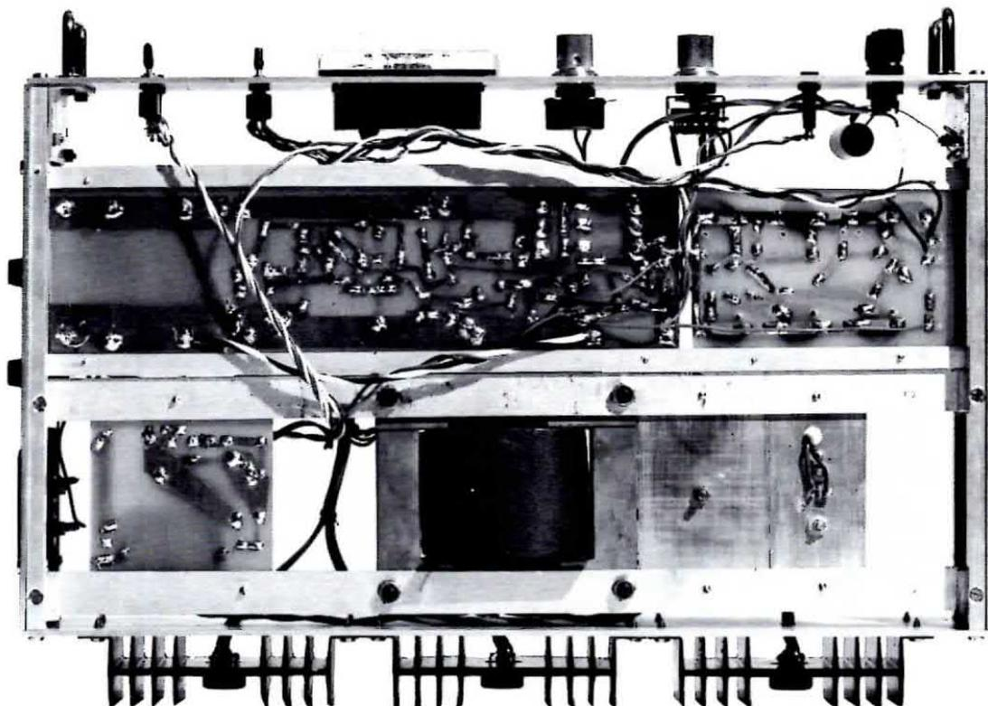
In alto a sinistra. Foto del primo prototipo EL115 realizzato dal nostro laboratorio. L'indicazione « mod. 50/4 presente sul pannello frontale significa che il progetto ha superato brillantemente le prove di collaudo alla tensione massima di 50 volt su 4 amper.
