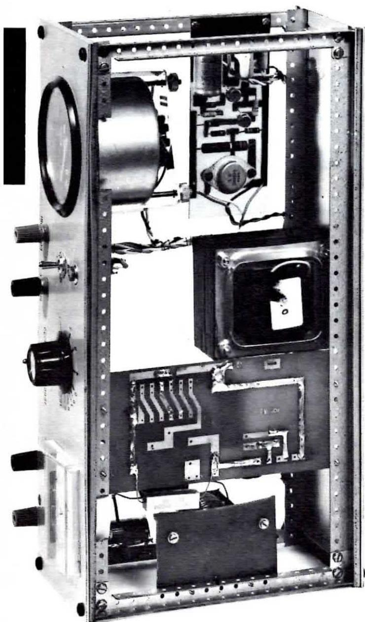
In alto si può vedere il circuito stampato del commutatore elettronico. In basso l'alimentatore stabilizzato in grado di erogare la tensione di 12,6 volt necessari ad alimentare qualsiasi accensione elettronica più il nostro commutatore.
