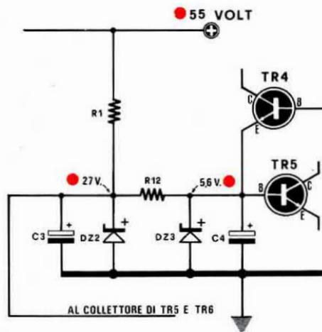
Fig. 3 Stadio che ci fornisce la tensione di riferimento. La resistenza R1 preleva la massima tensione positiva la invia ad un primo zener DZ2 per ottenere una prima stabilizzazione a 27 volt, tensione che utilizzeremo per TR5 e TR6, quindi ad un secondo zener DZ3 da 5,6 volt, quest'ultima tensione sarà la tensione di riferimento necessaria per il confronto con quella del comparatore.
