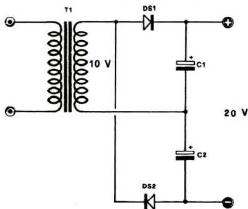
**Fig. 6 Duplicatore di tensione.** Collegando due diodi raddrizzatori, come indicato in disegno, noi otterremo in uscita una tensione doppia rispetto a quella alternata fornita dal trasformatore. I due condensatori elettrolitici di filtro dovranno essere scelti per una tensione di lavoro = volt AC x 1,4
