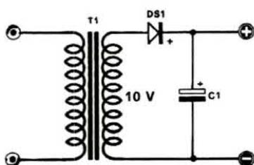
**Fig. 1** Raddrizzatore ad una semionda. Questo circuito presenta un solo inconveniente: richiede un condensatore di filtro di elevata capacità (32 mF per tensioni superiori ai 100 volt e 1.000 mF per tensioni inferiori) per poter ridurre il ronzio di alternata.
