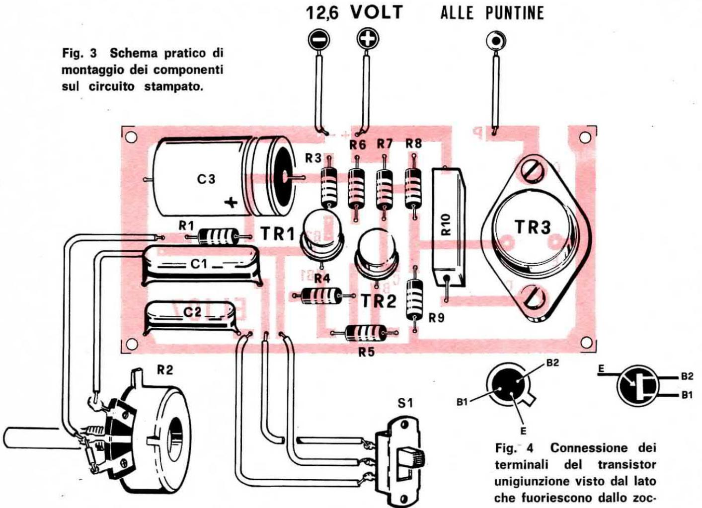
**Fig. 4 Connessione dei terminali del transistor unigiunzione visto dal lato che fuoriescono dallo zoccolo.**
