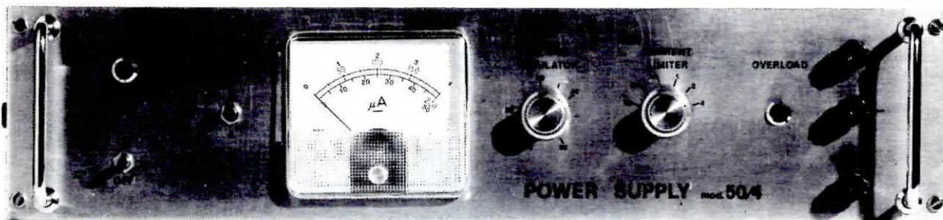
**A coloro ai quali il proprio laboratorio difetta di un alimentatore stabilizzato, presentiamo questo nostro progetto: è una apparecchiatura perfetta, capace di erogare da 4 a 6 Amper con tensione variabile da 6 a 55 Volt. Il tutto è provvisto di adeguate protezioni contro i cortocircuiti.**
