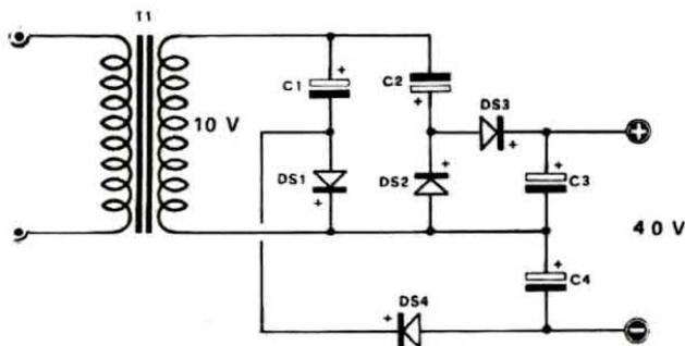
**Fig. 8** Quadruplicatore di tensione. Per quadruplicare una tensione si utilizzano due duplicatori di tensione collegati in serie. I condensatori elettrolitici C1-C2 e i diodi DS1-DS2 dovranno essere scelti per una tensione di lavoro  $= V/AC \times 1,4$  mentre C3-C4 e i diodi DS3-DS4 per una tensione di lavoro superiori ai valori  $= V/CA \times 2,8$
