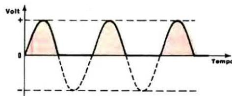
**Fig. 2** Un raddrizzatore a una semionda è chiamato così perché della corrente alternata ne raddrizza soltanto le semionde positive come vedesi in questo disegno. Pertanto nel periodo che è presente la semionda negativa il diodo rimane inoperoso.
