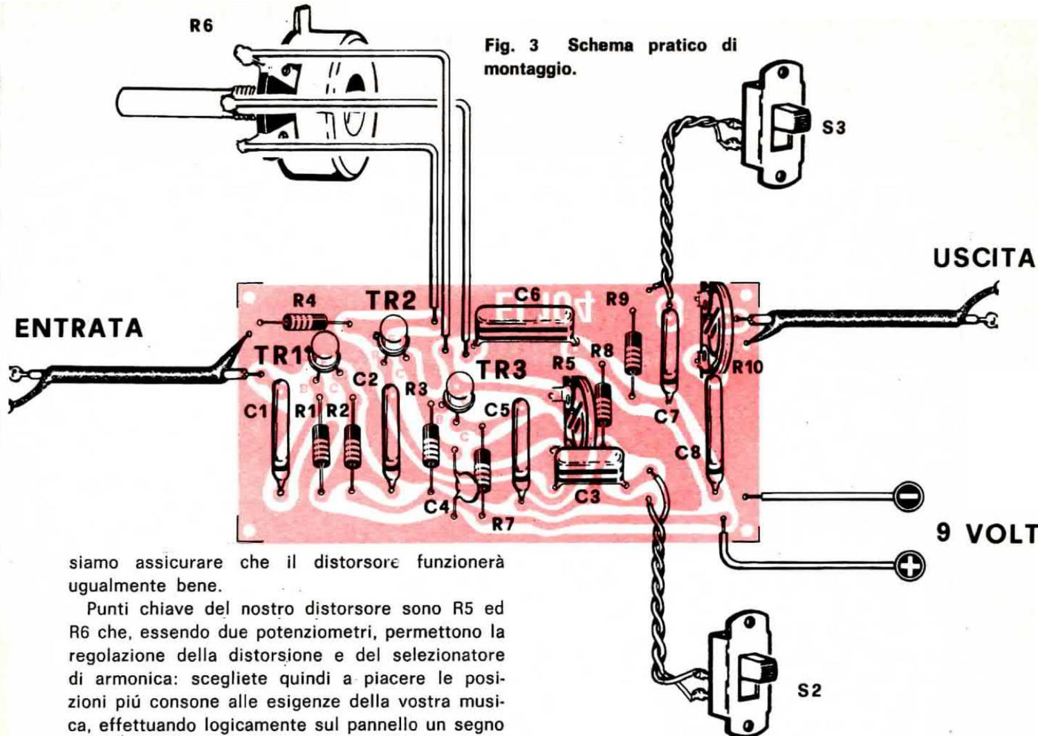
Fig. 3 Schema pratico di montaggio.
