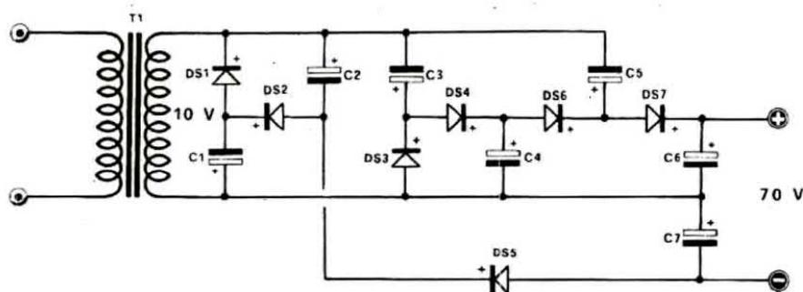
**Fig. 11 Settiplicatore di tensione.** Collegando in serie tra di loro un quadruplicatore ed un triplicatore otterremo un settiplicatore. La capacità dei condensatori non risultano indicate in quanto non sono critiche. Per tensioni superiori ai 100 volt si consiglia elettrolitici da 10-16-32 mF, per tensioni inferiori consigliamo capacità come ad esempio 50-100 mF.
