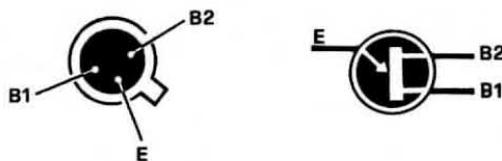
Disposizione dei terminali per il transistor unigiunzione.
