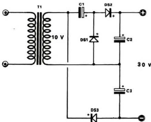
**Fig. 7** Triplicatore di tensione. Per realizzare un triplicatore è necessario impiegare tre diodi, collegati come nel disegno. La capacità dei condensatori non è critica, comunque noi consigliamo 10-32 mF per alte tensioni e 50-100 mF per basse tensioni. Occorre far presente che la tensione continua che otterremo risulta uguale a  $(V/AC \times 1,4 - 0,7) \times 3$
