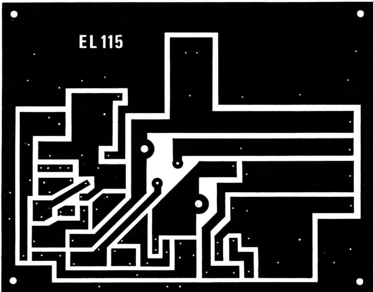
**Fig. 10** Circuito stampato a grandezza naturale dell'alimentatore EL115. Il circuito stampato da noi fornito è in fibra di vetro, consigliamo anche i lettori che volessero prepararselo in proprio di impiegare tale materiale scartando i supporti in cartone bachelizzato.
