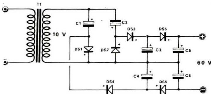
**Fig. 10 Sestuplicatore di tensione.** Per sestuplicare una tensione è sufficiente collegare in serie, come vedesi in disegno, due triplicatori. C1-C2-DS1-DS2 saranno scelti per una tensione di lavoro =  $V/AC \times 1,4$ , C3-C4-DS3-DS4 per =  $V/AC \times 2,8$ , C5-C6 e DS6-DS5 per =  $V/AC \times 4,2$ .
