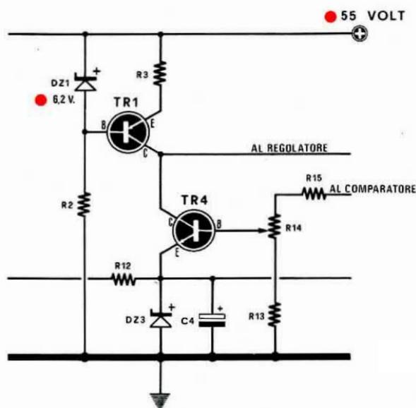
Fig. 5 Stadio amplificatore della tensione di errore. Il transistor TR4 viene impiegato per amplificare ulteriormente la tensione di errore per poter adeguatamente pilotare lo stadio di potenza (TR7-TR8-TR9). Per rendere questo amplificatore insensibile a qualsiasi variazione il collettore di TR4 viene alimentato da uno stabilizzatore di corrente composto dal transistor TR1.
