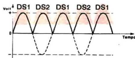
**Fig. 4** La tensione raddrizzata del circuito di fig. 3 non presenta come in quello precedente un vuoto tra una semionda e l'altra, poiché alternativamente quando ad un diodo giunge la semionda negativa sull'altro è presente quella positiva o viceversa.
