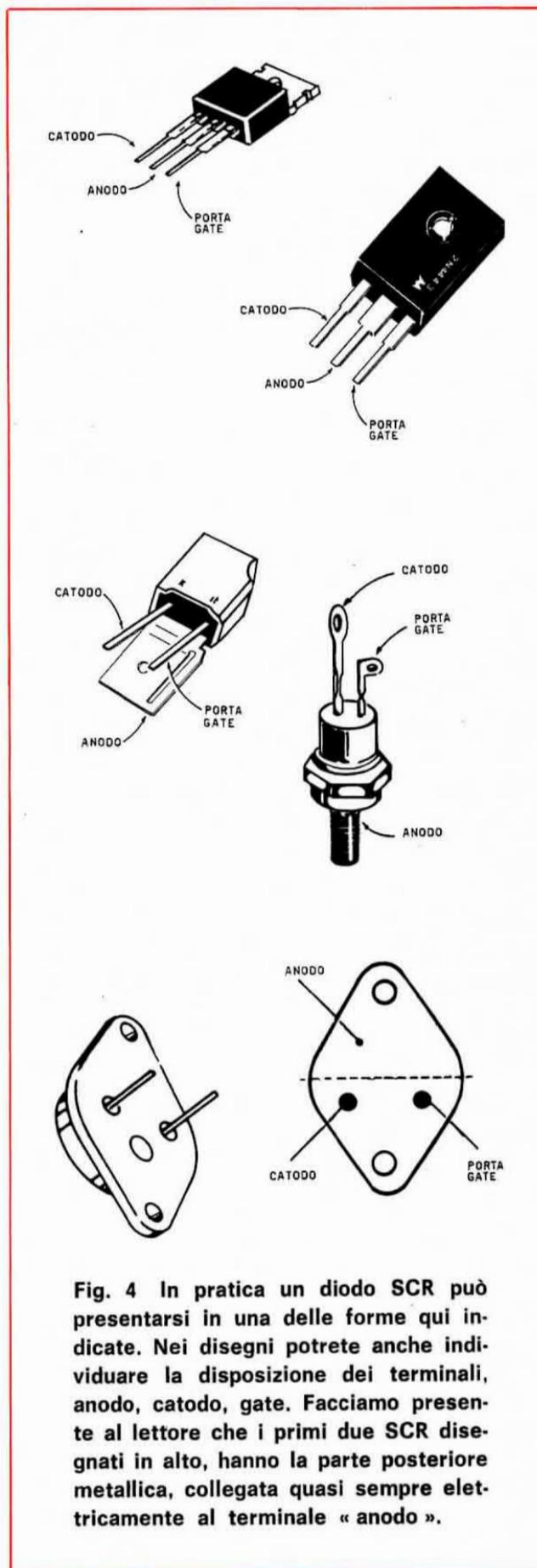
**Fig. 4** In pratica un diodo SCR può presentarsi in una delle forme qui indicate. Nei disegni potrete anche individuare la disposizione dei terminali, anodo, catodo, gate. Facciamo presente al lettore che i primi due SCR disegnati in alto, hanno la parte posteriore metallica, collegata quasi sempre elettricamente al terminale « anodo ».
