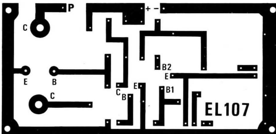
Fig. 2 Circuito stampato del commutatore elettronico da noi siglato EL107.
