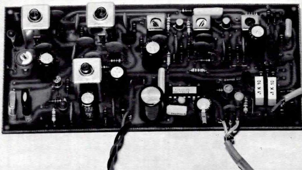
**Fotografia riguardante i primi prototipi del ricevitore RX27. Come spiegato nell'articolo su questi primi prototipi sono state apportate tutte quelle modifiche necessarie per migliorarne le caratteristiche. Si potrà constatare che i primi prototipi disponevano di soli 2 canali anziché 5 come il modello definitivo.**
