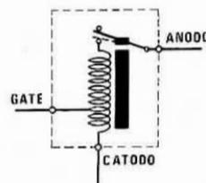
**Fig. 3** Un SCR in pratica potrebbe essere paragonato ad un relè. Una volta eccitata la bobina tramite il « gate », il relè rimarrà sempre in conduzione fino a quando non si toglierà tensione al catodo o all'anodo.
