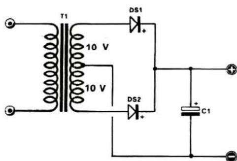
**Fig. 3** Raddrizzatore ad onda intera. Utilizzando un trasformatore con presa centrale e due diodi è possibile sfruttare entrambe le semionde della corrente alternata ottenendo così in uscita una tensione continua maggiormente livellata.
