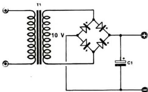
**Fig. 5 Raddrizzatore a ponte.** Impiegando quattro diodi è possibile ottenere il raddrizzamento ad onda intera impiegando un normale trasformatore senza presa centrale. Ricordatevi che la tensione continua ottenuta, previo raddrizzamento di una tensione alternata, risulta maggiore come indicato dalle formule presentate nell'articolo.
