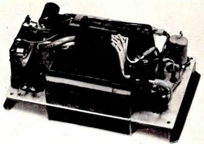
**Fig. 5** In questa foto è visibile il cablaggio interno del convertitore. Si noti come sulla sinistra il circuito stampato del multivibratore astabile risulti fissato verticalmente.
