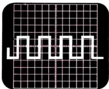
**Fig. 1** Forma d'onda vista all'oscilloscopio di un ottimo convertitore per accensione elettronica. Il segnale è stato prelevato ai capi del ponte raddrizzatore dei 450 volt, si noti come le onde quadre risultino esenti da picchi di sovratensione.
