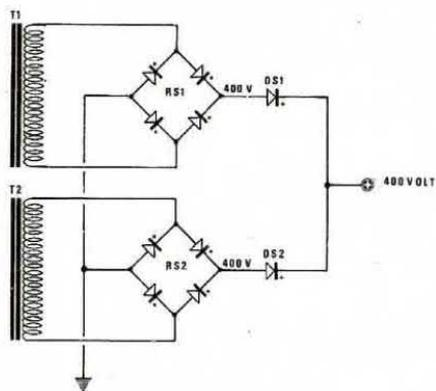
**Fig. 3** Per ottenere una potenza più che sufficiente ad incendiare la benzina in una camera di scoppio, occorre come minimo una potenza di 80-100 millijoule. Il convertitore per erogare la potenza richiesta, non solo dovrà risultare sovradimensionato ed eccitato da due 2N3055 ma disporre di un tempo di salita inferiore a 2 millisecondi. Nelle nostre prime esperienze noi avevamo ridotto questo tempo collegando in parallelo due convertitori, come vedesi in disegno.
