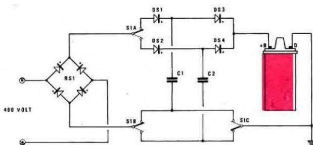
Schema teorico dell'accensione a scarica catodica. La commutazione tramite S1A-B-C cui sono interessati anche i diodi avviene per via elettronica. Il circuito è stato semplificato per evitare che altre riviste o industrie del ramo lo possano copiare.
