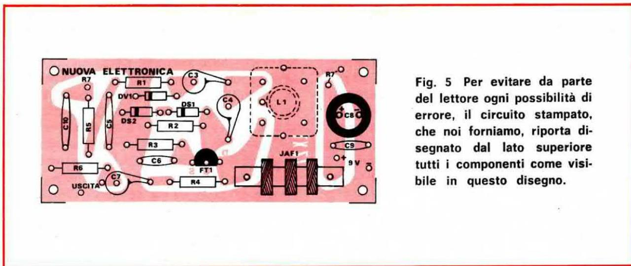
Fig. 5 Per evitare da parte del lettore ogni possibilità di errore, il circuito stampato, che noi forniamo, riporta disegnato dal lato superiore tutti i componenti come visibile in questo disegno.
