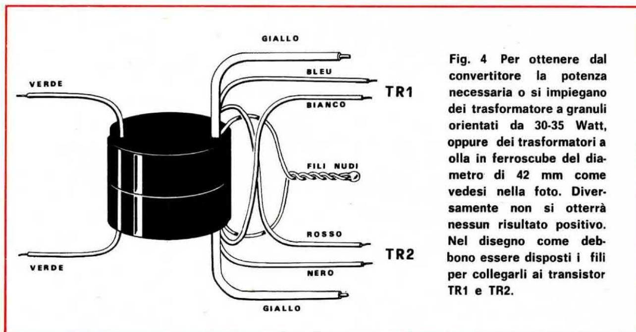
Fig. 4 Per ottenere dal convertitore la potenza necessaria o si impiegano dei trasformatore a granuli orientati da 30-35 Watt, oppure dei trasformatore a olla in ferrosilicio del diametro di 42 mm come vedesi nella foto. Diversamente non si otterrà nessun risultato positivo. Nel disegno come debbono essere disposti i fili per collegarli ai transistor TR1 e TR2.
