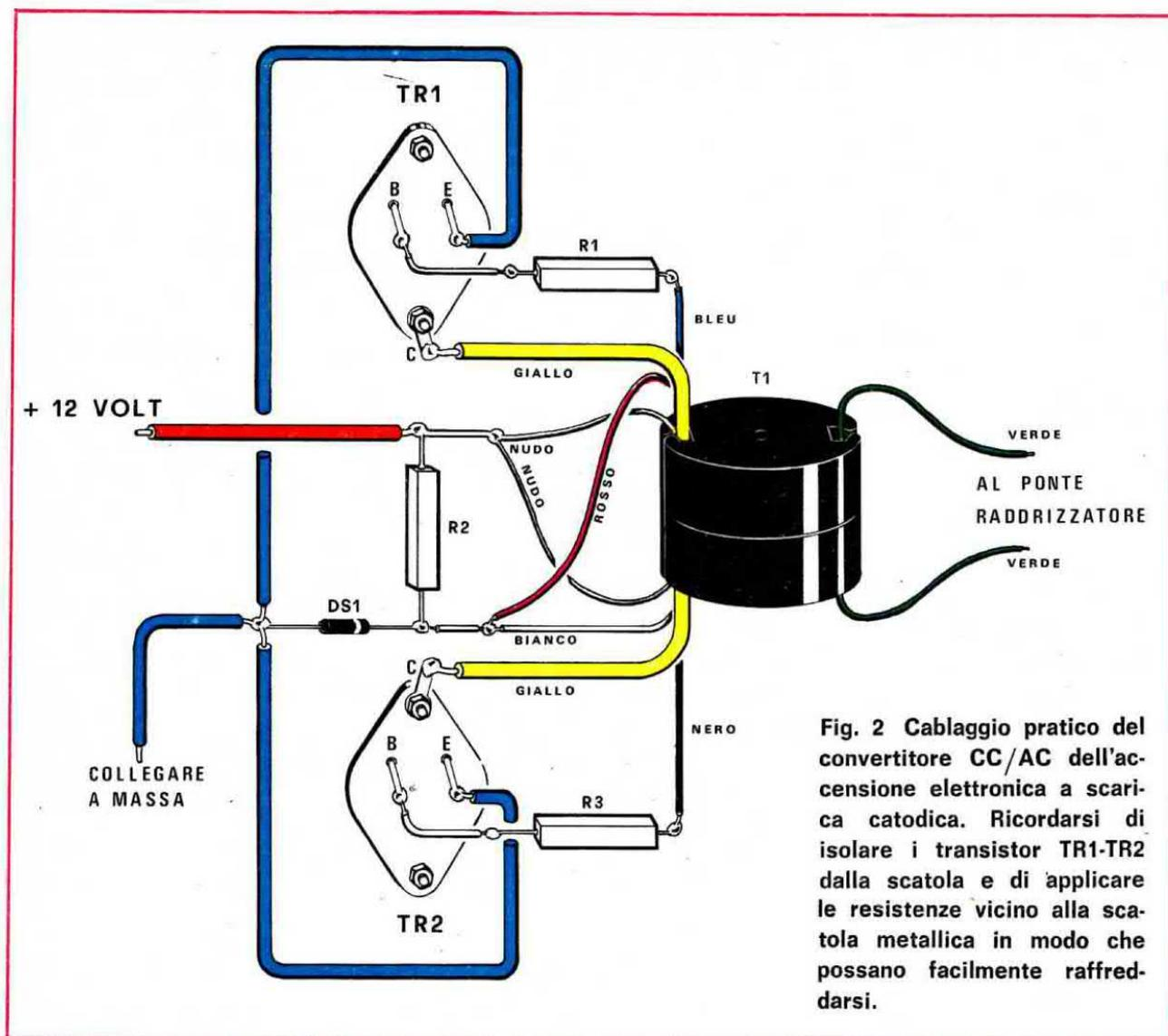
**Fig. 2** Cablaggio pratico del convertitore CC/AC dell'accensione elettronica a scarica catodica. Ricordarsi di isolare i transistor TR1-TR2 dalla scatola e di applicare le resistenze vicino alla scatola metallica in modo che possano facilmente raffreddarsi.
