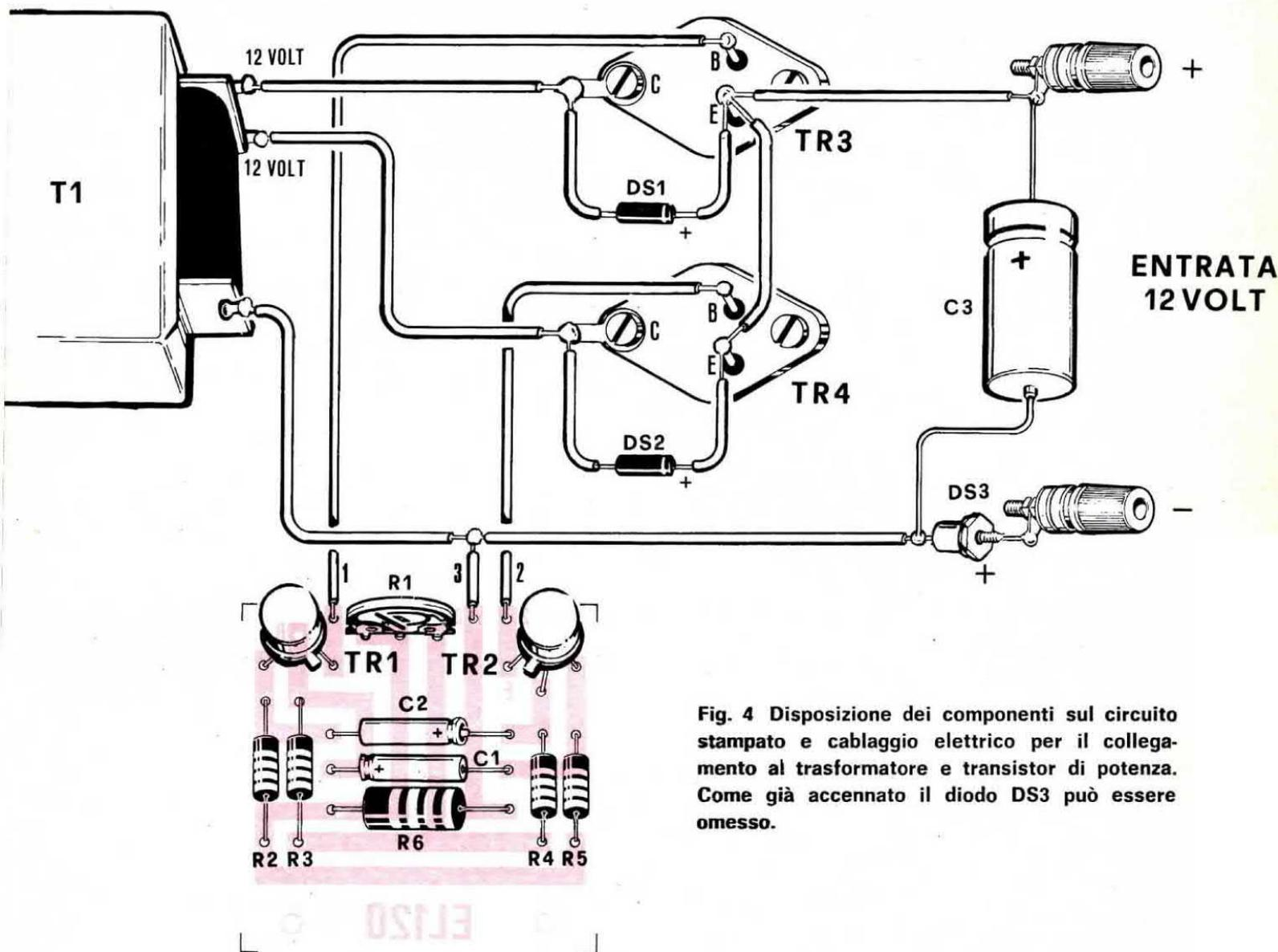
Fig. 4 Disposizione dei componenti sul circuito stampato e cablaggio elettrico per il collegamento al trasformatore e transistor di potenza. Come già accennato il diodo DS3 può essere omesso.
