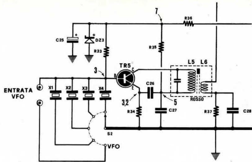
limitato e ci dà la possibilità di esplorare, a sintonia continua, una porzione di gamma che va dai 26.900 KHz ai 27.500 KHz, un intervallo quindi superiore a quello coperto dai 23 quarzi; presenta inoltre il vantaggio, regolando semplicemente il nucleo della bobina oscillatrice, di riuscire a portare la sintonia anche sui 10 metri, cioè dai 28.000 ai 30.000 KHz.
