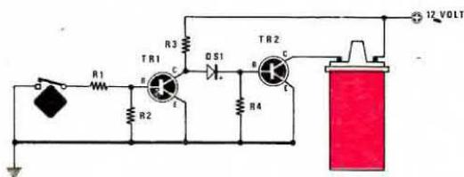
Fig. 1 Le prime accensioni elettroniche impiegavano un transistor in commutazione per poter far scorrere nella bobina una maggior corrente in modo da potenziare la scintilla. Non veniva però eliminato l'inconveniente che all'aumentare del numero di giri la potenza della scintilla proporzionalmente diminuiva.
