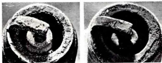
Fig. 7 Con l'accensione a scarica catodica, anche dopo 15.000 Km le candele risulteranno sempre pulite, non troveranno cioè, come avviene ora per l'accensione tradizionale, depositi carboniosi o scorie incombuste.
