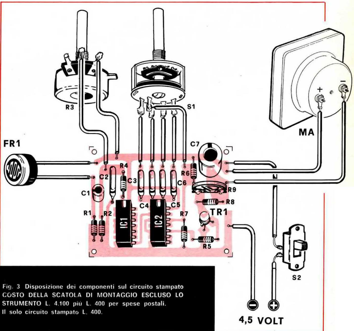
Fig. 3 Disposizione dei componenti sul circuito stampato CGSTO DELLA SCATOLA DI MONTAGGIO ESCLUSO LO STRUMENTO L. 4.100 più L. 400 per spese postali. Il solo circuito stampato L. 400.
