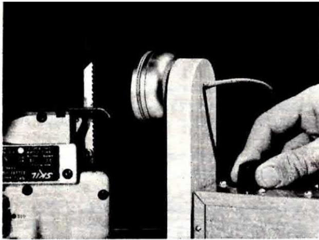
Questo tachimetro ha il pregio di poter misurare la velocità di corpi in movimenti anche alternati, come ad esempio il movimento di un seghetto. Per queste misure collocheremo la fotoresistenza ad un'altezza tale da poter ricevere la luce riflessa della lama ogni qualvolta questa raggiunge il limite superiore.
