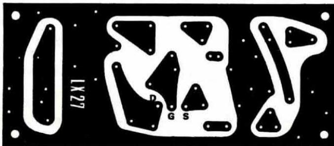
**Fig. 3** Dimensione a grandezza naturale del circuito stampato del VFO necessario al ricevitore RX27 pubblicato sul numero precedente.
