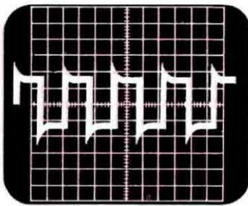
**Fig. 2** Anche questa forma d'onda risulta accettabilissima per un convertitore in quanto i picchi di sovratensione non superano il 20% della tensione efficace vale a dire che a vuoto anziché 450 volt ne avremo 540.
