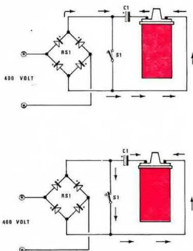
Fig. 2 Si riuscì a eliminare questo inconveniente solo con l'accensione a scarica capacitiva. Il principio di funzionamento è basato sulla carica e scarica di un condensatore. Ogni qualvolta le puntine dello spinterogeno eccitano l'SCR (indicato nel disegno come un interruttore S1) questo si cortocircuita e scarica i 400 volt immagazzinati dal condensatore sulla bobina AT. Per queste accensioni gli stadi più critici, sono il convertitore CC/AC e il circuito d'innesco.
