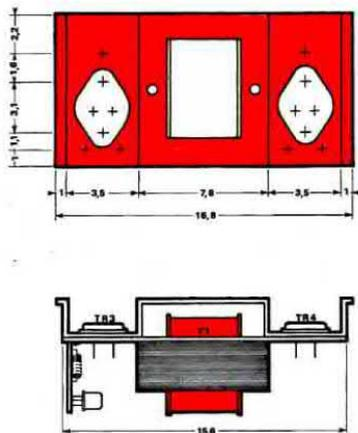
**Fig. 2** Il nostro collaboratore per applicare tutto il convertitore entro una scatola Teko mod. P3 ha usato la soluzione visibile in questo disegno. Ricordiamo al lettore che i due transistor di potenza TR3-TR4 dovranno risultare isolati dal supporto in alluminio che funge anche come aletta da raffreddamento.
