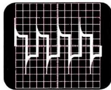
**Fig. 3** Se avremo sul secondario un'onda come visibile in questa foto, la nostra accensione corre seri pericoli. A vuoto infatti la tensione può raggiungere i 900 e più volt, quindi si può facilmente bruciare l'SCR.
