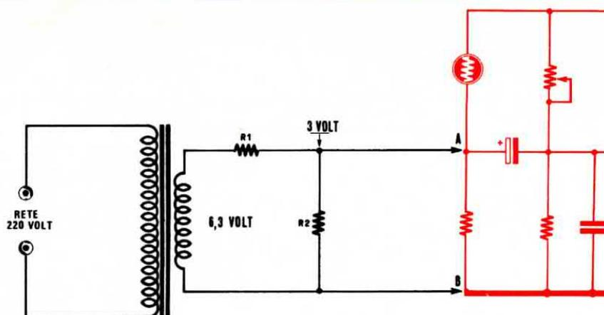
**Fig. 4** Per tarare lo strumento sulla prima portata, cioè 3.000 giri al fondo scala, preleveremo da un secondario di un trasformatore una tensione di circa 5-6 volt 50 Hz. che la limiteremo a circa 3 volt con un partitore composto da due resistenze da 10.000 ohm (R1-R2). Questa tensione verrà quindi applicata tra i punti A-B.
