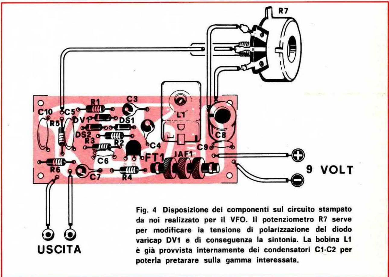
Fig. 4 Disposizione dei componenti sul circuito stampato da noi realizzato per il VFO. Il potenziometro R7 serve per modificare la tensione di polarizzazione del diodo varicap DV1 e di conseguenza la sintonia. La bobina L1 è già provvista internamente dei condensatori C1-C2 per poterla pretarare sulla gamma interessata.
