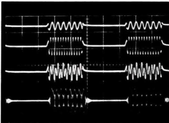
**Fig. 8** - In questa foto, possiamo vedere come si modifica la forma d'onda del segnale di alta frequenza quando i due segnali di BF non risultano perfettamente bilanciati. Come si potrà constatare l'ampiezza del segnale a 850 Hz è di circa la metà rispetto a quella del segnale a 1850 Hz.
