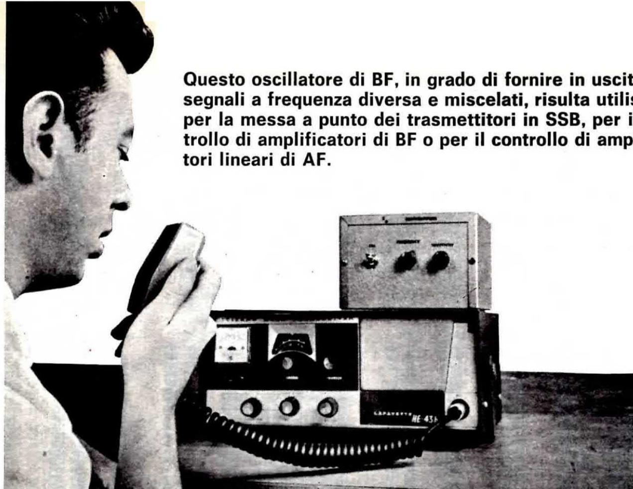
Quando si ha la necessità di mettere a punto un amplificatore lineare di AF o qualche trasmettitore in SSB, si inserisce normalmente nell'amplificatore di BF un segnale a nota fissa sui 1.000-1.500 Hertz, oppure se ancora più empiricamente fischiando davanti al microfono.
