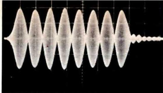
**Fig. 4** - Quando in un trasmettitore la polarizzazione di griglia dell'amplificatore lineare è regolato sul suo giusto valore modulandolo con un generatore a due toni, otterremo la forma d'onda visibile in figura. Si noti come gli estremi superiori e inferiori delle onde assumono la tipica forma di un'onda sinusoidale..
