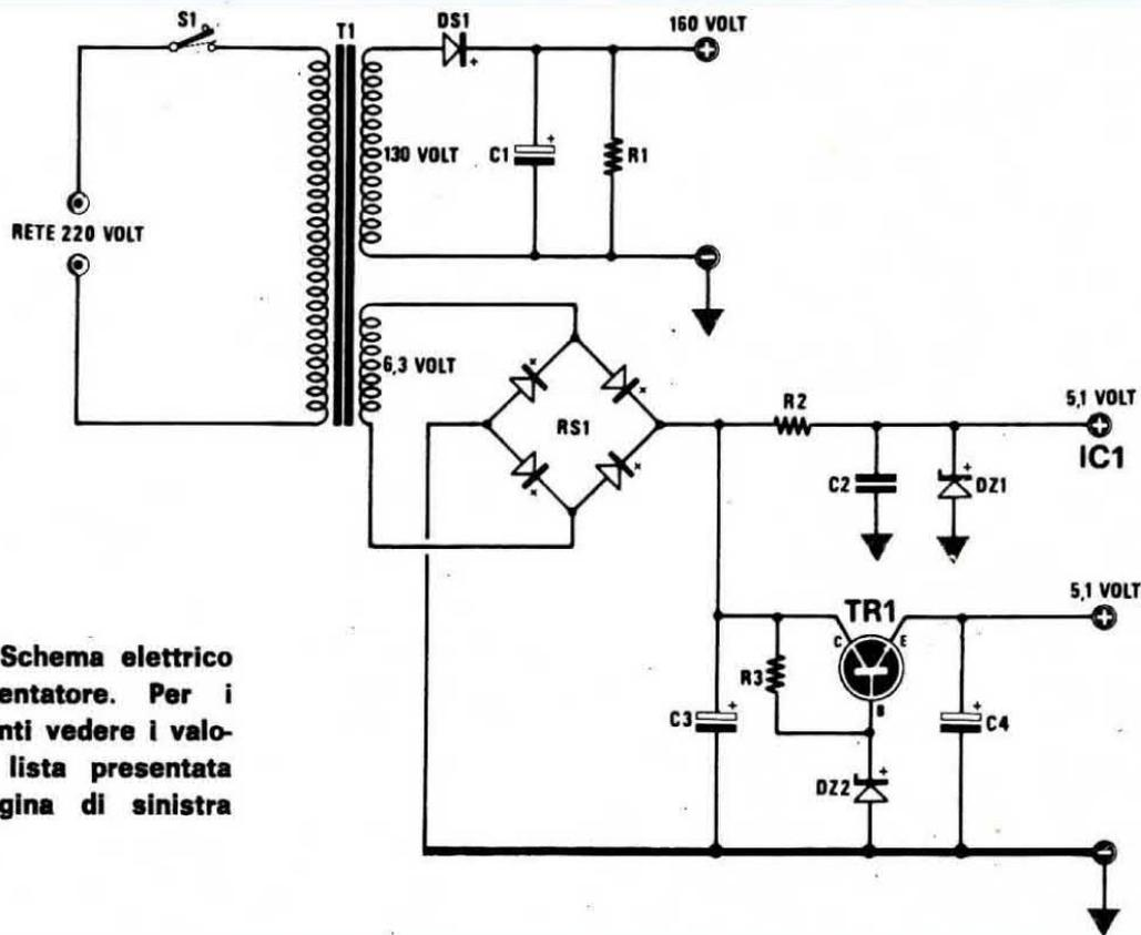
**Fig. 2 - Schema elettrico dell'alimentatore. Per i componenti vedere i valori nella lista presentata nella pagina di sinistra (fig. 1).**
