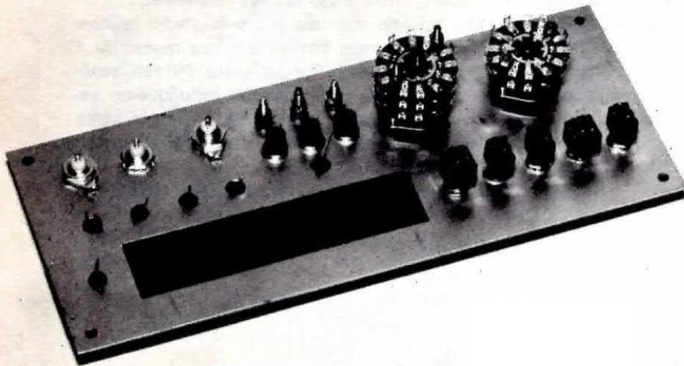
Fig. 10 - Sul pannello frontale, come vedesi in questa foto, andranno fissati oltre ai due commutatori rotativi, i deviatori a levetta, le tre prese d'entrata con bocchettone tipo BNC, i pulsanti per il cronometro ed i diodi elettroluminescenti LED. Questi diodi si fisseranno al telaio con le apposite rondelline fornite in dotazione con i Led.
