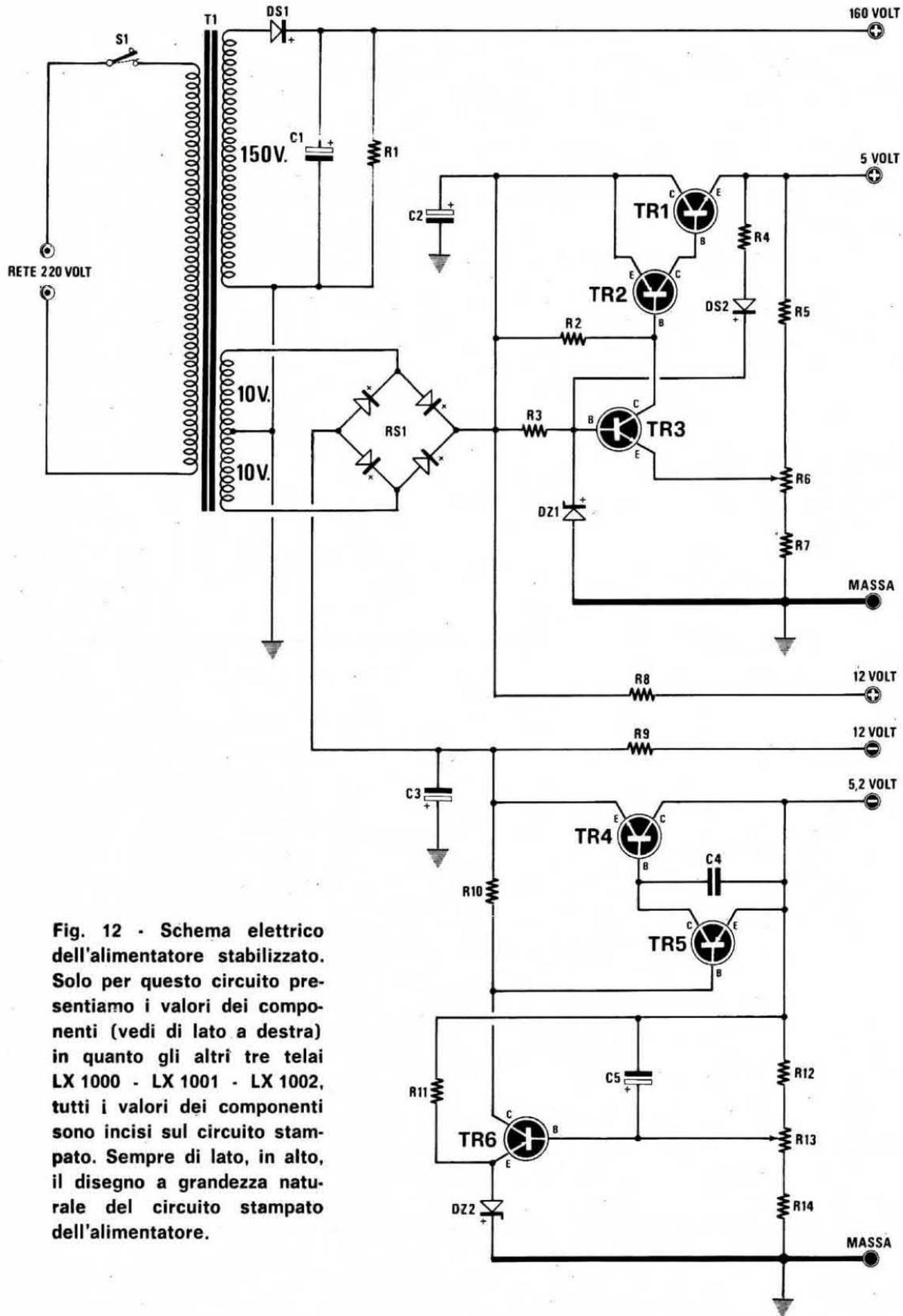
Fig. 12 - Schema elettrico dell'alimentatore stabilizzato. Solo per questo circuito presentiamo i valori dei componenti (vedi di lato a destra) in quanto gli altri tre telai LX 1000 - LX 1001 - LX 1002, tutti i valori dei componenti sono incisi sul circuito stampato. Sempre di lato, in alto, il disegno a grandezza naturale del circuito stampato dell'alimentatore.
