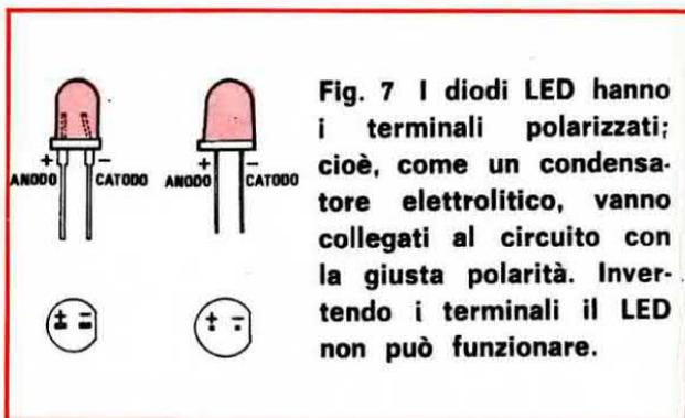
**Fig. 7** I diodi LED hanno i terminali polarizzati; cioè, come un condensatore elettrolitico, vanno collegati al circuito con la giusta polarità. Invertendo i terminali il LED non può funzionare.
