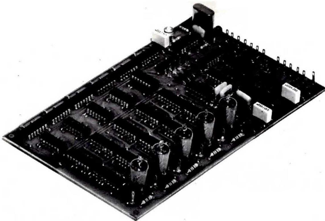
**Fig. 5 - Il telaio più importante è LX 1000 che potremo definire « il cervello » di tutto il frequenzimetro, in quanto comprende il circuito contatore, la base dei tempi, la memoria ed i tubi NIXIE per la visualizzazione. Solo su questo telaio sono inseriti ben 30 integrati più il quarzo da 1 MHz per la base dei tempi.**
