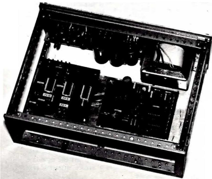
Fig. 9 - In questa foto possiamo vedere come vengono fissati entro alla scatola in basso, i due telai LX-1001 - LX 1002. Sul pannello posteriore troverà invece posto il telaio dell'alimentatore stabilizzato ed il relativo trasformatore T1.
