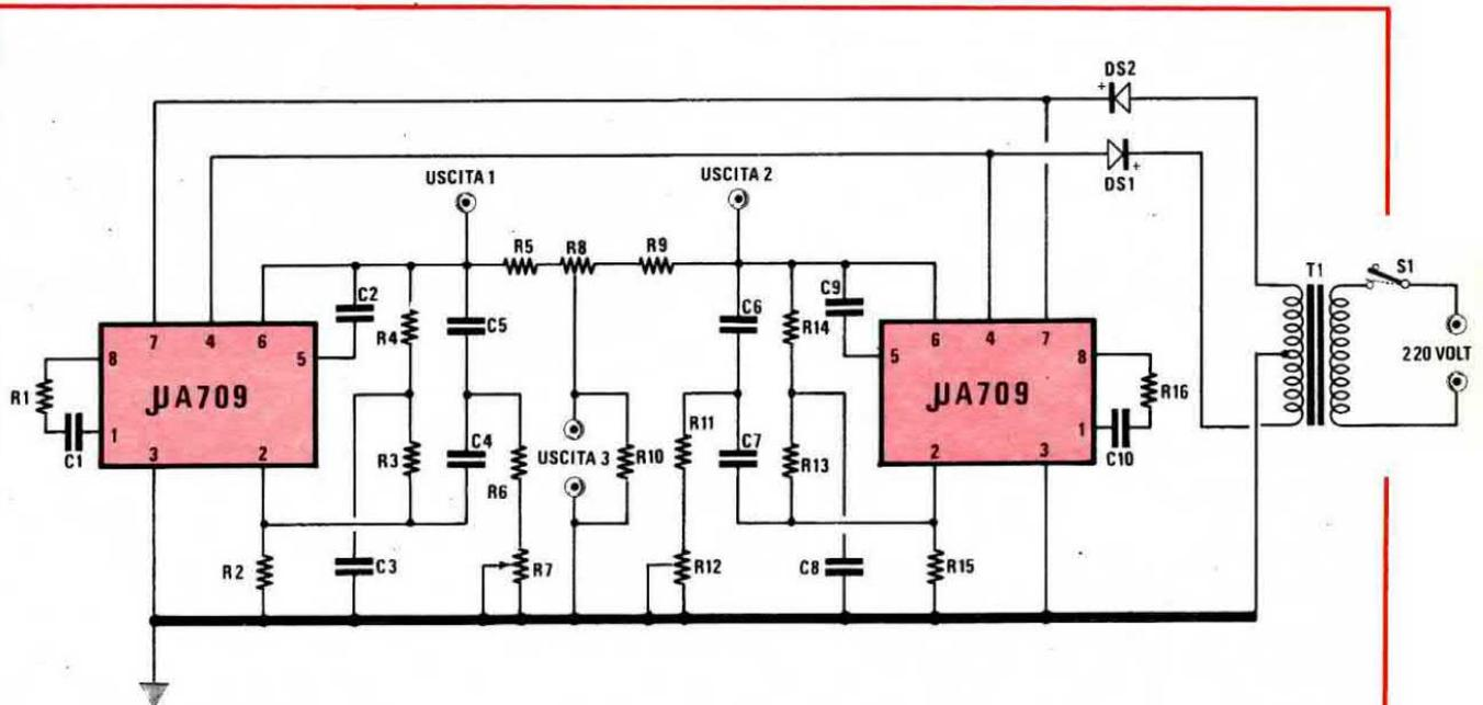
Fig. 1 - Circuito elettrico del generatore a due toni. A destra: le connessioni dei terminali dell'integrato  $\mu$ A.709 visti dal lato che fuoriescono dal corpo. Notare che il terminale 8 risulta in corrispondenza con la tacca di riferimento.
