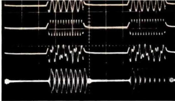
**Fig. 7** - Ecco come si presentano all'oscilloscopio (dall'alto in basso) la frequenza di 850 Hz, quella da 1850 Hz e le due frequenze miscelate prelevate sull'uscita n. 3. Per ultimo come appare un segnale di alta frequenza modulato da questo generatore a duplice tonalità quando il trasmettitore risulta perfettamente tarato.
