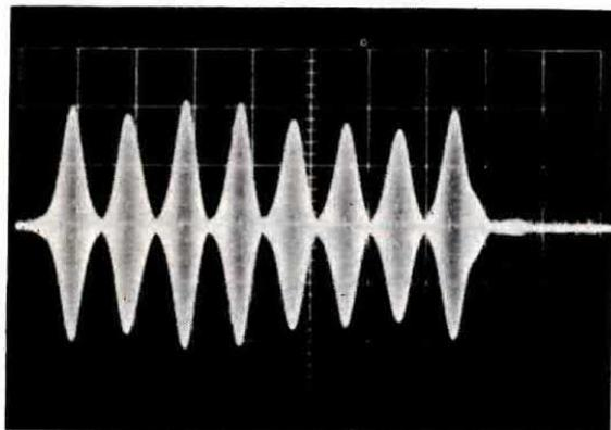
**Fig. 6** - Se la tensione di polarizzazione dello stadio finale risulta più negativa di quanto richiesto, otterremo una forma d'onda simile a quella visibile in figura, cioè gli estremi delle varie onde non presentano l'identica ampiezza e in queste condizioni la voce risulterà notevolmente distorta.
