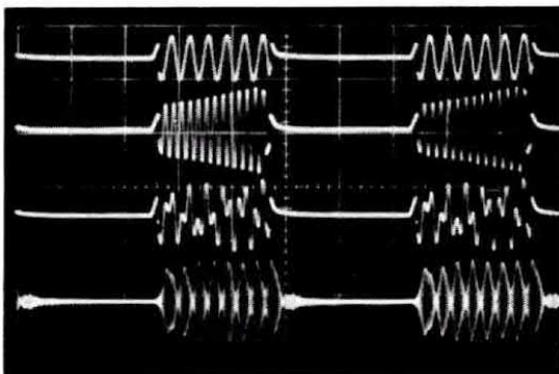
**Fig. 9** - Se i due trimmer R7 e R12 del generatore a due toni non sono ben regolati, l'ampiezza dell'onda risulta irregolare. Si noti come l'onda a 850 Hz è a forma di trapezio: ciò significa che il trimmer R7 deve essere regolato per introdurre nel circuito una resistenza maggiore.
