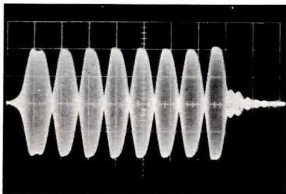
**Fig. 5** - Se lo stadio pilota risulta troppo sovraccaricato per un eccesso di accoppiamento o la tensione di polarizzazione dello stadio finale è meno negativa del richiesto, noteremo sull'oscilloscopio che gli estremi dell'onda superiore ed inferiore risultano piatti. Tale condizione causa splatter e distorsione.
