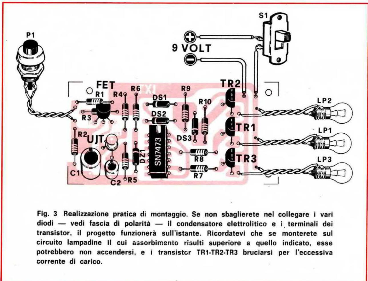
Fig. 3 Realizzazione pratica di montaggio. Se non sbaglierete nel collegare i vari diodi — vedi fascia di polarità — il condensatore elettrolitico e i terminali dei transistor, il progetto funzionerà sull'istante. Ricordatevi che se monterete sul circuito lampadine il cui assorbimento risulti superiore a quello indicato, esse potrebbero non accendersi, e i transistor TR1-TR2-TR3 bruciarsi per l'eccessiva corrente di carico.
