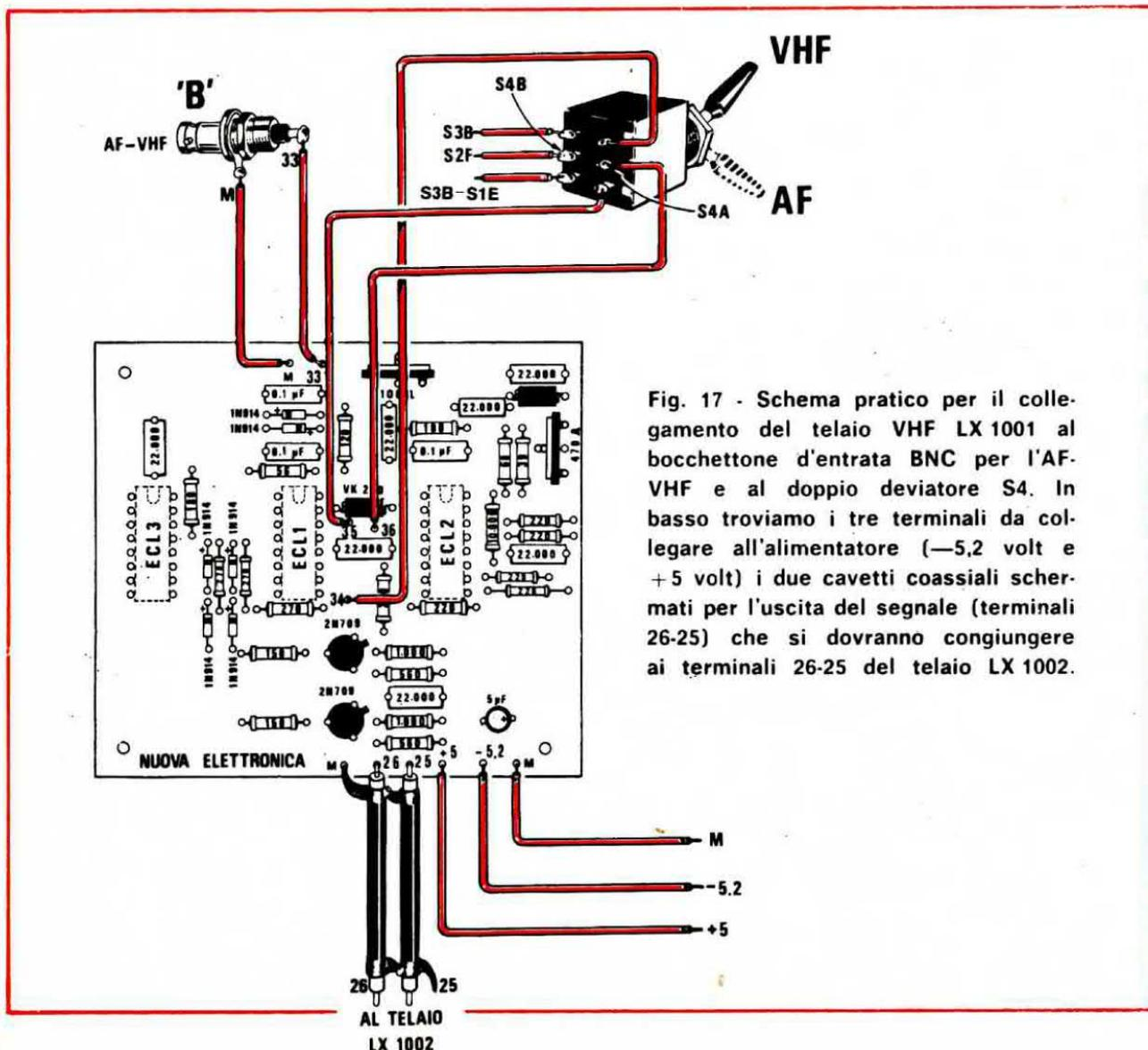
Fig. 17 - Schema pratico per il collegamento del telaio VHF LX 1001 al bocchettone d'entrata BNC per l'AF-VHF e al doppio deviatore S4. In basso troviamo i tre terminali da collegare all'alimentatore (-5,2 volt e +5 volt) i due cavetti coassiali schermati per l'uscita del segnale (terminali 26-25) che si dovranno congiungere ai terminali 26-25 del telaio LX 1002.
