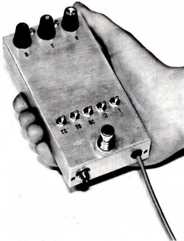
Per evitare ronzii, tutto il distorsore dovrà risultare racchiuso entro una scatola metallica. Anche i collegamenti che al pick-up si congiungono al distorsore e da questo all'amplificatore di BF debbono essere effettuati con cavetto schermato.
