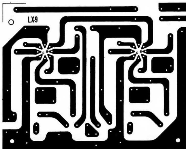
**Fig. 2 - Circuito stampato a grandezza naturale richiesto per la realizzazione del generatore a duplice tonalità. Il circuito risulta inciso su lastra in fibra di vetro.**
