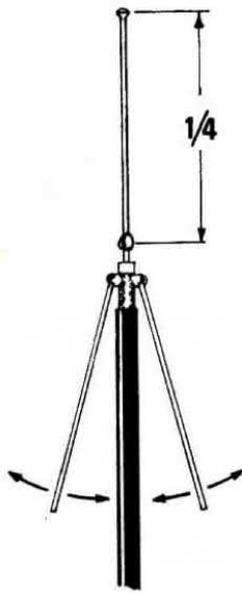
**Fig. 8.** Per le antenne a stilo da  $\frac{1}{4}$  d'onda o per le ground-plane, modificando l'inclinazione dei bracci collegati alla calza metallica del cavetto schermato si riesce con questa sola operazione a eliminare totalmente le onde stazionarie.
