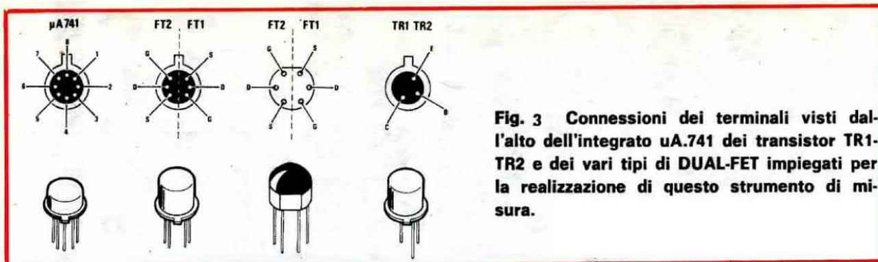
**Fig. 3** Connessioni dei terminali visti dall'alto dell'integrato uA.741 dei transistor TR1-TR2 e dei vari tipi di DUAL-FET impiegati per la realizzazione di questo strumento di misura.
