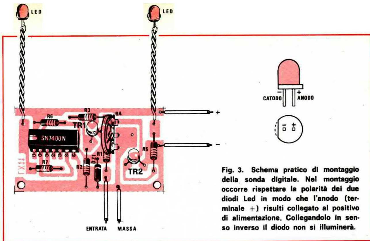
**Fig. 3. Schema pratico di montaggio della sonda digitale. Nel montaggio occorre rispettare la polarità dei due diodi Led in modo che l'anodo (terminale +) risulti collegato al positivo di alimentazione. Collegandolo in senso inverso il diodo non si illuminerà.**
