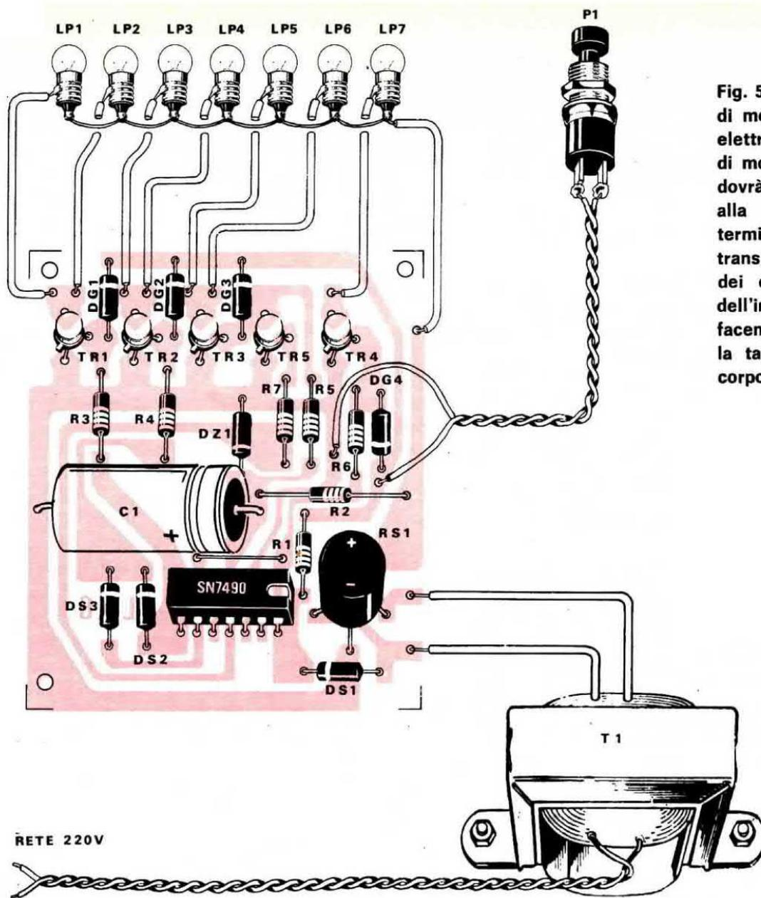
Fig. 5. Schema pratico di montaggio del dado elettronico. Nella fase di montaggio il lettore dovrà fare attenzione alla disposizione dei terminali E-B-C dei transistor, alla polarità dei diodi e a quella dell'integrato SN7490 facendo riferimento alla tacca presente sul corpo stesso.
