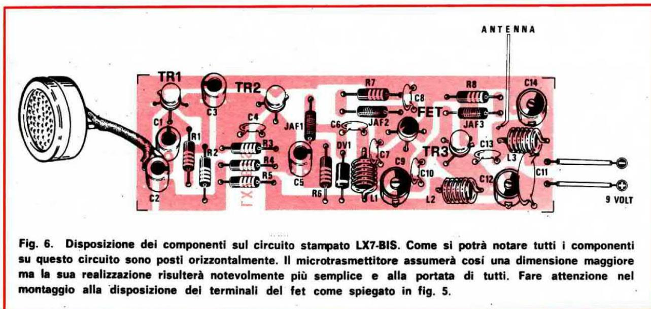
Fig. 6. Disposizione dei componenti sul circuito stampato LX7-BIS. Come si potrà notare tutti i componenti su questo circuito sono posti orizzontalmente. Il microtrasmettitore assumerà così una dimensione maggiore ma la sua realizzazione risulterà notevolmente più semplice e alla portata di tutti. Fare attenzione nel montaggio alla disposizione dei terminali del fet come spiegato in fig. 5.
