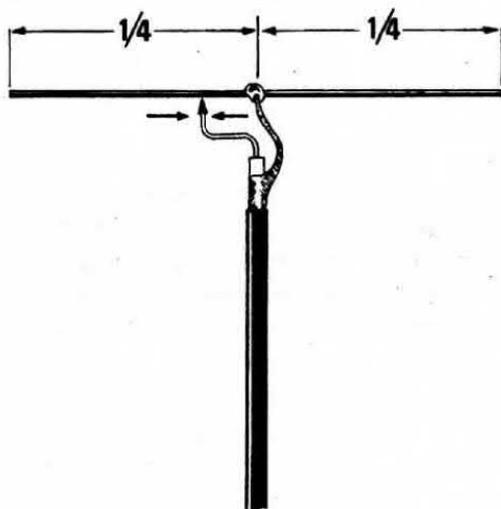
**Fig. 7.** Nei dipoli dove la calza metallica risulta collegata esattamente al centro della antenna, per eliminare le onde stazionarie risulterà sufficiente spostare il punto di contatto su uno dei due bracci come vedesi in disegno. Solo in casi particolari potrà risultare necessario accorciare di qualche centimetro le due estremità dell'antenna.
