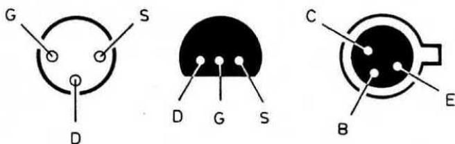
Fig. 3. Disposizione dei terminali dei transistor e dei fet visti dal lato che fuoriescono dal corpo. Il lettore faccia attenzione alla forma del fet, in quanto pur riportando la stessa sigla, se questo è di forma cilindrica, la disposizione dei terminali non è identica ai fet di forma semicilindrico retto circolare.
