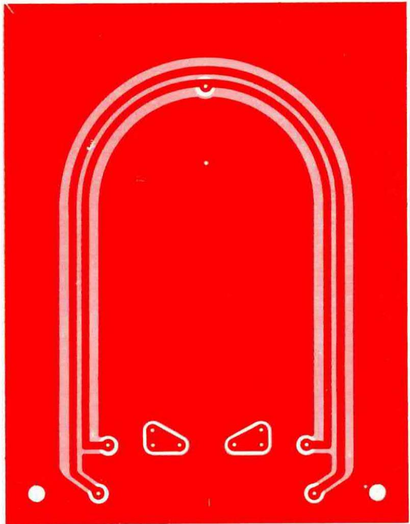
**Fig. 3.** Per frequenze comprese tra i 20 e i 220 MHz, consigliamo di impiegare questo secondo circuito stampato in quanto più idoneo per VHF. I valori dei componenti risultano analoghi per entrambi i due circuiti, cioè i valori indicati sullo schema elettrico di fig. 1.
