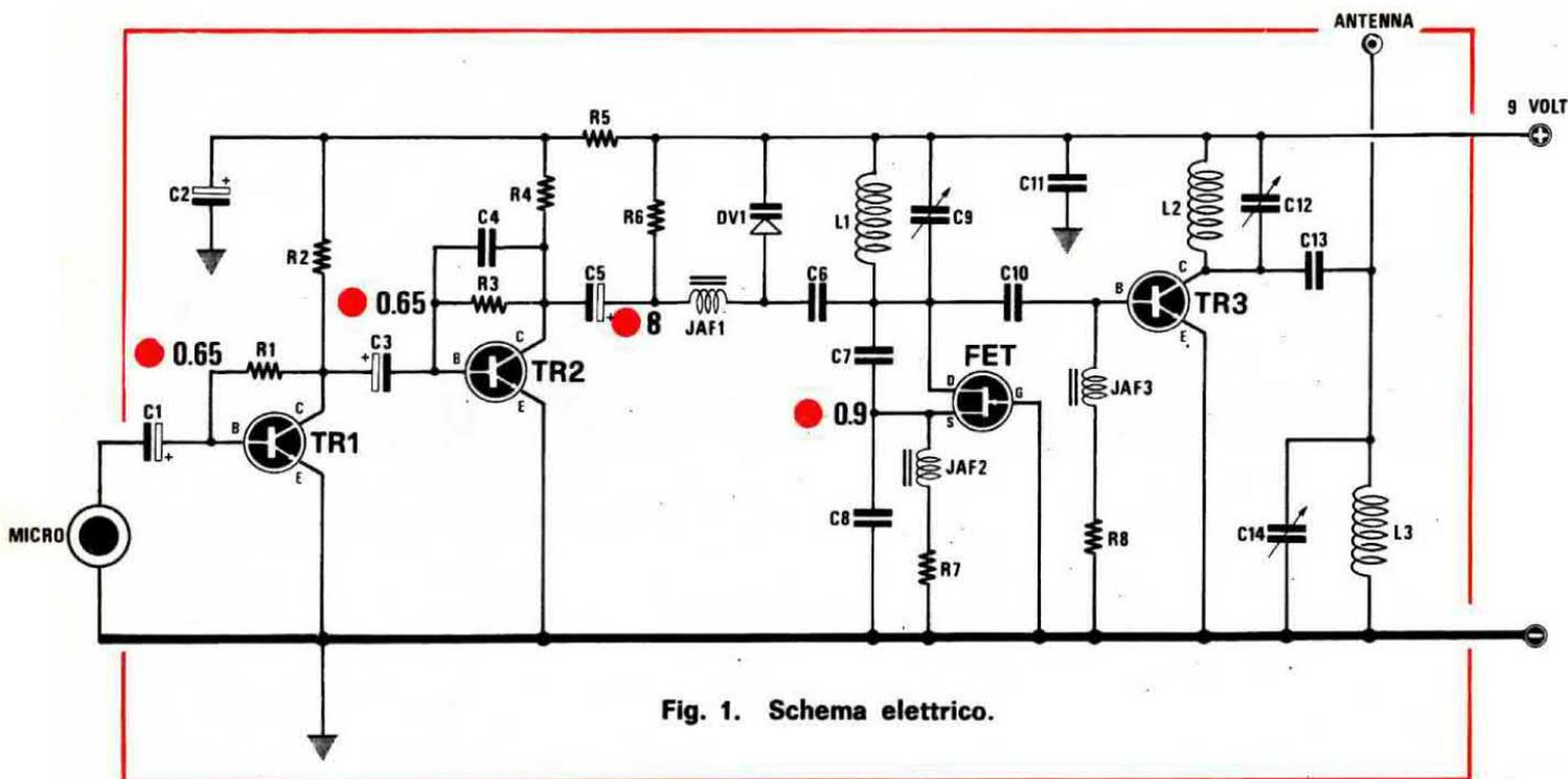
Fig. 1. Schema elettrico.
