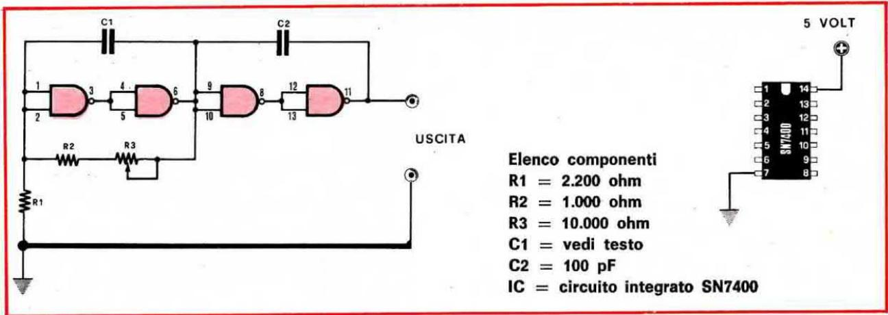
entro il  $\pm 20\%$ ) con tempi di salita discretamente bassi e con frequenza compresa tra qualche centesimo di Hz ( $C1=1.000$  mF) ed una decina di KHz ( $C1=100.000$  pF).
