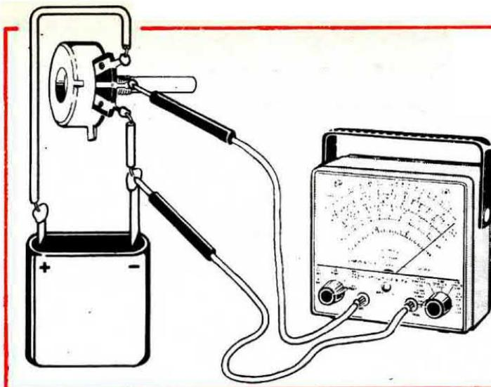
**Fig. 6** Per poter disporre di tensioni inferiori a 1 volt, necessarie per la taratura del voltmetro, realizzeremo questo semplice circuito composto come vedesi in disegno da una pila da 4,5 volt e un potenziometro da 10.000 ohm. Per ottenere una maggior precisione, in sostituzione della pila da 4,5 volt se ne potrà utilizzare una da 1,5 volt.
