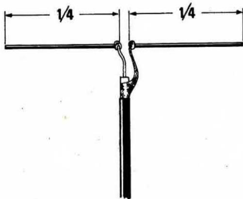
**Fig. 6.** Per eliminare le onde stazionarie in un'antenna a dipolo, ammesso che l'uscita del trasmettitore disponga di una impedenza di uscita analoga a quella del cavo coassiale, risulterà sufficiente accorciare o allungare contemporaneamente i due bracci. La lunghezza dei due bracci per questo tipo di antenna dovrà risultare provvisoriamente per entrambi di  $\frac{1}{4}$  d'onda.
