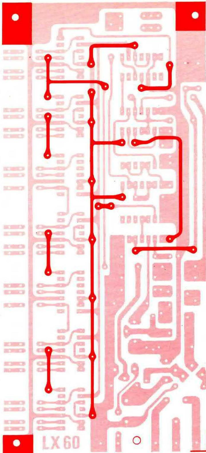
**Fig. 6** Circuito stampato a doppia faccia del contatore digitale da noi denominato LX60. Facciamo presente al lettore che le piste di rame superiori andranno collegate con quelle inferiori tramite sottili fili di rame, stagnandoli da entrambe le parti. (vedi anche schema pratico).
