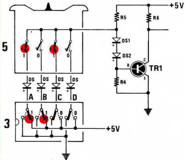
Fig. 5 In questo disegno abbiamo invece raffigurato le uscite A-B-C-D dell'integrato SN7490, quando esso riceve in entrata solo 3 impulsi. Nell'esempio il commutatore binario risulta sempre predisposto per il n. 5. In queste condizioni il terminale A dell'integrato è collegato al positivo di alimentazione, mentre il terminale C è cortocircuitato a massa.
