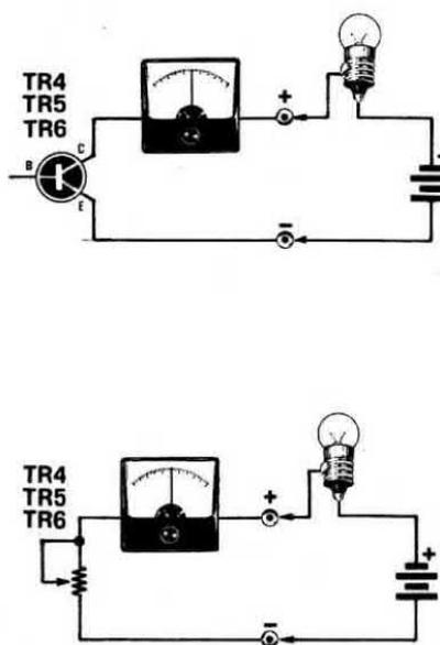
**Fig. 3** Come è possibile intuire da questi due disegni, i transistor di potenza TR4-TR5-TR6 si comportano come una resistenza variabile, posta in serie al circuito di carico, dissipando in calore la corrente in eccesso. Lo strumento amperometro ci indicherà la corrente che scorre attraverso ai transistor e di conseguenza al carico esterno.
