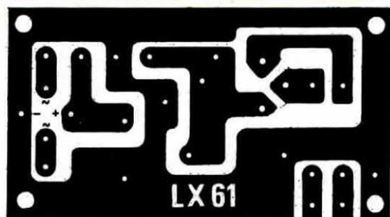
**Fig. 7** Circuito stampato a grandezza naturale del telaio LX61, sul quale troverà posto il transistor che pilota il diodo LED dello « stop » e il ponte raddrizzatore RS2.
