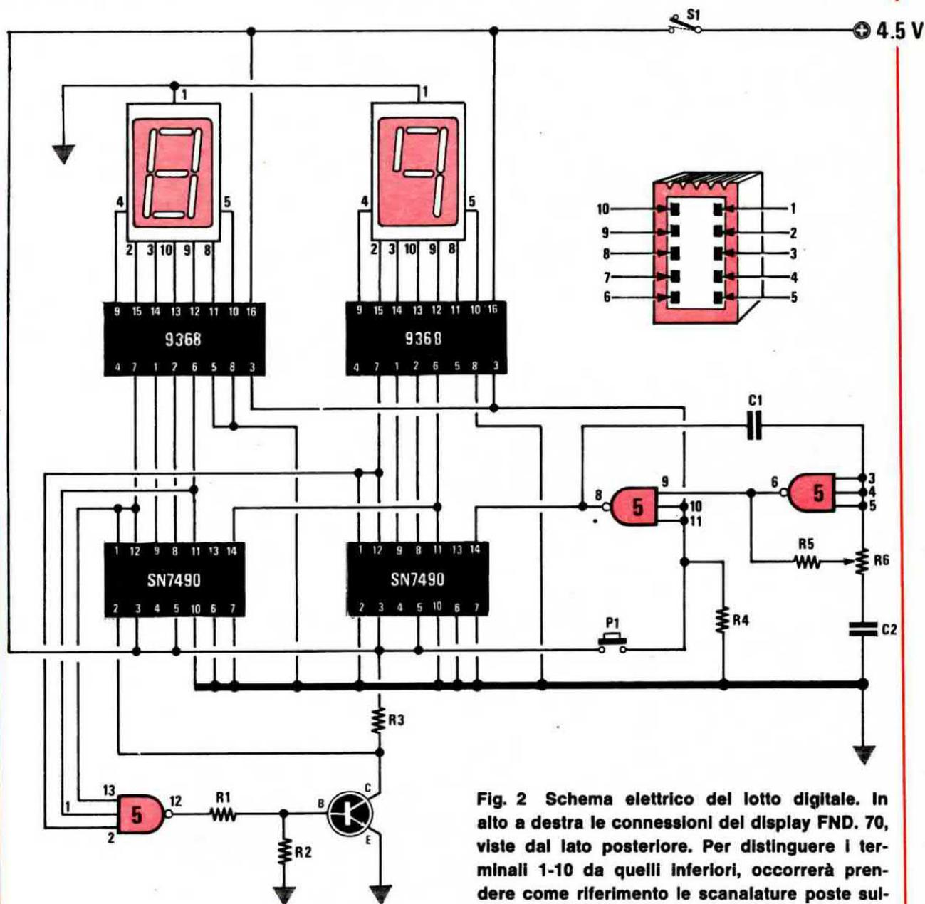
Fig. 2 Schema elettrico del lotto digitale. In alto a destra le connessioni del display FND. 70, viste dal lato posteriore. Per distinguere i terminali 1-10 da quelli inferiori, occorrerà prendere come riferimento le scanalature poste sull'estremo del corpo.
