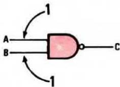
**Fig. 1** Se le entrate A e B di una qualsiasi porta non risultano collegate né al positivo, né al negativo di alimentazione, le due entrate, contrariamente a quanto si potrebbe supporre, non si trovano in condizione «0», cioè a tensione ZERO, bensì in condizione «1», cioè come se risultassero collegate al positivo di alimentazione.
