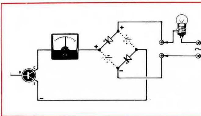
**Fig. 4** Questo reostato funziona anche per corrente alternata, il ponte raddrizzatore in questo caso risulta indispensabile per poter far giungere al collettore la semionda positiva, e all'emettitore sempre la semionda negativa.
