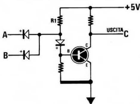
**Fig. 3** Il motivo per il quale i due terminali di entrata di una porta, se lasciati liberi, si trovino in condizione «1», lo possiamo comprendere facilmente guardando lo schema elettrico di una porta DTL. Come è possibile intuire, se le due entrate A-B non risultano collegate a massa, avremo sempre sulle uscite la tensione positiva dei 5 volt di alimentazione, e i due diodi di uscita posti nel giusto senso di conduzione.
