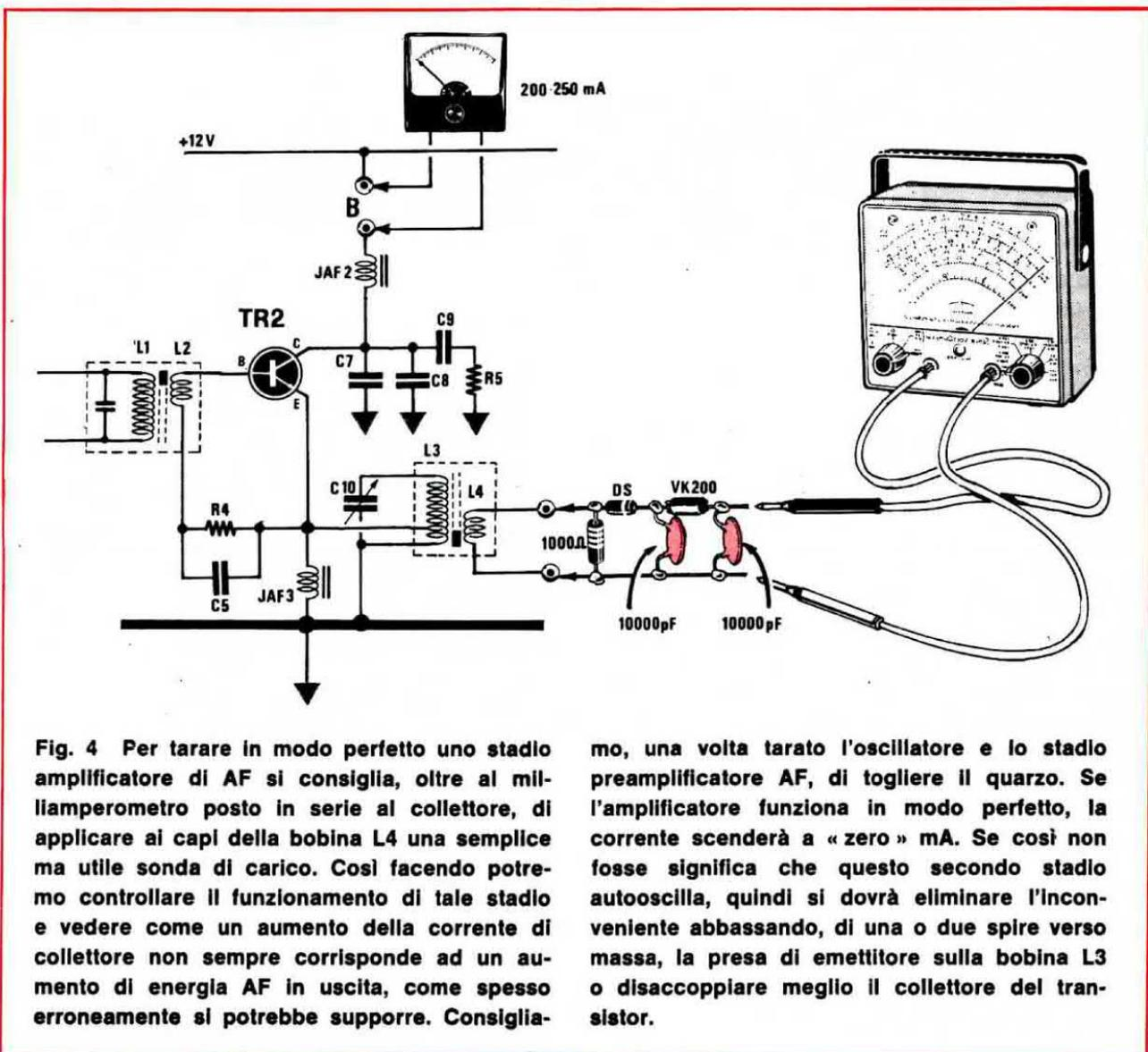
Fig. 4 Per tarare in modo perfetto uno stadio amplificatore di AF si consiglia, oltre al milliamperometro posto in serie al collettore, di applicare ai capi della bobina L4 una semplice ma utile sonda di carico. Così facendo potremo controllare il funzionamento di tale stadio e vedere come un aumento della corrente di collettore non sempre corrisponde ad un aumento di energia AF in uscita, come spesso erroneamente si potrebbe supporre. Consigliamo,
