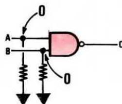
**Fig. 2** Volendo che una delle due entrate A-B di una porta si trovi in condizioni «0», dovremo collegarla a massa. Lo potremo fare tramite una resistenza di basso valore, come vedesi in disegno, nel caso si abbia in seguito necessità di modificare la sua condizione passando cioè dalla condizione «0» alla condizione «1», oppure direttamente senza alcuna resistenza se si richiede che tale terminale rimanga costantemente sulla condizione «0».
