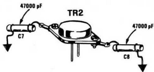
**Fig. 6** Realizzando montaggi an AF è molto importante cercare di fuggire a massa residui di AF che potrebbero impedire al transistor amplificatore di funzionare regolarmente. Tanto per fare un esempio, credere di aver eliminato totalmente i residui di AF sul corpo di un transistor, collegando un solo condensatore ad un estremo, o aumentarne la capacità è pura eresia. Occorre, come vedesi in disegno, collegare alle due estremità del corpo, due condensatori da 4.700 o anche da 1.000 pF.
