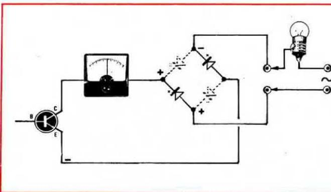
**Fig. 5** Infatti quando la corrente alternata invertirà la sua polarità, i due diodi precedenti che rimanevano inoperosi ora si portano in conduzione, collegando sempre al collettore la polarità positiva dell'onda alternata.
