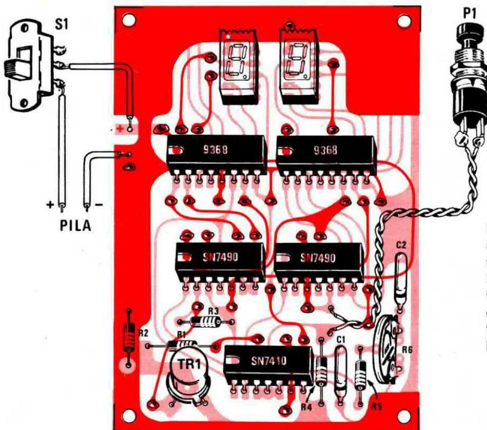
Fig. 4 Schema pratico di montaggio dei componenti sul circuito stampato. Notare, nel circuito, la tacca di riferimento degli integrati e le scanalature superiori dei display FND. 70.
