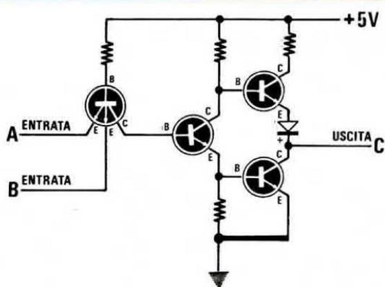
Fig. 4 Anche per una porta TTL vale quanto precisato poc'anzi, anche se circuitalmente l'interno di una tale porta si differenzia notevolmente da una porta DTL. Infatti le due uscite A-B corrispondono, per questo integrato, a due emettitori di un transistor. Essendo la base polarizzata positivamente, lasciando tali terminali liberi, avremo sempre, su di essi, tensione positiva, cioè la condizione « 1 ».
