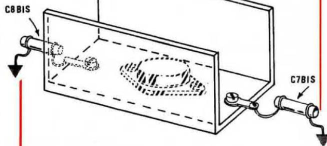
**Fig. 7** Se al transistor abbiamo applicato un'aletta di raffreddamento, risulta indispensabile, applicare alle due estremità di tale aletta altri due condensatori supplementari da 4.700 pF o da 1.000 pF. Perciò; se nel vostro montaggio sperimentale vi accadesse di constatare che un transistor autooscilla, provate ad applicare i due condensatori, come da noi consigliato, e tale inconveniente sarà eliminato all'istante.
