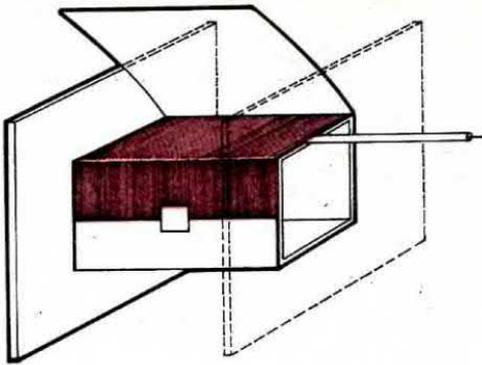
**Fig. 18** Se vorrete isolare i vari strati impiegate sempre carta sottilissima. Solo per isolare il primario dal secondario potrete impiegare carta di spessore maggiore o avvolgere più strati di carta sottile. L'ultimo strato, si consiglia di effettuarlo sopra al filo flessibile d'uscita, cioè l'opposto di come indicato in fig. 16.
