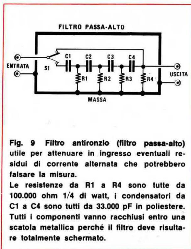
**Fig. 9 Filtro antironzio (filtro passa-alto)** utile per attenuare in ingresso eventuali residui di corrente alternata che potrebbero falsare la misura.
