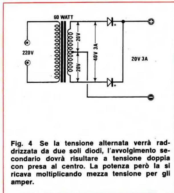
**Fig. 4** Se la tensione alternata verrà raddrizzata da due soli diodi, l'avvolgimento secondario dovrà risultare a tensione doppia con presa al centro. La potenza però la si ricava moltiplicando mezza tensione per gli amper.
