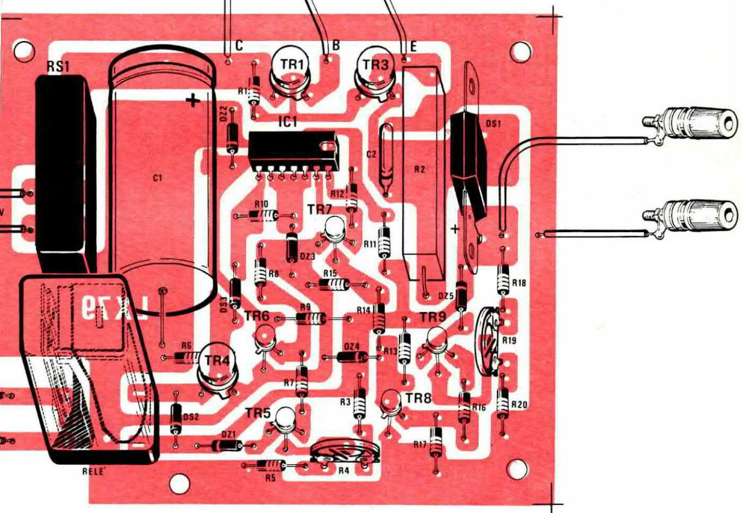
Se il circuito viene montato entro una scatola metallica, si potrà impiegare come aletta di raffreddamento per TR2 il pannello posteriore, non dimenticando di isolare il transistor con miche e rondelle isolanti.
