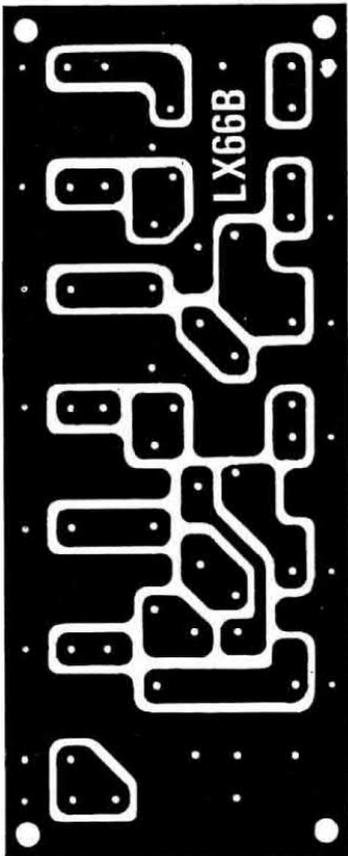
Fig. 4 Disegno a grandezza naturale del secondo circuito utile al distorsimetro.
