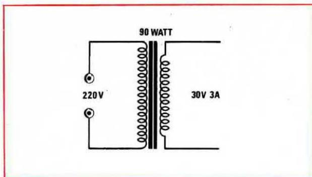
**Fig. 1** Conoscendo quanti volt e amper dovrà erogare il secondario del trasformatore che intendiamo costruire ne ricaveremo i watt, con questo dato, potremo determinare la sezione del nucleo avvalendoci della tabella n. 1 (pag. 219).
