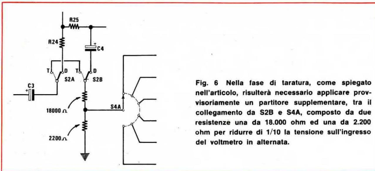
Fig. 6 Nella fase di taratura, come spiegato nell'articolo, risulterà necessario applicare provvisoriamente un partitore supplementare, tra il collegamento da S2B e S4A, composto da due resistenze una da 18.000 ohm ed una da 2.200 ohm per ridurre di 1/10 la tensione sull'ingresso del voltmetro in alternata.
