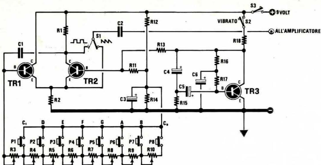
**Fig. 9** Un semplice organo giocattolo completo di vibrato. Il segnale fornito da questo oscillatore di BF lo dovremo amplificare in modo da ottenere un segnale di BF sufficientemente potente per pilotare un altoparlante.
