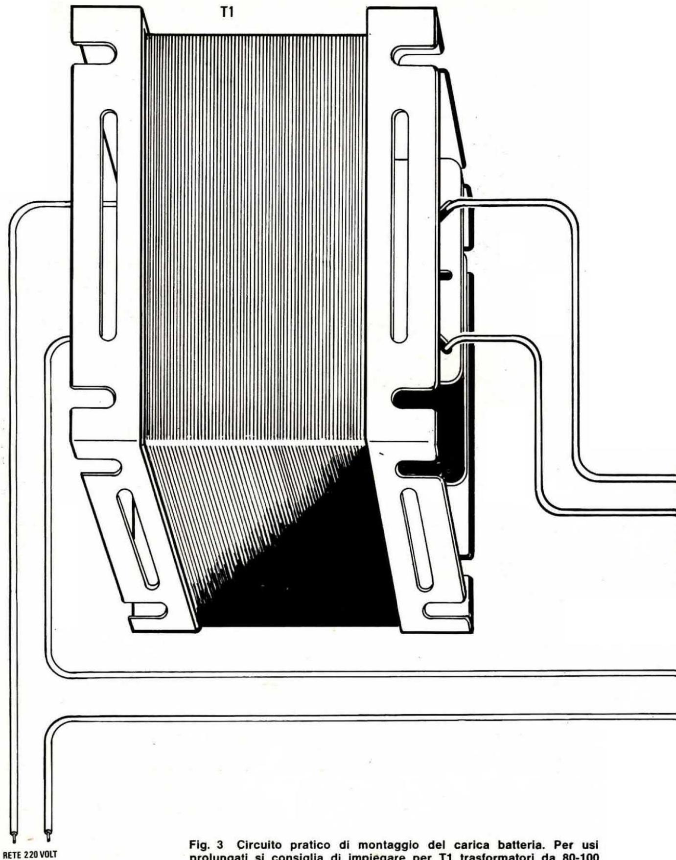
**Fig. 3** Circuito pratico di montaggio del carica batteria. Per usi prolungati si consiglia di impiegare per T1 trasformatori da 80-100 watt anche se in pratica potrebbe risultare sufficiente una potenza più limitata, cioè 45-50 watt.
