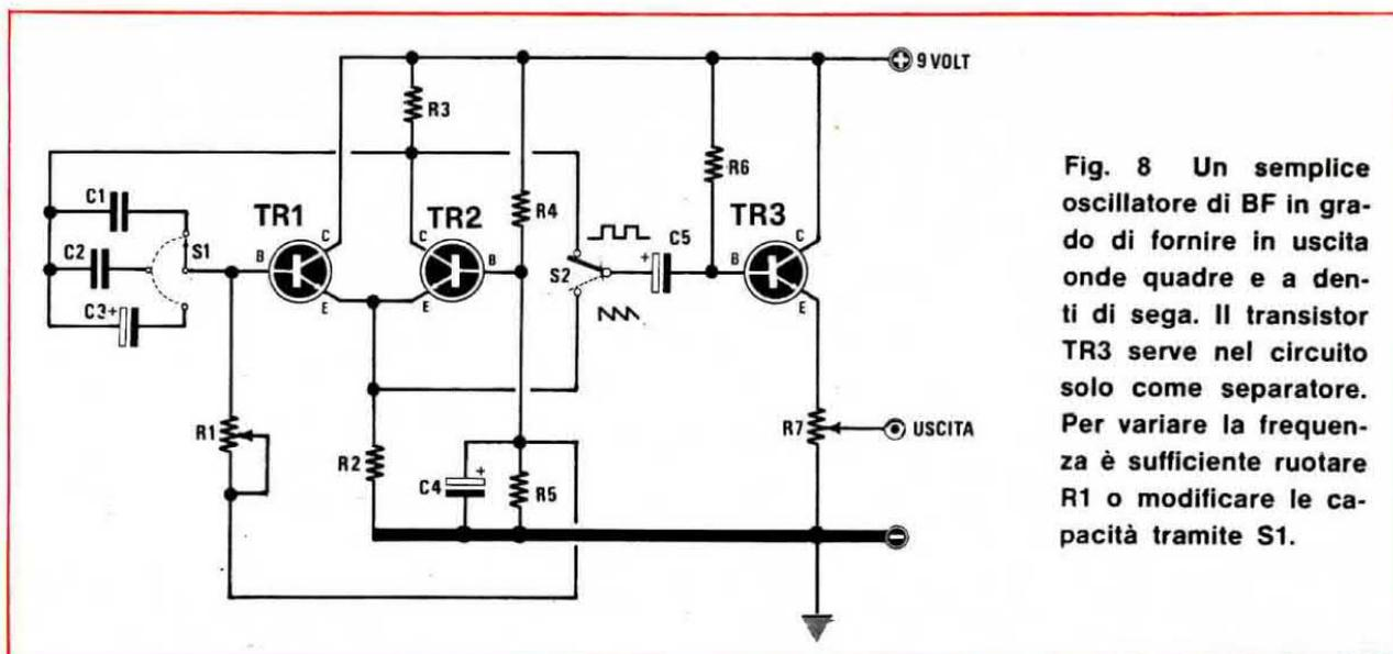
Fig. 8 Un semplice oscillatore di BF in grado di fornire in uscita onde quadre e a denti di sega. Il transistor TR3 serve nel circuito solo come separatore. Per variare la frequenza è sufficiente ruotare R1 o modificare le capacità tramite S1.
