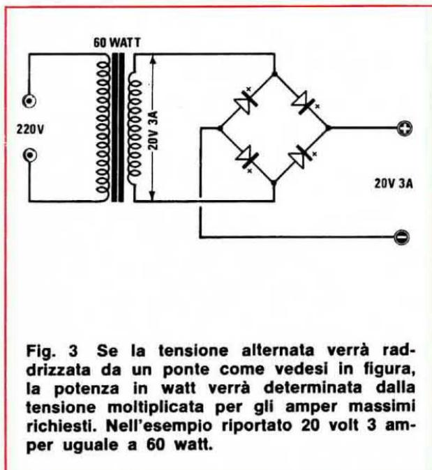
**Fig. 3** Se la tensione alternata verrà raddrizzata da un ponte come vedesi in figura, la potenza in watt verrà determinata dalla tensione moltiplicata per gli amper massimi richiesti. Nell'esempio riportato 20 volt 3 amper uguale a 60 watt.
