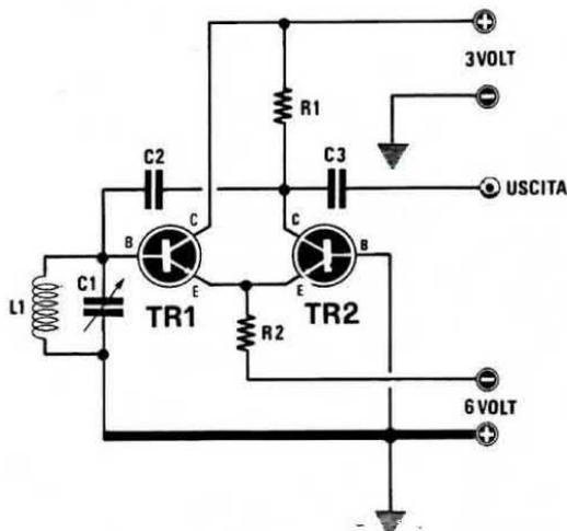
Fig. 1 Teoricamente, per alimentare un oscillatore E.C.O., si dovrebbero impiegare due pile, una da 6 ed una da 3 volt come indicato in questo schema. Tale soluzione risultando poco pratica, viene scartata per impiegare lo schema di fig. 2 che impiega una sola pila.
