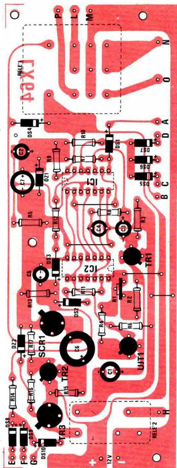
**Fig. 4** Circuito stampato a grandezza naturale visto dal lato componenti. Si notino i quattro ponticelli (posti vicino a R2-TR1-IC2-R8) che il lettore dovrà eseguire per permettere la continuità al circuito elettrico.
