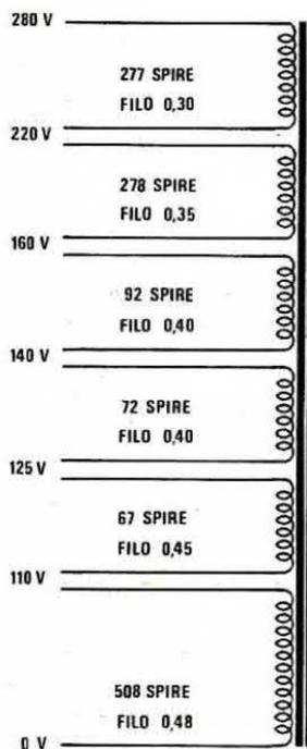
Fig. 11 Se l'avvolgimento primario viene realizzato per diverse tensioni di rete, risulta necessario variare per ogni tensione la sezione del filo, come indichiamo nell'esempio posto qui a sinistra.
