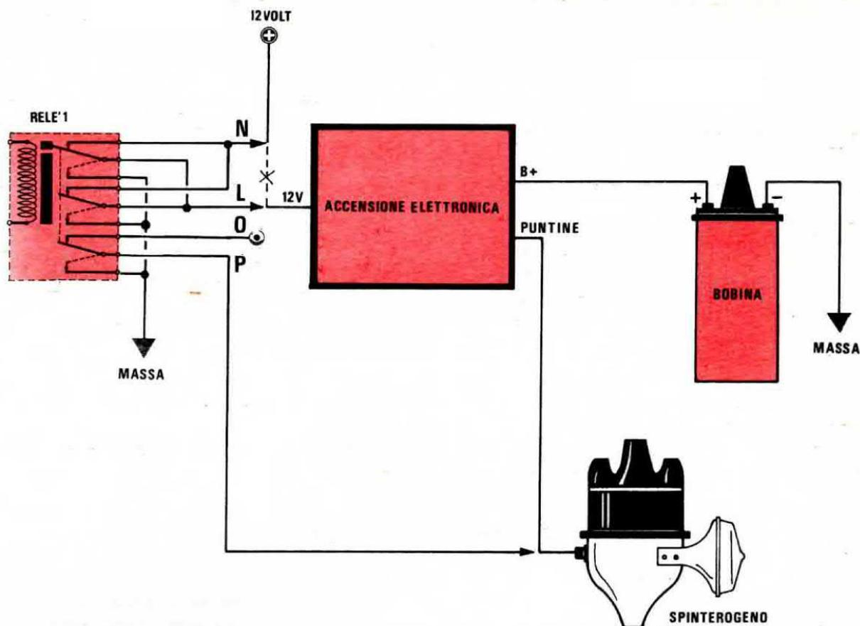
**Fig. 6** In questo disegno, un esempio di come si possono sfruttare le prese di utilizzazione del relé 1 per bloccare il funzionamento del motore. Per chi fosse sprovvisto di accensione elettronica, la presa P andrà sempre collegata alle puntine dello spinterogeno mentre le prese N-L in serie al filo positivo di alimentazione della bobina AT (nota: la presa N va sempre collegata al positivo 12 volt che proviene dal cruscotto, e la presa L al terminale B+ della bobina).
