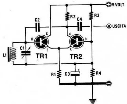
Fig. 2 Modificando lo schema come qui indicato, inserendo cioè un semplice partitore resistivo (vedi R3-R4) e un condensatore di disaccoppiamento C3, noi potremo impiegare per alimentare un oscillatore E.C.O. una sola tensione a 9 volt.
