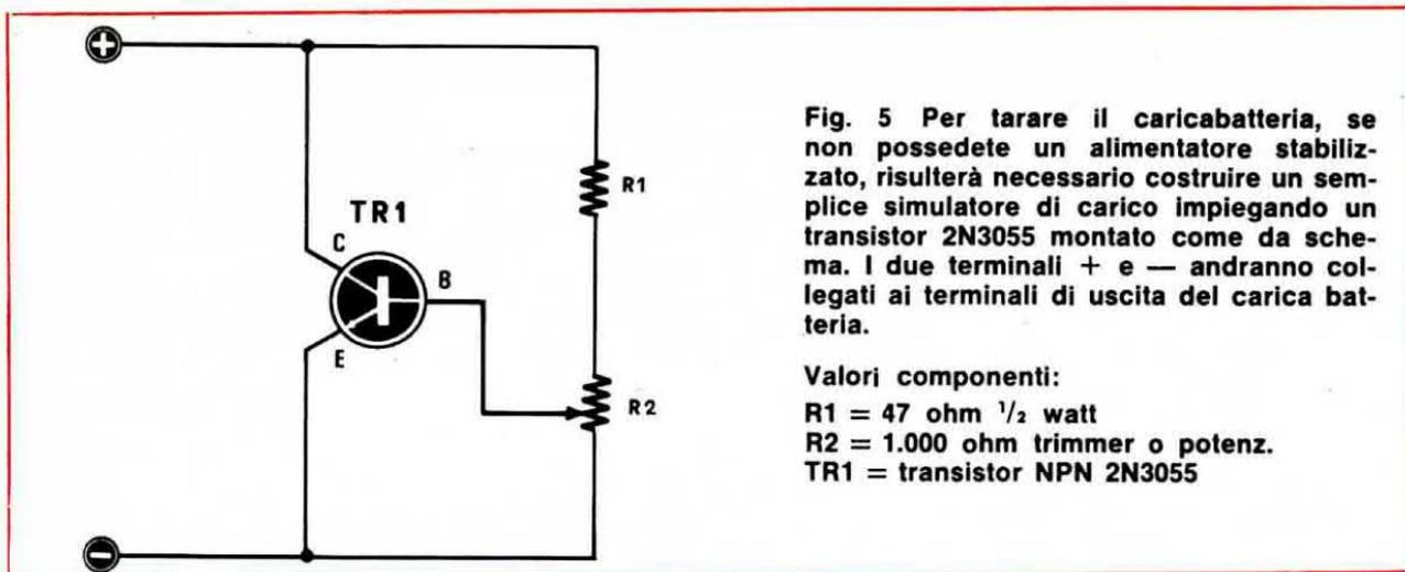
**Fig. 5** Per tarare il caricabatteria, se non possedete un alimentatore stabilizzato, risulterà necessario costruire un semplice simulatore di carico impiegando un transistor 2N3055 montato come da schema. I due terminali + e - andranno collegati ai terminali di uscita del carica batteria.
