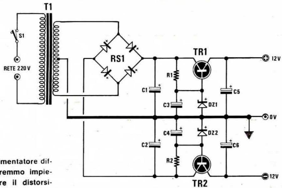
Fig. 8 Semplice alimentatore differenziato che potremmo impiegare per alimentare il distorsimetro.
