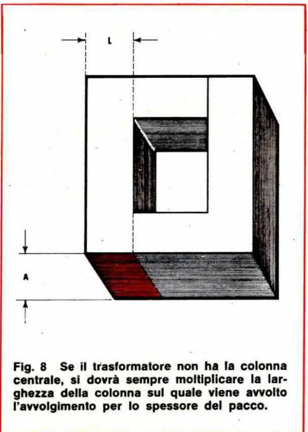
**Fig. 8** Se il trasformatore non ha la colonna centrale, si dovrà sempre moltiplicare la larghezza della colonna sul quale viene avvolto l'avvolgimento per lo spessore del pacco.
