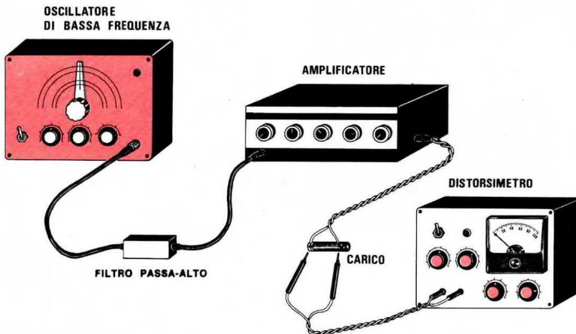
**Fig. 10** Per misurare la distorsione in un amplificatore di BF, si applicherà in entrata un segnale da 1.000 Hz, (interponendo il filtro passa-alto). Sull'uscita in sostituzione dell'altoparlante applicheremo una resistenza di carico da 4 o 8 ohm, e dai capi di questa preleveremo il segnale per il nostro distorsimetro.
