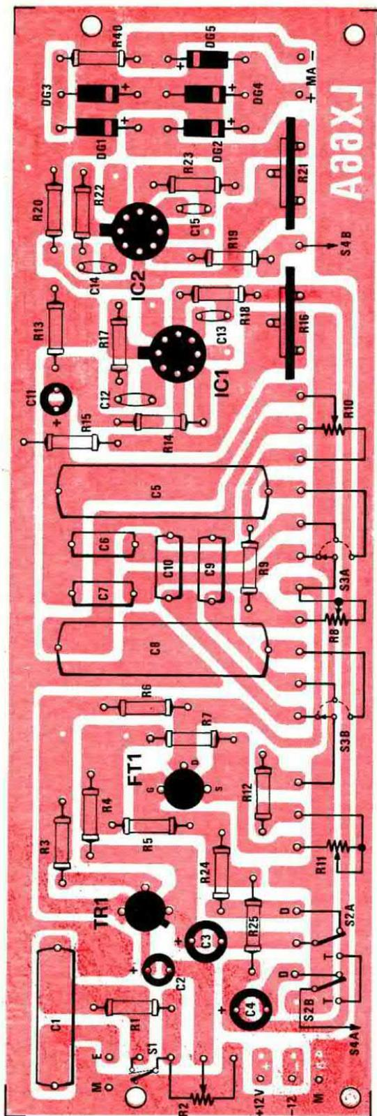
Fig. 2 Disegno del circuito stampato visto dal lato dei componenti. Sul circuito da noi fornito il lettore troverà riportata in serigrafia la posizione dei vari componenti.
