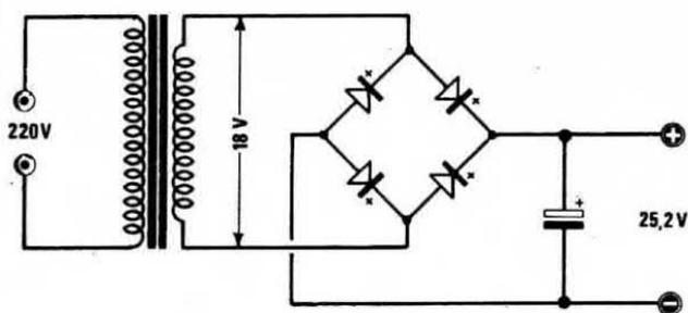
Fig. 5 Ricordatevi che la tensione alternata se raddrizzata e filtrata da un condensatore elettrolitico aumenta in uscita X 1,4 perciò con 18 volt AC, in CC otterremo ben 25,2 volt.
