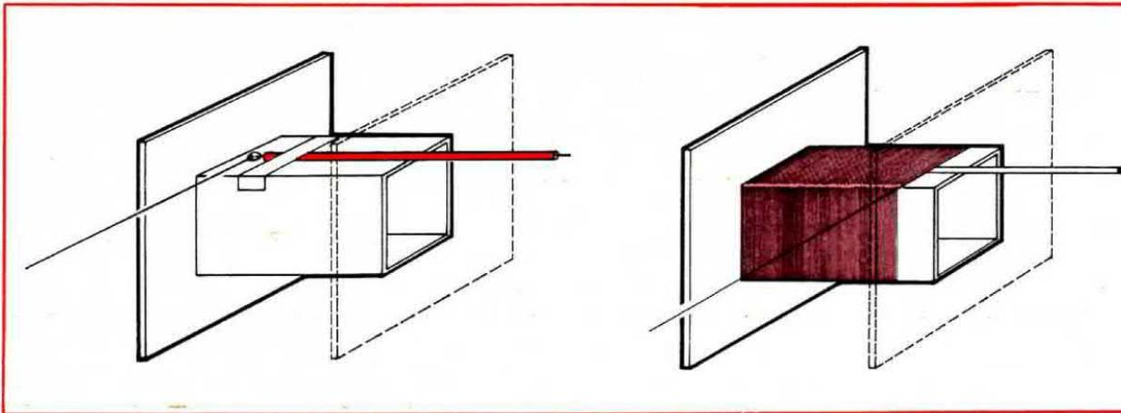
**Fig. 16** Per iniziare un'avvolgimento si consiglia di stagnare il filo di rame (specie se questo è inferiore ai 0,30 mm) su uno spezzone di filo flessibile, che si fisserà sul cartoccio con nastro scotch. Sopra a questo si avvolgerà poi il primo strato. Così facendo il filo flessibile non potrà sfilarsi dal cartoccio.
