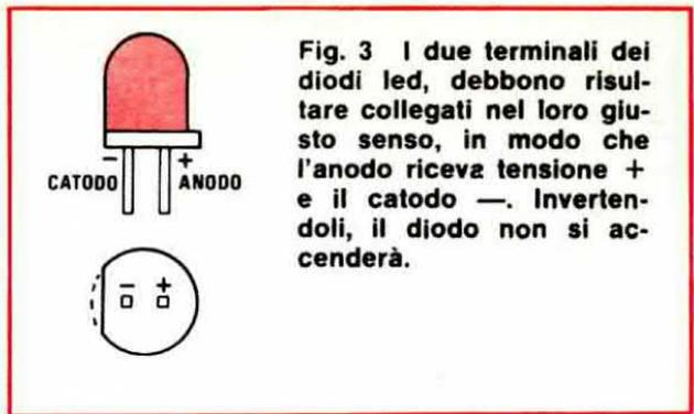
Fig. 3 I due terminali dei diodi led, debbono risultare collegati nel loro giusto senso, in modo che l'anodo riceva tensione + e il catodo -. Invertendoli, il diodo non si accenderà.
