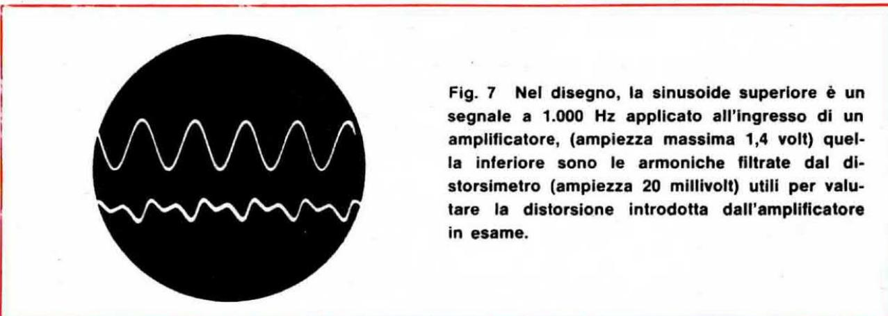
Fig. 7 Nel disegno, la sinusoide superiore è un segnale a 1.000 Hz applicato all'ingresso di un amplificatore, (ampiezza massima 1,4 volt) quella inferiore sono le armoniche filtrate dal distorsimetro (ampiezza 20 millivolt) utili per valutare la distorsione introdotta dall'amplificatore in esame.
