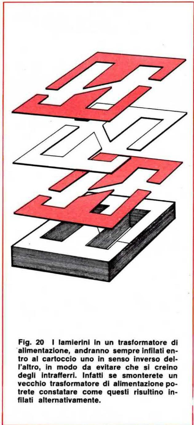
**Fig. 20** I lamierini in un trasformatore di alimentazione, andranno sempre infilati entro al cartoccio uno in senso inverso dell'altro, in modo da evitare che si creino degli intrafferri. Infatti se smonterete un vecchio trasformatore di alimentazione potrete constatare come questi risultino infilati alternativamente.
