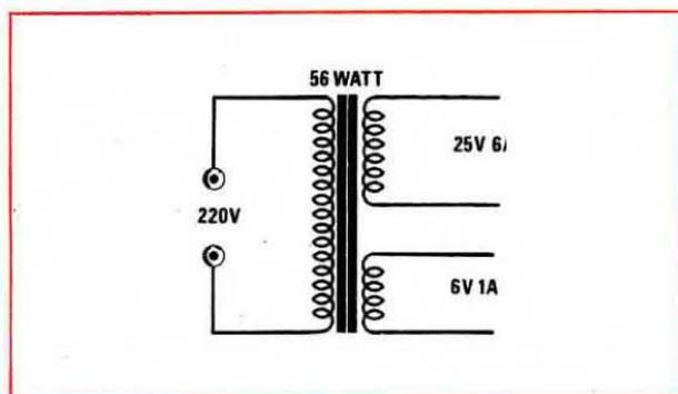
**Fig. 2** Se gli avvolgimenti secondari sono più di uno per conoscere la potenza in watt del trasformatore da costruire dovremo semplicemente addizionare i watt erogati da ogni avvolgimento.
