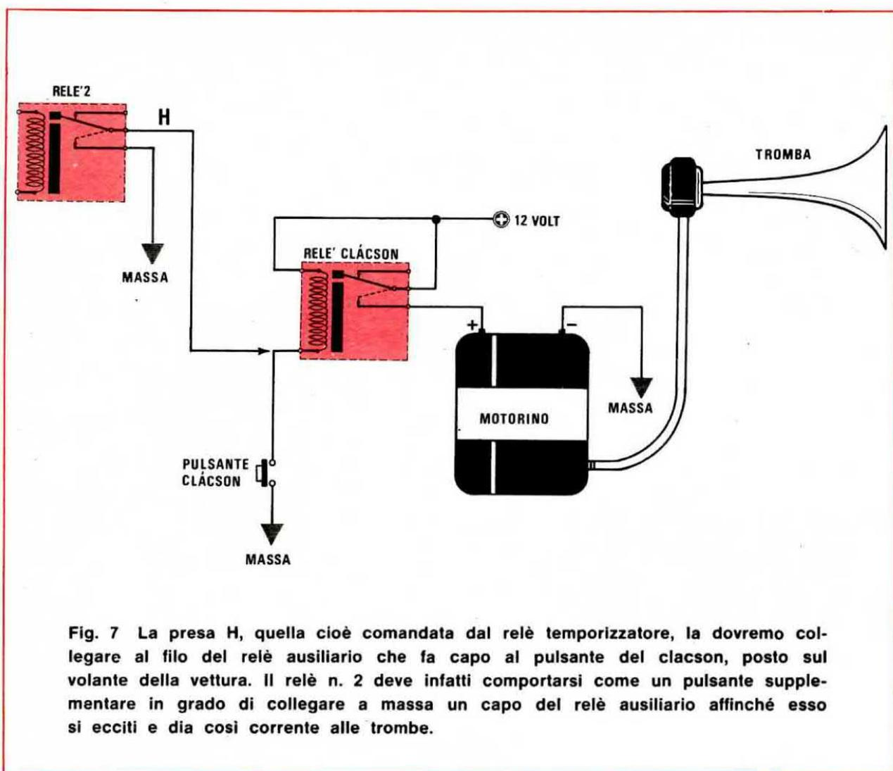
**Fig. 7** La presa H, quella cioè comandata dal relé temporizzatore, la dovremo collegare al filo del relé ausiliario che fa capo al pulsante del clacson, posto sul volante della vettura. Il relé n. 2 deve infatti comportarsi come un pulsante supplementare in grado di collegare a massa un capo del relé ausiliario affinché esso si ecciti e dia così corrente alle trombe.
