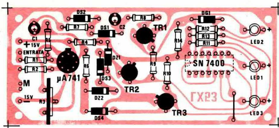
Fig. 2 Schema pratico a grandezza naturale del circuito stampato LX53 visto dal lato dove è riportato serigraficamente il disegno dei componenti. Si noti il ponticello posto vicino a LED3 e l'indicazione + utile per i terminali dei diodi led.
