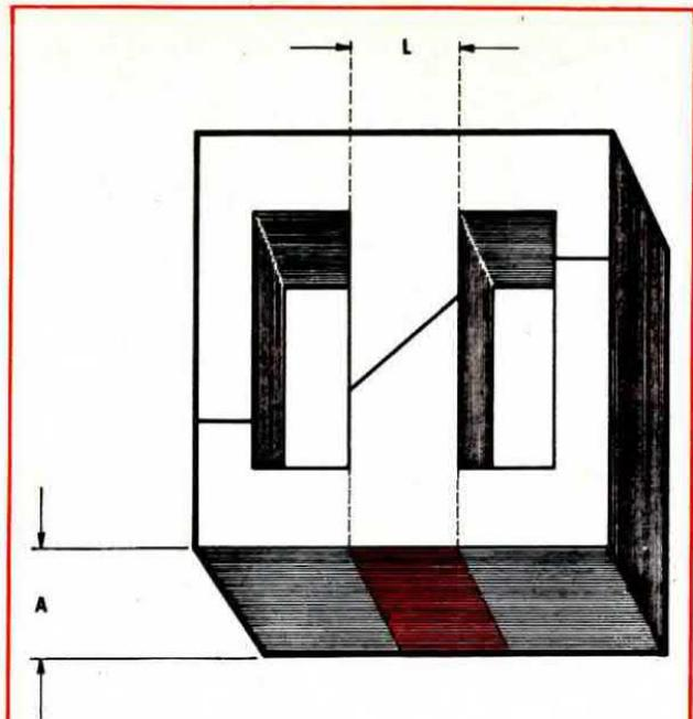
**Fig. 7** La potenza in watt del trasformatore la si determina, moltiplicando la sezione del nucleo, cioè la larghezza della colonna sulla quale viene avvolto l'avvolgimento per lo spessore del pacco (cioè  $L \times A$ ). Vedere le tabelle n. 1 e 5.
