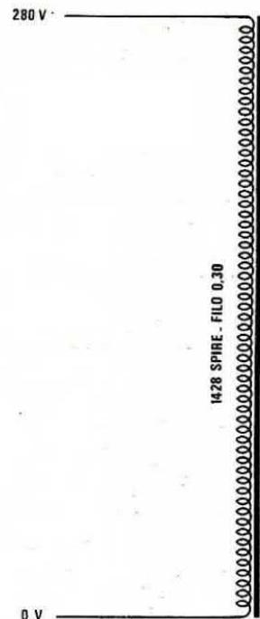
Fig. 12 Se l'avvolgimento primario serve per una sola tensione di rete, si dovrà impiegare come spieghiamo in articolo un solo filo di ugual diametro.
