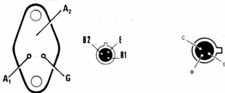
**Fig. 4** Connessioni del triac, transistor unigiunzione, e transistor BC107 visti dal lato che fuoriescono dal loro corpo, cioè di sotto.
