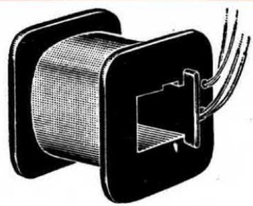
**Fig. 13** Se il vostro trasformatore non possiede un cartoccio di plastica stampata, potrete realizzarne uno con cartone rigido. Si consiglia di tenere le misure A-L leggermente superiori a quelle del nucleo affinché i lamierini entrino nell'interno del cartoccio senza sforzo.
