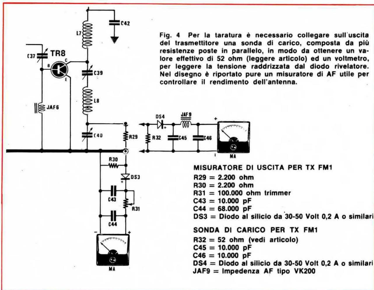
antenna venga tutta irradiata e non riflessa nuovamente di ritorno al trasmettitore. Se noteremo delle onde diffuse non dovremo ritardare i compensatori del trasmettitore, ma dovremo solo modificare la lunghezza dell'antenna in più o in meno fino a trovare quella posizione dove risulti possibile eliminare totalmente le onde riflesse. A volte è sufficiente 1 cm in più o in meno sull'antenna per giungere a tale condizione.
