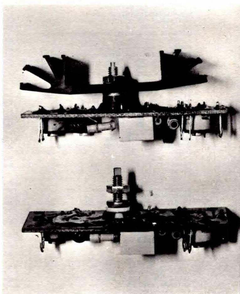
In questa foto i prototipi del lineare per i 145 MHz. In basso il transistor di potenza già saldato sul circuito stampato ma ancora sprovvisto dell'aletta di raffreddamento, in alto invece completo dell'aletta. In alto a destra, un circuito stampato visto dalla parte dei componenti.
