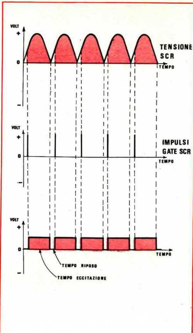
**Fig. 6** Applicando così sul « gate » dell'SCR degli impulsi positivi, questo si ecciterà e rimarrà eccitato fino a quando la semionda positiva presente sul suo anodo non scenderà a 0 volt. A questo punto l'SCR si disinnescerà e solo in presenza di un secondo impulso esso potrà rieccitarsi. Se gli impulsi al « gate » sono in fase con il periodo delle semionde positive, l'SCR rimarrà in conduzione per tutto il tempo della durata del periodo, diversamente questo tempo si ridurrà.
