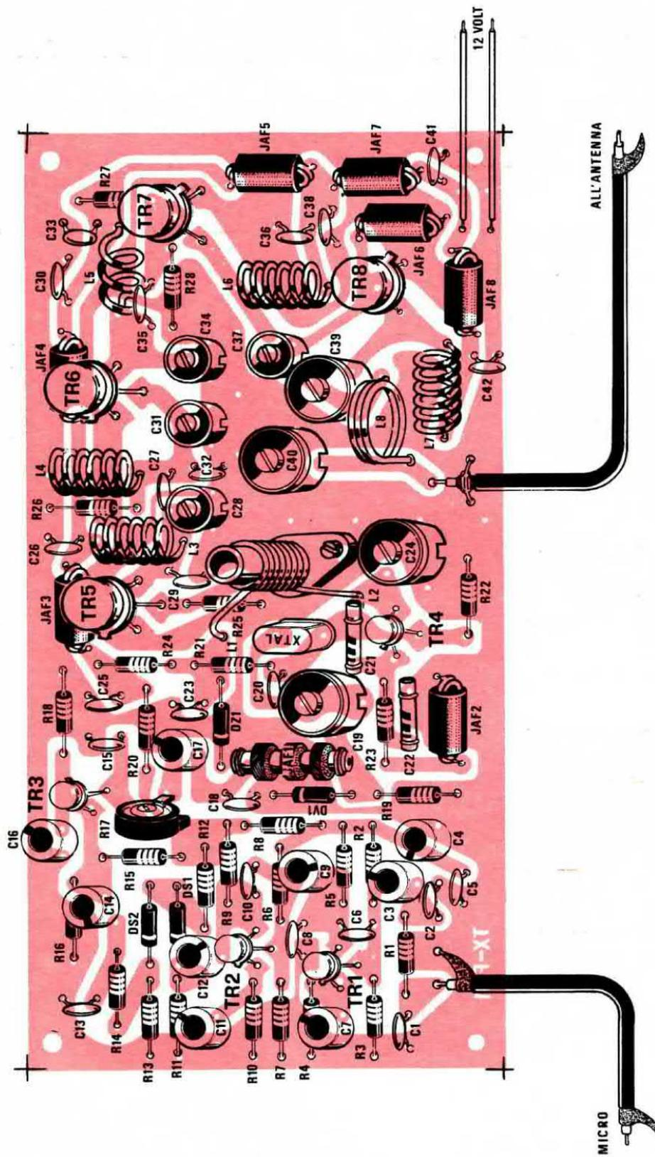
Fig. 3 Schema pratico di montaggio del trasmettore in FM.
