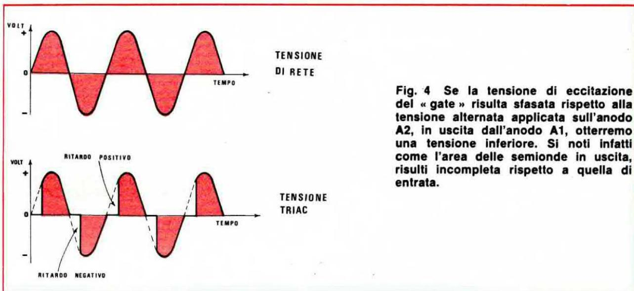
**Fig. 4** Se la tensione di eccitazione del « gate » risulta sfasata rispetto alla tensione alternata applicata sull'anodo A2, in uscita dall'anodo A1, otterremo una tensione inferiore. Si noti infatti come l'area delle semionde in uscita, risulti incompleta rispetto a quella di entrata.
