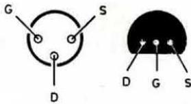
**Fig. 4** I terminali G-D-S dei fet, a seconda della forma dell'involucro cilindrico o a mezzaluna, risultano disposti in modo diverso. Prima di fissarli al circuito stampato controllate di inserire i relativi terminali come lo richiede lo schema elettrico.
