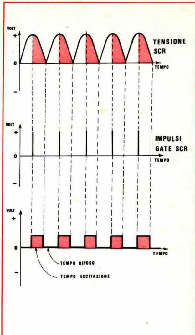
**Fig. 7** Se gli impulsi che noi forniremo al « gate » dell'SCR risultano molto in ritardo rispetto al periodo della tensione pulsante positiva a 100 Hz (presente sul suo anodo) l'SCR rimarrà eccitato per un tempo minore. Nel disegno si può notare come gli impulsi di eccitazione del gate risultando in ritardo rispetto al periodo, il tempo di riposo o di diseccitazione dell'SCR risulti maggiore rispetto al tempo di eccitazione (vedi fig. 6).
