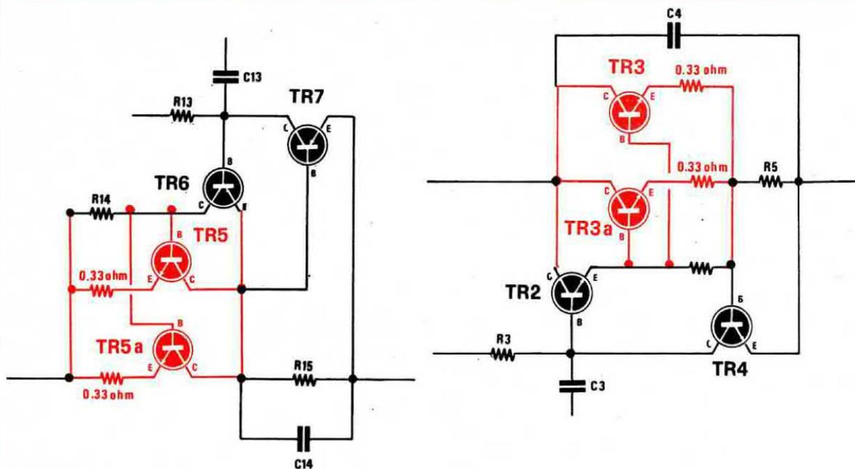
Fig. 5 Volendo realizzare un alimentatore in grado di erogare una corrente maggiore ai 2 amper da noi proposti, dovremo aggiungere in parallelo ai due transistor di potenza TR5 e TR3 un altro transistor TIP3055, come visibile in questo schema. Le resistenze da 0,33 ohm poste in serie agli emettitori risultano necessarie per compensare eventuali differenze di « Beta ».
