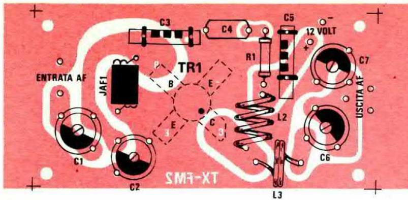
Fig. 3 Circuito stampato a grandezza naturale. Chi volesse incidersi da solo tale circuito consigliamo di rispettare le forme delle piste e di impiegare solo ed esclusivamente delle lastre di vetronite per VHF.
