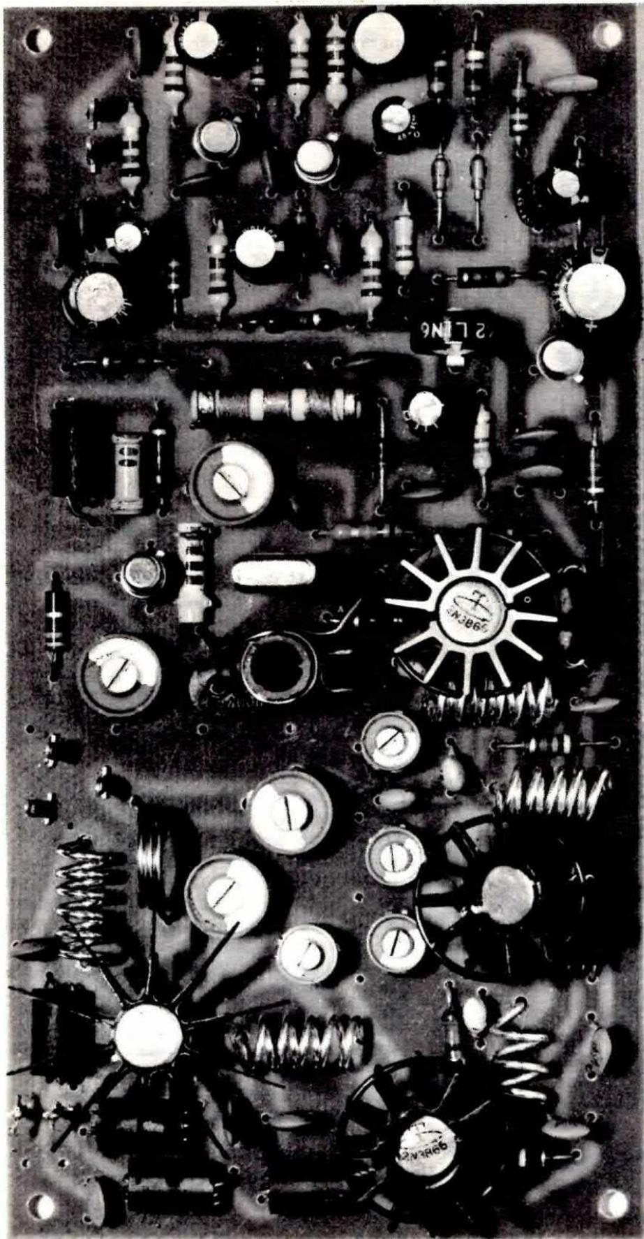
A montaggio ultimato il vostro trasmettitore dovrebbe presentarsi analogo a questa foto. Ci raccomandiamo di eseguire le saldature in modo perfetto. Una saldatura fredda può pregiudicare il funzionamento di tutto il circuito.
