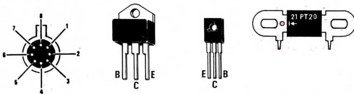
**Fig. 2** Nelle figure presentiamo le connessioni dell'integrato  $\mu$ A741 visto dal lato dove i terminali fuoriescono dal corpo. Al centro i transistor BD 138 ed il transistor di potenza TIP3055. Sulla destra è visibile il diodo di potenza 21PT20 o 21PT10 impiegato in questo progetto. Il cerchietto visibile sul terminale di sinistra serve per individuare il positivo.
