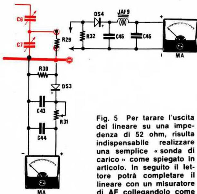
Fig. 5 Per tarare l'uscita del lineare su una impedenza di 52 ohm, risulta indispensabile realizzare una semplice «sonda di carico» come spiegato in articolo. In seguito il lettore potrà completare il lineare con un misuratore di AF collegandolo come indicato in disegno.
