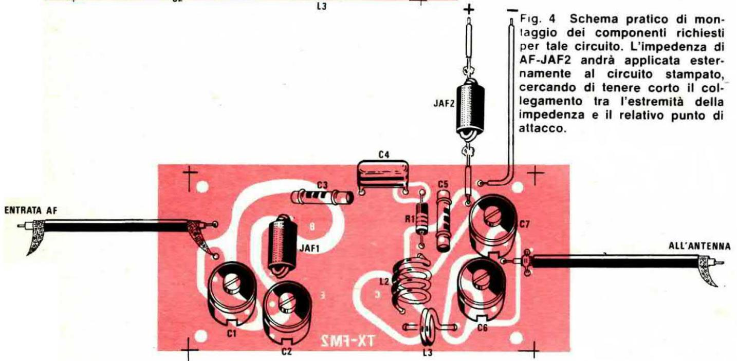
Fig. 4 Schema pratico di montaggio dei componenti richiesti per tale circuito. L'impedenza di AF-JAF2 andrà applicata esternamente al circuito stampato, cercando di tenere corto il collegamento tra l'estremità della impedenza e il relativo punto di attacco.
