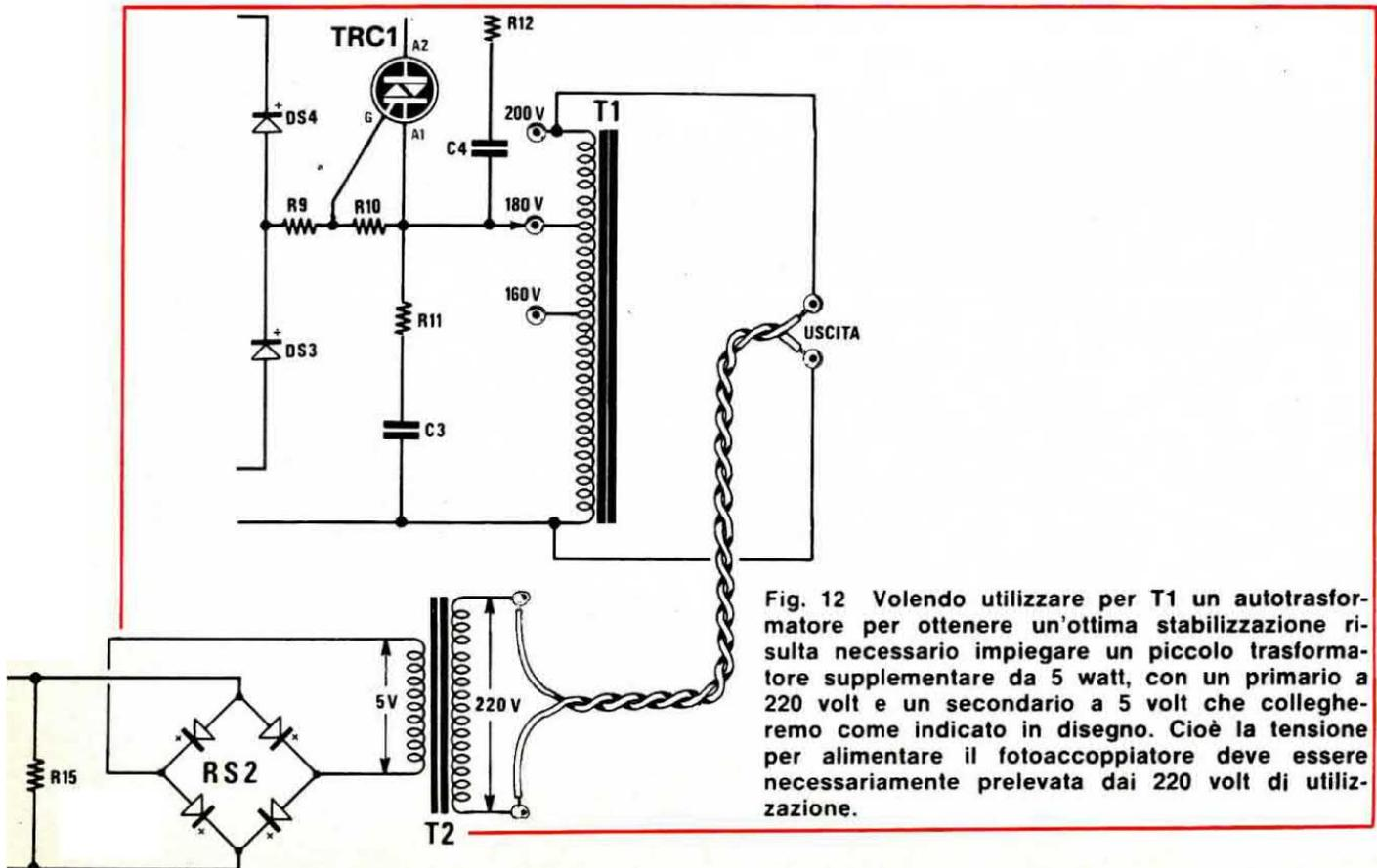
Fig. 12 Volendo utilizzare per T1 un autotrasformatore per ottenere un'ottima stabilizzazione risulta necessario impiegare un piccolo trasformatore supplementare da 5 watt, con un primario a 220 volt e un secondario a 5 volt che collegheremo come indicato in disegno. Cioè la tensione per alimentare il fotoaccoppiatore deve essere necessariamente prelevata dai 220 volt di utilizzazione.
