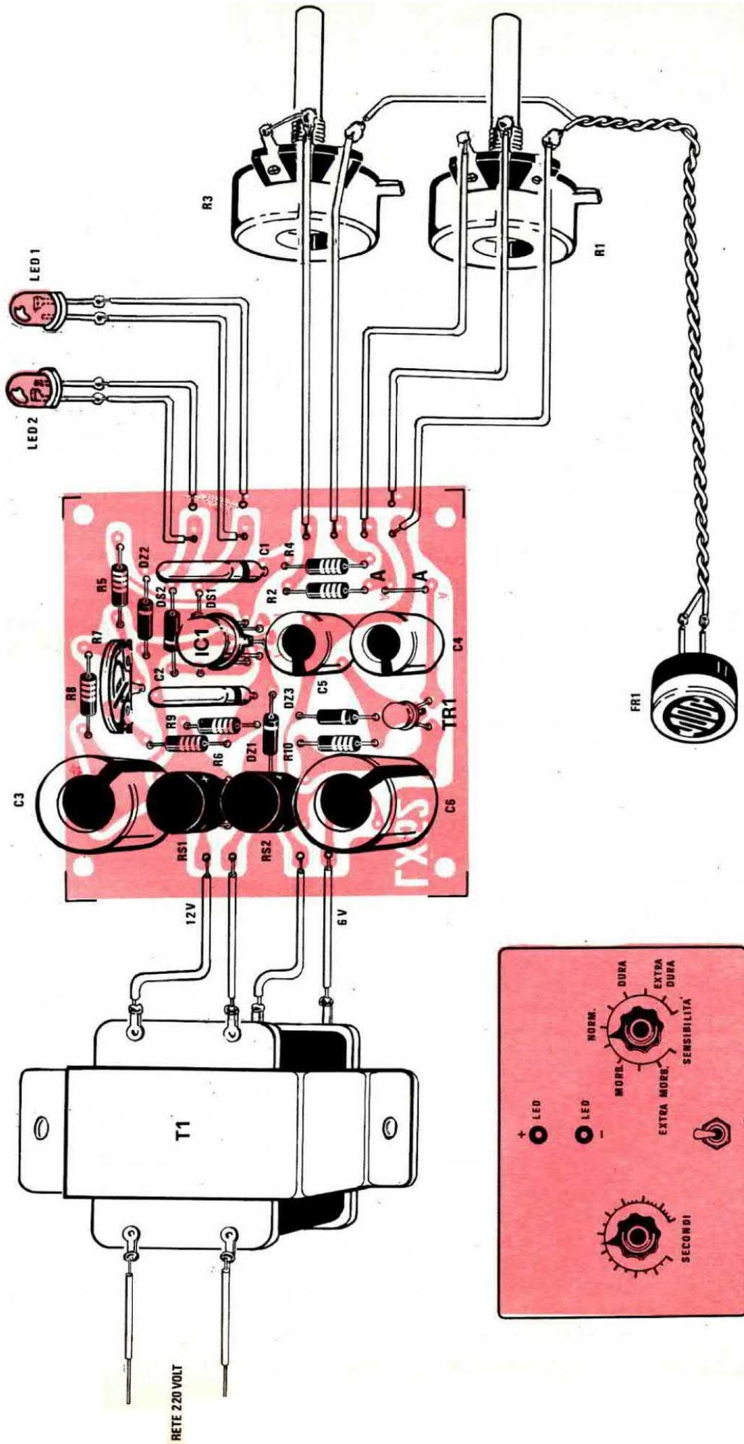
Fig. 5 Realizzazione pratica di montaggio. I due terminali A-A andranno cortocircuitati con un sottile filo di rame, dopo aver eseguito la taratura, come spieghiamo in articolo.
