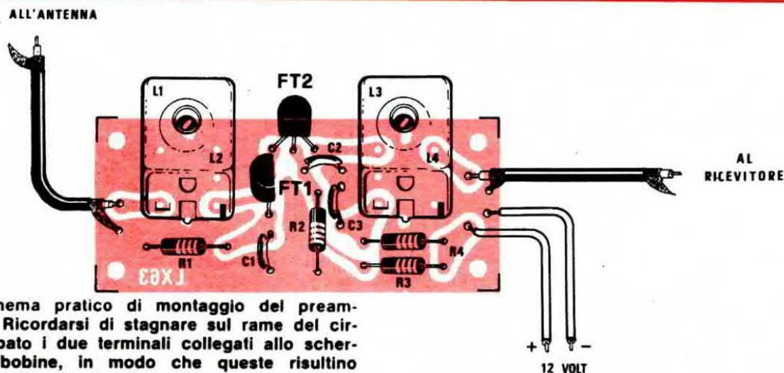
Fig. 3 Schema pratico di montaggio del preamplificatore. Ricordarsi di stagnare sul rame del circuito stampato i due terminali collegati allo schermo delle bobine, in modo che queste risultino collegate elettricamente alla massa.
