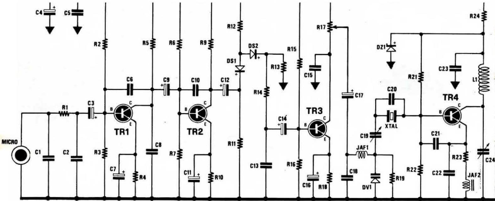
segnale a 145 MHz ottenendo così, sul suo collettore, un segnale AF di potenza adeguatamente sufficiente per pilotare il transistor finale.
