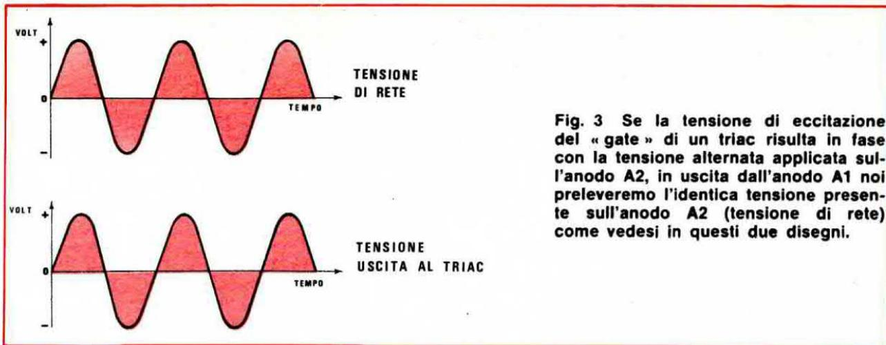
**Fig. 3** Se la tensione di eccitazione del « gate » di un triac risulta in fase con la tensione alternata applicata sull'anodo A2, in uscita dall'anodo A1 noi preleveremo l'identica tensione presente sull'anodo A2 (tensione di rete) come vedesi in questi due disegni.
