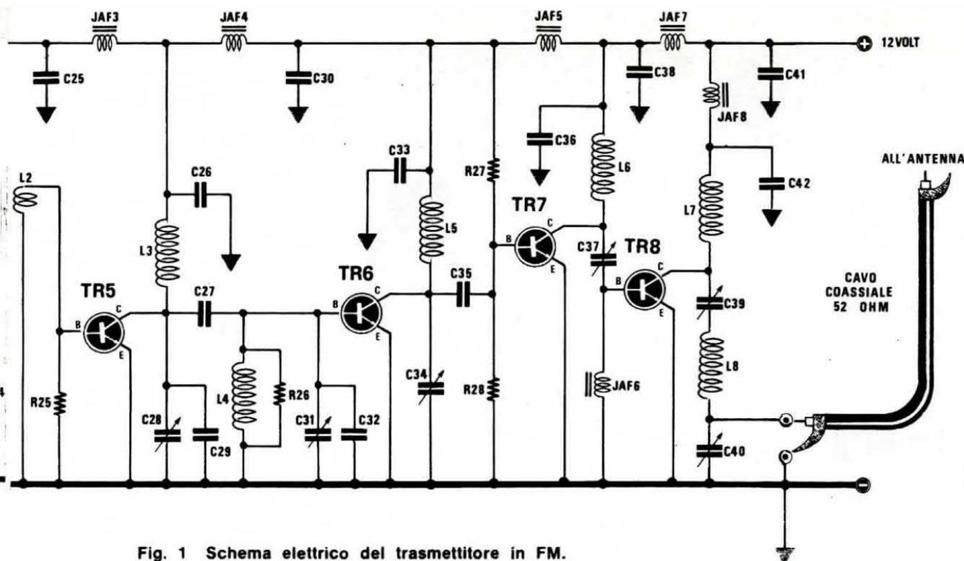
Fig. 1 Schema elettrico del trasmettitore in FM.
