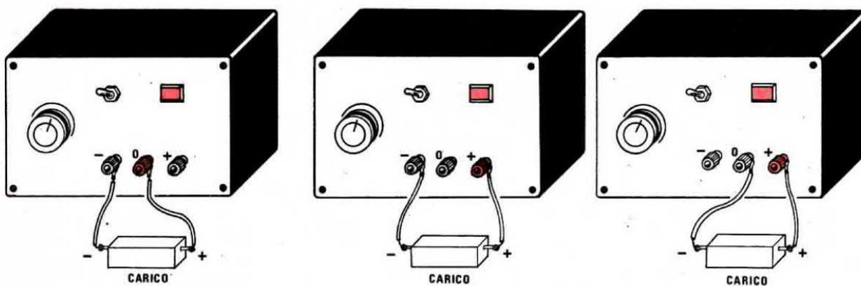
Fig. 6 Di questo alimentatore potremo impiegare anche una sola sezione, scegliendo come « massa » il positivo o il negativo in conformità alla polarità del transistor che impiegheremo (se NPN o PNP). È ancora possibile utilizzare i due estremi trascurando la presa centrale ed ottenere così un raddoppio della tensione di uscita, con un minimo di 16-18 Volt ed un massimo di 36-38 Volt.
