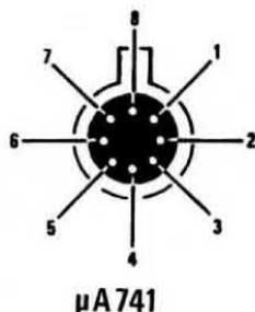
Fig. 2 Disposizione dei terminali sull'integrato uA.741 visto dal lato che fuoriescono dall'involucro. A destra: i terminali + e - di un diodo led, si noti che il terminale - è dalla parte dove l'involucro è schiacciato.
