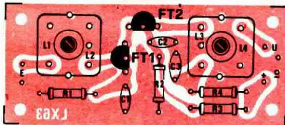
Fig. 2 Circuito stampato del preamplificatore per i 27 MHz visto dal lato componenti. **NOTA.** Il circuito è predisposto per i fet di forma semicircolari, pertanto se userete fet di forma cilindrica ricordatevi che i terminali G-D-S sono disposti diversamente (vedi fig. 4).
