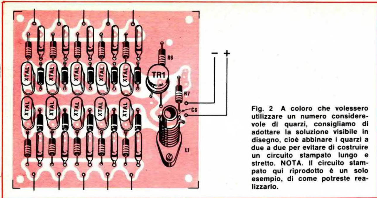
**Fig. 2** A coloro che volessero utilizzare un numero considerevole di quarzi, consigliamo di adottare la soluzione visibile in disegno, cioè abbinare i quarzi a due a due per evitare di costruire un circuito stampato lungo e stretto. **NOTA.** Il circuito stampato qui riprodotto è un solo esempio, di come potreste realizzarlo.
