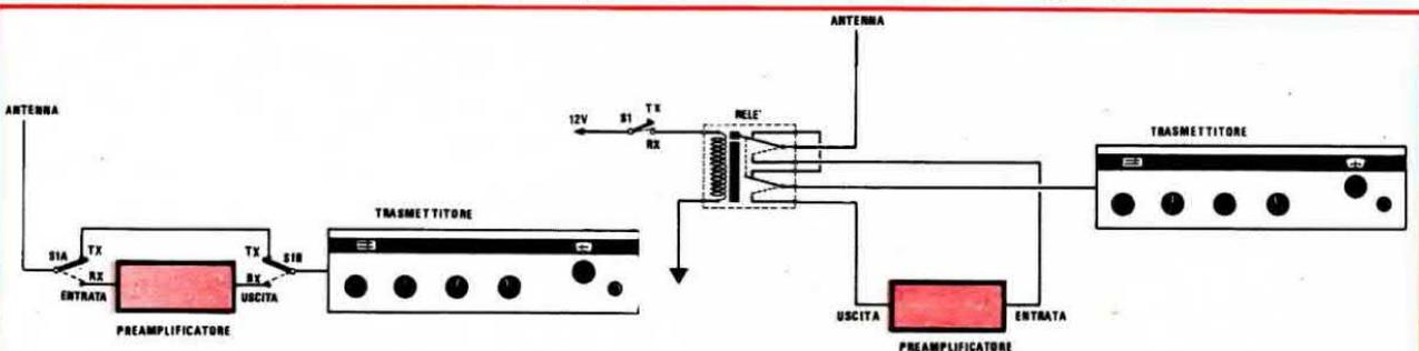
**Fig. 5** Applicando il preamplificatore su ricetrasmittitori commerciali, è necessario impiegare un deviatore che escluda il preamplificatore quando l'apparato dalla ricezione passerà in trasmissione.
