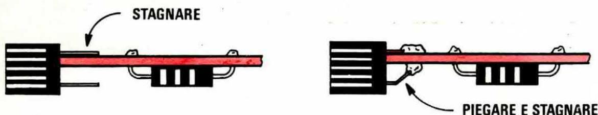
**Fig. 30** Tutti i display dovranno risultare disposti sui telaini ben allineati sia orizzontalmente che verticalmente. Per l'allineamento verticale, consigliamo di appoggiarli da un lato del circuito stampato, quindi stagnarne i terminali, dal lato opposto, si ripiegherà come vedesi sul disegno di destra gli altri terminali e dopo averne controllato l'allineamento con gli altri telai, si stagneranno.
