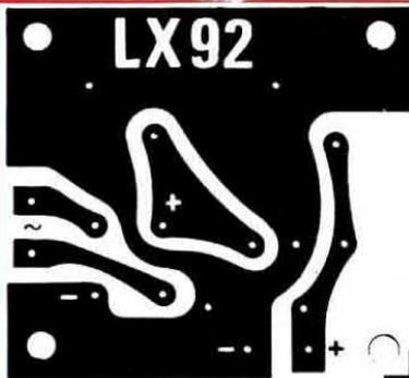
Fig. 9 A sinistra - circuito stampato a grandezza naturale dell'alimentatore. A destra - forma e dimensioni dell'integrato stabilizzatore di tensione  $\mu$ A.7812 impiegato in questo alimentatore. I tre terminali E-M-U identificano, terminale d'ENTRATA, MASSA, USCITA STABILIZZATA.
