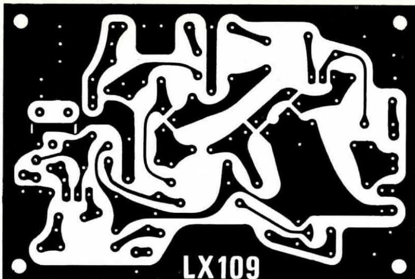
Fig. 9 Circuito stampato a grandezza naturale necessario per la realizzazione di questo « sweep a lenta scansione ».
