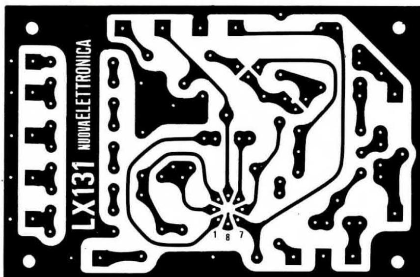
Fig. 3 Circuito stampato a grandezza naturale necessario per ricevere tutti i componenti del voltmetro. Anche questo circuito come tutti gli altri da noi forniti è provvisto di disegno serigrafico con le sigle dei componenti.
