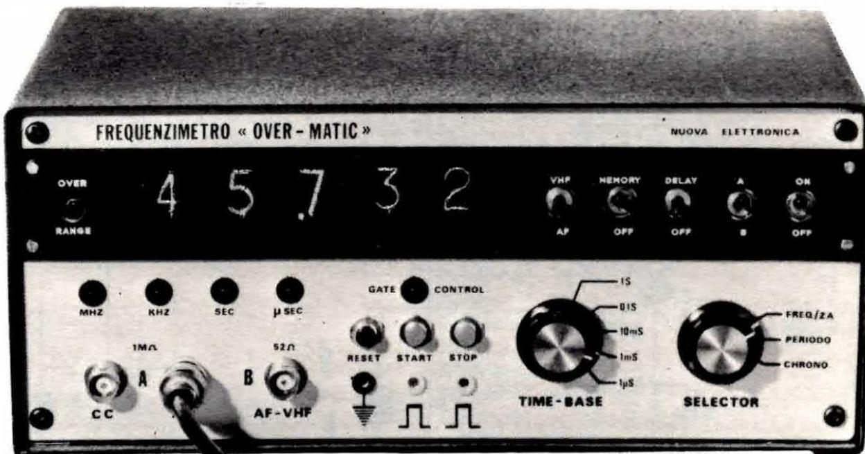
Questo nuovo telaio, a differenza del vecchio LX1002, ci permette di raggiungere e superare in molti casi anche i 40 MHz, come vedesi in questa foto. Questa caratteristica permetterà a quanti non hanno interesse ad effettuare misure oltre i 35 MHz di eliminare il telaio VHF ottenendo quindi un frequenzimetro ancor più economico.
