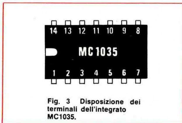
Fig. 3 Disposizione dei terminali dell'integrato MC1035.
