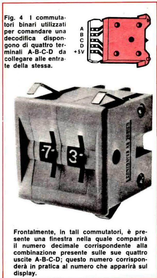
Fig. 4 I commutatori binari utilizzati per comandare una decodifica dispongono di quattro terminali A-B-C-D da collegare alle entrate della stessa.
